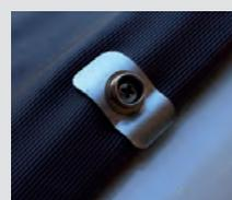
2CV, Rolldachbefestigungsblech aus Edelstahl. Auf dem Blech wird der Druckknopf verschraubt. Dieses Blech ist bis ca. 1976 verbaut worden. Danach wurde es durch einen weißen Kunststoffring ersetzt. Das Blech ist aber besser als der Kunststoffring und kann problemlos ersetzt werden. Made in Germany.
