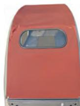
2CV alt, Rolldach lang dunkleres rot (Rouille) mit kleiner Heckscheibe. Ausgelegt für 2CV Karosserien der letzten Version. Die alten Karosserien haben eine ca. 20mm tiefere Traverse. Das muss dann angepasst werden. Außenverschuß. Es liegen 2 Haken (oberhalb der B-Säule) für die Dachbefestigung bei. Dachhaken, oberhalb + unterhalb der Heckscheibe (verschraubt an der Karosserie) bei Bedarf extra bestellen! Made in France
