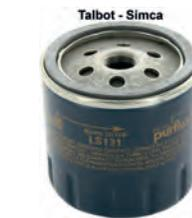
Ölfilter Simca-Talbot. Gewindeanschluss: M16x1,5. Aussendurchmesser: 71mm. Höhe: 73mm. Passend für 1307-1510 (86 - 90PS, 01.1980-06.1982). HORIZON (58 -90PS, 01.1979-06.1986). Murena (90-140PS, 09.1980-01.1985). RANCHO (80PS, 01.1977-07.1984). SIMCA 1000 (39 - 86PS, 10.1976-07.1978). SIMCA 1100 Schrägheck (50 - 82PS, 10.1968-01.1980). SOLARA (69 - 90PS, 09.1981-07.1986). TAGORA (116PS, 06.1980-12.1983).
