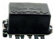
Lichtmaschinen Laderegler Gleichstrom 12V, universal. Anschlüsse: E= Masse. D= D+ an der Lichtmaschine. WL= Klemme 15 über Ladekontrollleuchte an dem Regler. F= Dyanamo Feld. B= Batterie Plus.
