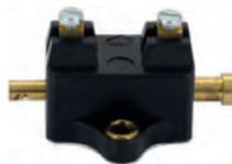
Bremslichtschalter universal. Der Schalter lässt im Ruhezustand den Strom durch (niederohmig) und sperrt den Durchgang, wenn der Stößel gedrückt oder von der anderen Seite gezogen wird. Daher ist er sehr gut universal einsetzbar. Z.B. Citroen 11CV oder Citroen HY. Der Schalter wird mit oberer Gummiabdeckung geliefert.
