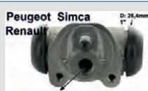
Peugeot Simca Renault. Radbremszylinder hinten. Kolbendurchmesser: 25,4mm (1 Zoll). Passend für Peugeot 202, 202, 403, 404. Simca Aronde + Renault Fregate. Bremsleitungsanschluss: 7/16x20 UNF (trichterförmiger Anschluss = F Bördel). Ankerplattenbohrung: 36mm. Länge über alles: 67mm. Or. Nr. 4402.08 + 4402.09 Made in Spain.
