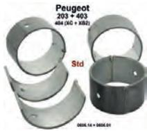
P 203/403/404 Pleuellager (kompletter Satz) für Benzin Motoren mit 3 Kurbelwellenlager. Abmessung: Standardmaß. Durchmesser Kurbelwelle: 44,975 bis 44,991 mm. Breite: 27mm. Passend für Peugeot 203 (alle Motoren). Peugeot 403 (alle Benziner). Peugeot 404 erste Serie (8CV), Motor XC + XB2 (404 U6). Or. Nr. 0606.14 + 0606.01.
