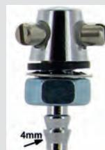
Scheibenwaschdüse verchromt. Universal passend. 4mm Schlauch Anschluß. Die Scheibenwaschdüse wird mit einer Mutter von hinten verschraubt. 2x Wasserstrahl. Die Düsen sind individuell einstellbar! Montage Durchmesser: 8,0mm.
