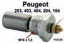
Öldruckschalter. Gewinde: M18 x 1,5. Passend für Peugeot 203 + 403. Peugeot 104, 204, 304, 404. Citroen Visa. Schaltdruck: 0,6 Bar. Or. Nr. 1131.04
