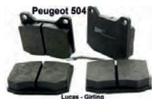
P 504, Bremsklötze vorne, System Lucas, mit Verschleißanzeige. Breite 78,4 / Höhe 64,5 / Dicke 17mm
