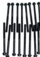
Zylinderkopfschrauben (16 Stück) für Euro V6 Motor. Passend für Peugeot 504 V6, 505 V6, 604 V6, 605 V6. Citroen XM V6. Renault Espace V6, R25 V6, R30 V6, Alpine A310 V6. Talbot Tagora V6. Gewinde: M12. Länge: 178mm. Aussensechskant. Or. Nr. 0204.53
