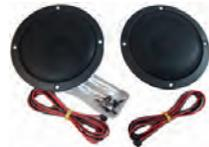
Einbaulautsprecher, sehr flache Bauhöhe (2 Stück). Durchmesser 140mm. 2 x 35 Watt. Passend in den Türverkleidung von Citroen 2CV, Renault R4, Peugeot 204 - 504. Besonders flache Bauform, daher super für 2CV + R4 Türverkleidungen geeignet! Außendurchmesser = 143 mm, Ausschnitt für Einbauöffnung in den Türverkleidungen = 111mm, Einbautiefe = 28 mm, Lautsprechermembrandurchmesser= 100 mm. Dual-Cone System, 2x 35 Watt Belastbarkeit, Frequenzgang 100-17500 Hz
