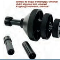
Kupplung Zentrierdorn universal (einstellbar). Einsetzbar für Schwungscheiben mit und ohne Pilotlager. Zentrierdorn passt von 14 > 28mm und der Konus für Druckplatte von 35 > 67mm (also nahezu alle klassischen Franzosen)
