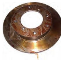
P 504, Brems Scheiben Satz hinten, Cabrio, sehr frühe Ausführung. 273mm Durchmesser, Mittenzentrierung 96,5mm. Scheibendicke 10,5mm. Or.Nr.424647
