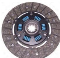
P 403/404, Mitnehmerscheibe für Peugeot 403 Diesel + 404 Diesel bis Baujahr 1967. Für Motor: XDP85. Abmessung: 200 x 30 x 10mm. Achtung: Das Kupplungsspiel neu einstellen! Peugeot Arbeitsanweisung 2/0101-0102 + 2/0201 + 2/0401 > 0405.
