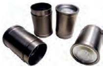
P 404, Kolben + Zylinder (4 Stück), passend für Peugeot 404. Für Motor: XC6. Hubraum: 1618ccm. Verdichtung: 8,3:1. Bohrung: 84mm. Kolbenbolzen: 23 x 70mm. Kolbenringe: 2,0 - 2,0 - 4,5mm. Abmessungen der Laufbuchse = Aussendurchmesser unten: 89mm. Höhe gesamt: 136,00mm. Aussendurchmesser oben: 99mm. Höhe von unten bis Wulst (Auflage) der Laufbuchse: 114mm.
