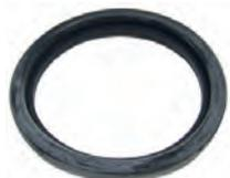
P 504 V6/R30, Einlasskrümmerdichtung, für Peugeot 504 V6, 604 V6. Renault R30, Alpine A310 V6. (Gummidichtung). Aussendurchmesser: 54,5mm. Innendurchmesser: 45mm. Or. Nr. 0348.24
