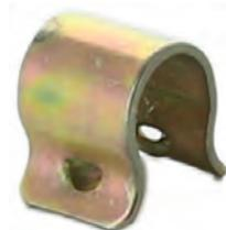
Haltespange für die Dichtung Kofferraumdeckel. Passend für Citroen 11CV/15CV. Citroen DS. Abmessung: 10 x 14mm. Auch für andere französische Fahrzeuge passend. Or. Nr. 802698, DM453-120C
