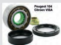
P 104/Visa, Radlagersatz Vorderachse. Passend für Peugeot 104. Citroen Visa (außer Diesel) von Baujahr 1978 bis 1989. Citroen LN + LNA. Aussendurchmesser: 72,0mm. Innendurchmesser: 35,0mm. Bauhöhe: 28,0mm. Or. Nr. 3350.11 + 3350.06. 7901335011
