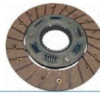
P 204/304, Mitnehmerscheibe mit Torsionsfedern. Passend für Peugeot 204 + 304. Baujahr 1968 bis 1976. Durchmesser: 200mm. Zähne: 28. Or. Nr. 2054.46
