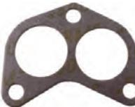
Hosenrohrdichtung doppelt (Verbindung doppeltes Krümmerrohr zu dem Abgaskrümmer). Dicke: 1,0mm. Bohrung Durchmesser: je 36,5mm. Passend für Peugeot 204, Peugeot 304 (Motor XL5 + XK5). Peugeot 404, 504, 505, J5, J7. Or. Nr. 1710.09.
