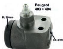
P 403/404, Radbremszylinder mit 1 Kolben 30mm, Bremsleitungsanschluss (9,5mm) 3/8 Zoll x 24 UNF, 403 Bj. 1961->, 404, 404 Comercial, 404 Pick Up. Or.Nr. 4401-24. Ankerplattenbohrung 21,5mm, Länge über alles 63,5mm. Made in Europe.
