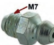
Schmiernippel M7 Gewinde. (Kegelschmiernippel
