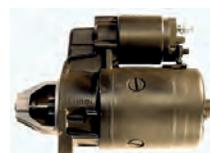
Anlasser. Passend für Peugeot 104 (0,9L - 1,4L). Peugeot 205 (1,0L - 1,4L), von Baujahr 02/1983 bis 1990. Citroen BX 14E, von 10/1982 bis 02/1993. Visa (1,0L - 1,4L), von 07/1980 bis 06/1988. Zähne: 9. 12 Volt. Drehrichtung gegen Uhrzeigersinn. 3 Loch Befestigung
