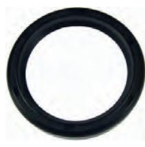
P 204/304/504/505/604, Simmerring Radlager (Aussenseite). Aussendurchmesser: 70mm. Innendurchmesser: 55mm. Höhe: 10mm. Passend für Peugeot 204, 304, 504, 505, 604. Or. Nr. 3346.06
