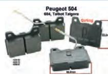
P 504/604/Talgora, Bremsklötze hinten. Bremssystem Girling. Passend für Peugeot 504 + 604. Talbot Talgora. Abmessungen: Höhe = 55,2mm. Breite = 68,3mm. Dicke: 16mm. Or. Nr. 425008, 425073, 425007.
