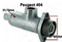
P 404, Hauptbremszylinder, 31,75mm Kolben. Passend für Peugeot 404, alle Modelle LD Thermostable, ab Baujahr 1965. Peugeot 404 alle Thermostable, ab Baujahr 02/1966. Peugeot 404 alle Modelle U6A, ab Baujahr 1966. Einbauöffnung in der Motor Stirnwand: 42mm. Stößeltiefe für die Betätigung: 50mm. Befestigung: 8,5mm Durchmesser, 60mm von mitte zu mitte. Gewinde für den Bremsflüssigkeitsbehälter: 3/4 x 16h. Made in Europe.
