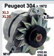
P 304, Lichtmaschine, passend für Peugeot 304, 304S. Motor XL3, XL3S. Verbaut bis Baujahr 1972. 12 Volt. 40 Ampere, für externen Lichtmaschinenregler. Befestigung: 1x 10mm Innengewinde, 1x 8mm Bohrung. 100 Euro Altteilpfand. Or. Nr. 570205 (SEV Lichtmaschine) + 570190 (Paris Rhone Lichtmaschine).
