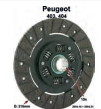
P 403/404, Mitnehmerscheibe. Passend für Peugeot 403, von Baujahr 1956 bis 1964. Peugeot 404, von Baujahr 1960 bis 1967. Durchmesser: 215mm, 30x25x10. Zähne: 10. Belagdicke: 7,9mm. Or. Nr. 2054.16 + 2054.21. Achtung: Das Kupplungsspiel neu einstellen! Peugeot Arbeitsanweisung 2/0101-0102 + 2/0201 + 2/0401 > 0405.
