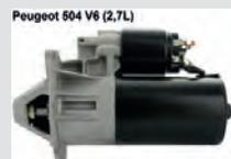
Anlasser, passend für Peugeot 504 V6 (2,7L). Peugeot 604 2,7 (SL, TI, STI). 604 2,8 GTI. Peugeot 505 2,8GTI V6. 12 Volt. Zähne: 9. Befestigungslöcher: 3. Drehrichtung im Uhrzeigersinn. Flansch Durchmesser: 82mm. Neuteil, eine Altteilstückgabe ist nicht erforderlich.
