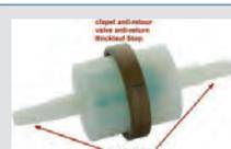
Benzinfilter universal, mit Rückschlagventil (Membrane)! Durch das Ventil wird verhindert, dass das Benzin wieder zurückläuft. Dadurch ist gerade nach längerer Standzeit ein besseres starten des Motors möglich, und die Membrane der Benzinpumpe trocknet nicht so schnell aus. Unverzichtbar bei klassischen Autos, die nur wenig bewegt werden. (Sommer-Sonntag-Auto). Für Benzinschläuche von 5,5 -7,5mm Innendurchmesser. Durchmesser 42mm. Baulänge gesamt 100mm.
