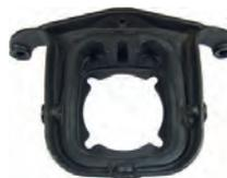
P 504, Getriebehalter hinten. Passend für Peugeot 504 Break + Pick Up, bis Baujahr 1979. Or. Nr. 1843.48
