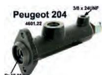
P 204, Hauptbremszylinder, passend für Peugeot 204. Kolbendurchmesser: 19,05mm. Der Hauptbremszylinder hat hinten ein Gewinde für den Bremslichtschalter (der Bremslichtschalter wird mitgeliefert). Bremsleitungsanschluss: 3/8x24UNF. Or. Nr. 460122. Made in France
