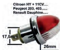
Parkleuchte, passend für Citroen 11CV, HY, Peugeot 203, 403, Renault Dauphine usw.. Per Stück! Farbe: Rot-Weiß. Einbauöffnungsdurchmesser: 17,5mm, Fassung Ba9S. Diese Leuchte kann auch universal verbaut werden. Z.B Citroen 2CV. Or. Nr. 721119
