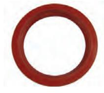
Simmerring Kurbelwelle hinten. Abmessung: 80 x 100 x 13mm. Verbesserte Ausführung aus Silicon. Passend für Renault R4 (955, 956, 1108ccm). R5, Estafette, R12, Fuego, R11, R20, R30, R25, R16, R15. Peugeot 504 V6, 604 V6, Citroen XM V6.
