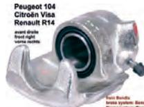
P 104/VISA/R14, Bremsattel vorne rechts (im Austausch). Bremssystem: Bendix. Passend für Peugeot 104. Citroen Visa (0,6L + 1,1L). Renault R14 1 Kolben. Kolbendurchmesser: 48mm. Or. Nr. 4401.50 + 7910028609. Zuzüglich Altteilerpfand 100 Euro.
