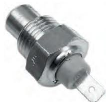
Temperaturschalter Kühlwasser. Gewinde: M18x1,5. Schaltpunkt: 100°C. Passend für Peugeot 505 Diesel, J5 Diesel. Citroen C25 Diesel. Or. Nr. 0242.41
