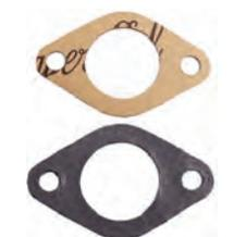
Vergaserfußdichtung oval (2 Stück). Passend für Citroen ID19, HY, 11CV. Peugeot. Innendurchmesser: 34mm. Stehbolzenmitte zu Stehbolzenmitte: ca. 61mm. Or. Nr. 481717. Diese Dichtung passt nahezu an alle Solex 34 Vergaser.
