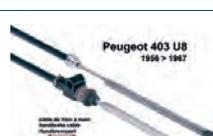
P 403, Handbremsseil. Passend für Peugeot 403 U8, von Baujahr 1956 bis 1967! Gesamtlänge: ca. 2050mm. Mantellänge: ca. 1560mm. Or. Nr. 483431
