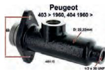
P 403/404, Hauptbremszylinder. Kolbendurchmesser: 22mm. Bremsleitungsanschluß: 1/2 x 20 UNF. Bremsflüssigkeitsbehältergewinde: ca: M19 x 1,5. Passend für Peugeot 403, ab Baujahr 10/1960. Peugeot 404, ab Baujahr 07/1960. Nicht passend für Thermostable Bremsanlage. Or. Nr. 460112. Made in Europe.
