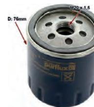
Ölfilter LS867B Peugeot + Citroen Diesel. Peugeot 504 D, 205 D. Citroen CX D, Bx D. Motoren: TU/TUD/XU/XUD. Höhe: 79mm. Außendurchmesser: 76mm. Gewinde: M20x1,5. Or. Nr. 1109.N2
