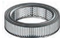
Simca 1100/1100S, Luftfilter. Aussendurchmesser: 244mm. Innendurchmesser: 186mm. Höhe: 63mm.
