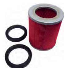
P 403/404, Luftfiltereinsatz rund, für Peugeot 403 + 404. Höhe 125mm, Aussendurchmesser 110mm, Innendurchmesser 67mm. Es liegen 2 Abdichtgummis bei, damit kann die Höhe des Luftfilter auf 135mm erhöht werden.
