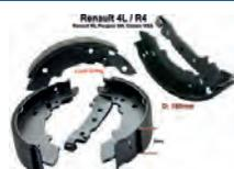
Brmsbacken hinten (1 Satz). Bremssystem: Lucas-Girling. Passend für Renault R4, R5. Peugeot 104. Citroen LNA, Visa. Bremstrommeldurchmesser: 180mm. Belagbreite: 32mm. Nachbau. Made in Europe.
