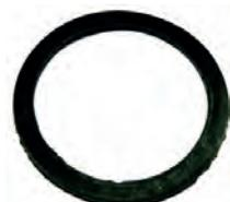
Dichtung für Benzinpumpendeckel. Für Benzinpumpen mit runden Deckel. Wir lassen mittlerweile fast alle Pumpen selber Nachfertigen. Bei den von uns angefertigten Pumpen kann der Deckel abgeschraubt werden. (runder Deckel mit 6mm Schraube in der Mitte). Maße ca. 44 x 36mm. 2mm dick.
