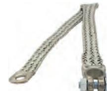
Massekabel (Batteriemasseband), mit Batteriepolklemme und Ringzunge. Länge: 450mm. Kabelquerschnitt: 22mm<sup>2</sup>. Made in der EU. Universal passend.
