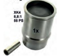
P 204, Kolben + Zylinder (per Stück). Passend für Peugeot 204, ab Baujahr 1968. Motor: XK4. Verdichtung: 8,8:1. Hubraum: 1130ccm. Bohrung: 75mm. 55PS. Der Motorblock ist einteilig!
