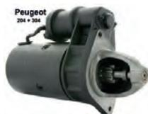
Anlasser (im Austausch). Passend für Peugeot 204 + 304. Benzin Motor, alle Modelle. 2x Befestigung. Drehweise: gegen den Uhrzeigersinn. Zähne: 9. Der Anlasser passt für Anlassermodelle: 204: Ducellier, 6155 C/D/E/G/H/J/K. Paris Rhone, D8E50, D8E97, D8E113, D8E119. Für 304: Ducellier, 6155/C/D/E, 6155G /H/J/K. Paris Rhone, 08E97A, 08E113, 08E119B. Zuzüglich Altteilstück 250 Euro. Or. Nr. 5802.05
