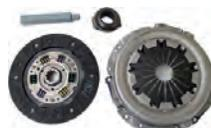
P 404/504, Kupplung komplett. Passend für Peugeot 404, ab Baujahr 10/1967. Peugeot 504 (Benziner), ab Baujahr 07/1968. Für Getriebe 4M (kleines Ausrücklager). Durchmesser: 215mm. Anzahl Zähne: 10. Nabenprofil: 10x24,5x29. Or. Nr. 2001.90 + 2004.89 + 2050.27.
