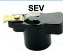
SEV, Verteilerfinger für Verteilerkappe 48134. (feststehende Kohlestifte). Passend für Citroen 11CV, HY, DS, Peugeot, Citroen. Innendurchmesser 14mm. (Aufnahme am Verteiler). Tiefe der Aufnahme 8,5mm. Verteilerfingerlänge über alles = 50mm.
