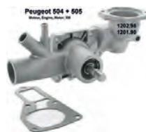
P 504/505, Wasserpumpe. Passend für Peugeot 504 (1,8L + 2,0L), Peugeot 505 (1,8L + 2,0L). Motorcode: XM. Starrer Lüfterflügel. Länge der Welle: 40mm. Verbaut ab Baujahr 8/1979. Or. Nr. 1202.98 + 1201.90
