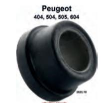
P 404/504, Gummi-Metall Lagerung für die hintere Lagerung des Strebenarmes, an der Vorderachse. Passend für Peugeot 404, 504, 505, 604. Innendurchmesser: 16mm. Außendurchmesser: 25mm. Länge innen: 17mm. Länge außen: 12mm. Or. Nr. 3523.10
