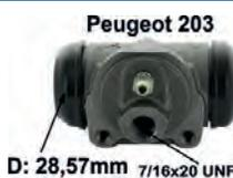
P 203/Simca, Radbremszylinder vorne. Kolbendurchmesser: 28,57mm (1 1/8 Zoll). Passend für Peugeot 203 + Simca Aronde. Bremsleitungsanschluss: 7/16x20 UNF. Ankerplattenbohrung: 36 mm. Länge über alles: 67 mm. Or. Nr. 4401.07. Made in Spain.
