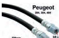
P 204/304/404, Bremsschlauch vorne, 304 Bj. 66->, Peugeot 202 hinten. 376mm, Gewinde 3/8x24-5/8-18 3/8x24 - 5/8x18
