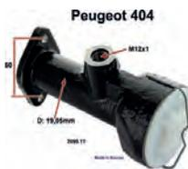
P 404, Kupplungsgeberzylinder. Passend für Peugeot 404. Kolbendurchmesser: 19,05mm. Anschluss: M12x1. Abstand der Befestigungsbohrung: 50mm. Or. Nr. 2095.11. Made in Europe.
