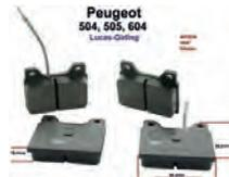
P 504, Bremsklötze Hinterachse (mit Verschleißanzeige). System LUCAS. Passend für Peugeot 504, 505, 604. Breite: 68.4mm. Höhe: 55,2mm. Dicke/Stärke: 16,4mm.
