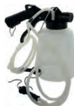
Bremsen Entlüftungs-Gerät! Arbeitsdruck 5-8 bar, max. Unterdruck 60%, Kapazität 1L. Druckluft-Anschluss 1/4 Zoll. Es ist vom Prinzip eine Druckbecherpistole, welche an dem Kompressor angeschlossen wird. An dem Behälter ist ein Schlauch welcher auf den Entlüfternippel kommt. Wenn man jetzt diese Pistole betätigt, entsteht im Behälter ein Unterdruck, welcher über den Schlauch dann an dem Entlüfternippel an steht. Somit sammelt sich die Bremsflüssigkeit im Becher des Gerätes.
