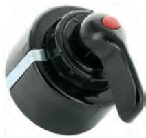
Blinkerschalter mechanisch, für den Einbau. Passend für Citroen 11CV + universal einsetzbar. Der Blinkerhebel hat ein integrierte Kontrollleuchte. Passende Glühlampe: 14425 /(12V) + 14282 (6V). Sockel = BA7s. Einsetzen der Glühlampe: Hebel erst herunterdrücken, Hebel heruntergedrückt nach links drehen, dann Hebel herausziehen und Glühlampe einsetzen!
