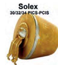
Schwimmer aus Kupfer, im Vergaser, für Solex Vergaser 30/32/34-PICS/PCIS. Durchmesser oben: 37mm, unten: 25mm, Schwimmkörperhöhe: 27mm. Verbaut zB. in 2CV4+6, Peugeot, Dauphine usw.
