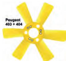
P 403/404, Lüfterflügel für Peugeot 403 + Peugeot 404. Nachbau aus Kunststoff! Aussendurchmesser: 325mm. Durchmesser für die Aufnahme an der Wasserpumpe: Ca. 104mm. Höhe: 43mm.
