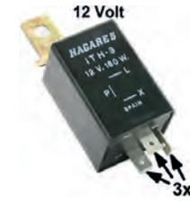
Blinkrelais, 12 Volt, 3 polig. 180 Watt Ausgangsleistung. Passend für Citroen 2CV, DS, HY. Renault R4, Peugeot 203, 403, 404 usw.. Das Blinkrelais macht keine "Klick-Klick" Geräusche. Steckerbelegung französisch: Stromversorgung Symbol (+). Anschluß Blinker vorne + hinten = Symbol ( C ). Anschluß Kontrollleuchte Armaturen Brett = Symbol ( R ). Falls ein japanisches Relais benutzt wird: Plus + = Symbol X oder B. Anschluß Blinker C = Symbol L. Anschluß Kontrolle R = Symbol P.
