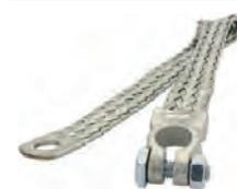
Massekabel (Batteriemasseband), mit Batteriepolklemme und Ringzunge. Länge: 300mm. Kabelquerschnitt: 22mm<sup>2</sup>. Made in der EU. Universal passend.
