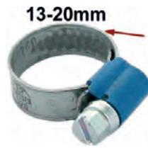
Schlauchschele 13-20mm, speziell für Kühlerschlauch. Nostalgische Optik. Geprägtes Band mit hochgestellten Kanten. Somit wird ein Verquetschen des Schlauches vermieden. Kleines Schraubgehäuse mit 7mm Sechskantschraube (mit Schlitz). Bandbreite: 9mm. Normale, moderne Schlauchsellen zerquetschen den Schlauch. Das wird mit diesen Schellen komplett vermieden. Und sie sehen auch noch besser aus.
