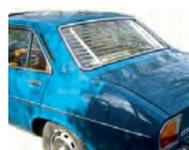
P 504, Heck - Jalousie . Passend für Peugeot 504 Limousine. Schnell eingebaut (Die Halterungen werden nur in das obere und untere Heckfenstergummi gesteckt). Ein typisches Zubehör aus den sechziger Jahren. Made In France
