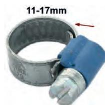
Schlauchschele 11-17mm, speziell für Kühlerschlauch. Nostalgische Optik. Geprägtes Band mit hochgestellten Kanten. Somit wird ein Verquetschen des Schlauches vermieden. Kleines Schraubgehäuse mit 7mm Sechskantschraube (mit Schlitz). Bandbreite: 9mm. Normale, moderne Schlauchsellen zerquetschen den Schlauch. Das wird mit diesen Schellen komplett vermieden. Und sie sehen auch noch besser aus.
