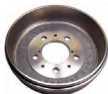
P 404/504, Bremstrommel für Peugeot 404, 504. 280mm Durchmesser. Höhe total 75mm, Innenhöhe 67mm, Innenloch (Aufnahme) 93mm. 5 Loch Felge.
