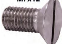
M7x12. Senkkopfschraube 7mm, mit flachem Schraubenkopf! Material: Edelstahl. Der Schraubenkopf hat ca. 12mm Durchmesser! Z.B. passend für die Türschlosskeile (Citroen 11CV).
