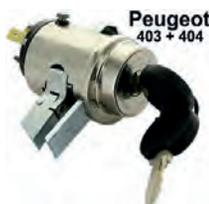
P 403/404, Zündschloss (im Armaturenbrett), passend für Peugeot 403 + 404 (erste Version). 3-Polig, davon werden zwei doppelt belegt. Gehäusedurchmesser: 39mm. Sperrbolzen: 8x13 mm. Gehäusehöhe über alles: 64 mm (ohne Kabelanschlüsse)
