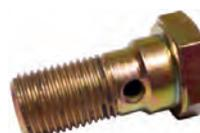
Hohlschraube für Hauptbremszylinder Citroen 11CV, HY, Peugeot 203. Die Schraube kommt stirnseitig in den Hauptbremszylinder und nimmt den Verteiler für die Bremsleitungen auf. Gewinde 1/2 x 20 UNF. Für 15mm Anschlussdurchmesser. Länge ohne Schraubenkopf = 29mm.
