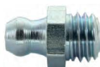
Schmiernippel M8 x 1,25. (Kegelschmiernippel H1, gerade). Schlüsselweite: 9,0mm.
