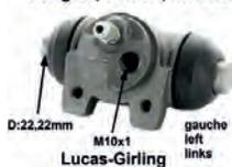
P 504, Radbremszylinder hinten links Peu.504 System Girling 22,225mm, Berline 04/73> GL-GR-DR-Diesel 07/77> Citroen LN 10/76 bis 09/77 R5 ab 1985, Fuego,R9, Kolbendurchmesser = 22,225 mm, Ankerplattenbohrung = 32 mm, Leitungsanschluss = 10x1 mm, Länge über alles = 59 mm. Made in Europe.
