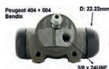
P 404/504, Radbremszylinder hinten links, passend für Peugeot 404, ab Baujahr 5/1968. Peugeot 504 (1,9 + 2,1 Diesel), von Baujahr 1970 bis 1975. Bremssystem Bendix. Kolbendurchmesser: 22,22mm. Bremsleitungsanschluß: 3/8 x 24UNF. Länge gesamt: ca. 72mm. Or. Nr. 4402.24. Made in Europe.
