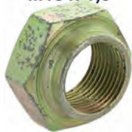
Achsmutter vorne, Peugeot 504, 505, 604. Gewinde M18x1, Schlüsselweite 30mm. Or.Nr. 693550
