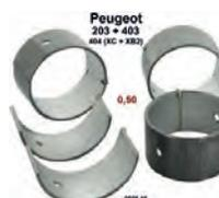
P 203/403/404 Pleuellager (kompletter Satz) für Benzin Motoren mit 3 Kurbelwellenlager. Abmessung: 0,50 Übermaß. Durchmesser Kurbelwelle: 44,475 bis 44,491mm. Breite: 27mm. Passend für Peugeot 203 (alle Motoren). Peugeot 403 (alle Benziner). Peugeot 404 erste Serie (8CV), Motor XC + XB2 (404 U6). Or. Nr. 0606.16
