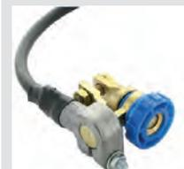
Batteriepol - Trennschalter abgewinkelt (platzsparend). Einfach die Rändelschraube lösen und der gesamte Stromkreis im Auto ist unterbrochen. Optimal für eine längere Nichtbenutzung des PKW. (Winterruhe). Einfacher geht es nicht! Die Minusklemme an der Batterie wird durch diesen trennbaren Pol ersetzt!(die Minusklemme die an der Batterie gesessen hat, wird nun einfach auf den Polanschluß des Trennschalters gesteckt). Umbauzeit ca. 1 Minute!
