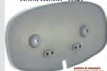
P 404, Dichtung unter der Standleuchte - Blinker. Passend für Peugeot 404 Limousine + Cabriolet, bis Baujahr 1964 (Salon 1965). Or. Nr. 6304.06
