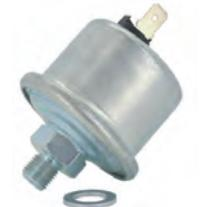
Öldrucksensor. Messbereich 0 bis 8 Bar. Gewinde M10 x 1. Passend für Citroen CX GTI Turbo. Peugeot 205 GTI. Simca 1000 Rally.
