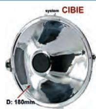
Scheinwerfer Reflektor (ohne Glas). Scheinwerfer System "Cibie 180mm". Qualitäts Nachfertigung. Damit kann der originale Scheinwerfer repariert werden. Einfach sauber das Glas lösen (dazu kann der alte Reflektor beschädigt werden) und auf den neuen Reflektor verkleben. Passend für Renault: Floride, Caravelle, Fregate, R8 Gordine. Peugeot 203, 403, 505. Citroen DS bis Baujahr 1967.
