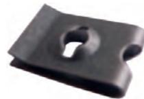
Aufschiebemutter 4,2 (Blechmutter). Für Blechtreiberschraube mit 4,2mm Kerndurchmesser. Abmessung: 16,50 x 11,20mm.
