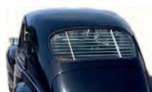
P 203, Heck - Jalousie . Passend für Peugeot 203 Limousine, mit großer Heckscheibe (1953 > 1956). Schnell eingebaut (Die Halterungen werden nur in das obere und untere Heckfenstergummi gesteckt). Ein typisches Zubehör aus den fünfziger Jahren. Made In France
