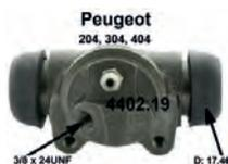
P 204/304/404/Simca, Radbremszylinder hinten links. Passend für Peugeot 204, 304, 404. Simca 1300, 1301. Kolbendurchmesser: 17,46mmmm (11/16 Zoll). Ankerlochdurchmesser 36mm, Länge über alles 70mm, Befestigungs Lochabstand 36mm, Leitungsanschluss 3/8 x 24UNF. Or. Nr. 4402.19 Made in France
