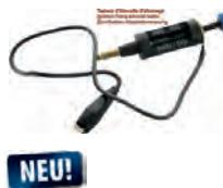
Zündfunken Abstandmessung (Prüfung) Werkzeug. Mit Hilfe dieses kleinen günstigen Werkzeuges, kann sehr leicht und gefahrlos, die Funkenstrecke der Zündkerze geprüft werden. Also, wenn der Motor nicht anspringt: Funkt überhaupt die Zündkerze! Und wenn, wie stark! Danach Ausschlußverfahren: Zündung OK? Dann bekommt er kein Benzin!
