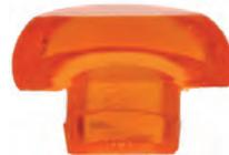
Leuchtendeckel halb (Pilzform), Farbe orange. Diese pilzförmigen Leuchten waren an vielen klassischen Peugeot montiert. In komplett orange (wird dann 2x benötigt) (Standlicht auf Kotflügel, Innenleuchte, Türinstiegsleuchte), oder in Kombination mit einem roten oder klaren halben Pilz. (Artikelnummer 75299 + 75301). Bitte die gewünschte Kombination mit Sekundenkleber verkleben.
