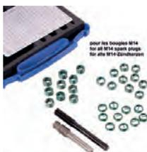
Helicoil Zündkerzengewinde Reparaturset. Für alle M14 Zündkerzen. Inhalt: 1 Bohr + Schneidwerkzeug, Einbauspindel. 10x Helicoileinsatz M14x1,25x17,5. (Kerzen mit langen Gewinde). 10x Helicoileinsatz M14x1,25x12,7. (Kerzen mit kurzen Gewinde, 2CV, R4).
