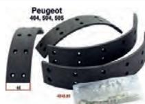
P 404/504/505, Bremsbackenbeläge zum aufnieten. Breite: 45mm. Beläge: 2x 267x44x5mm + 2x 219x44x5mm. Passend für Peugeot 404, 504 + 505. Or. Nr. 4245.93
