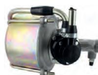
Hydrovac Bremskraftverstärker universal. Große Ausführung 7 Zoll. Einkreis Bremsanlage. Für die Nachrüstung eines Oldtimer mit einem Bremskraftverstärker bzw. als Ersatz für nicht mehr lieferbare Bremskraftverstärker. (Peugeot 404). Ein Unterdruck kann mit unseren elektrischen Pumpen erreicht werden! 2 Gewinde für hydraulischen Anschluss (1/2 x 20 UNF). Das passenden Reduzierstück von 1/2 auf 3/8 UNF hat unsere Nummer 74561 + 74565. Made in Spain.
