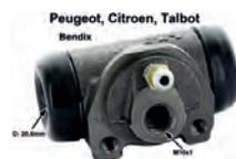
Peugeot, Citroen, Talbot. Radbremszylinder hinten Peugeot 104, Visa, LNA, Samba System Bendix, Kolbendurchmesser = 20,6 mm, Ankerplattenbohrung = 32 mm, Leitungsanschluss = 10x1 mm, Länge über alles = 55 mm
