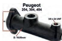
P 204/304/404, Hauptbremszylinder, Einkreis Bremsanlage. 19mm Kolbendurchmesser. Passend für alle Modelle bis Baujahr 1977, die vorne Scheibenbremse + hinten Trommelbremse haben. Ohne Anschluss für Bremslichtschalter. Bremsleitungsanschluss 3/8"24UNF. Die Anschlüsse sind senkrecht zum Flanschanschluss. Der Flansch hat 7,5mm Bohrungsdurchmesser. 50mm Bohrungsabstand im Flansch. Made in Europe.
