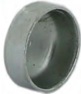
Froststopfen (Kernloch Verschlussdeckel). Durchmesser: 14,5mm. Passend für Peugeot Diesel (am Zylinderkopf), Citroen HY Diesel. Or. Nr. 0234.06. Dieser Froststopfen kann auf 14,2mm geschliffen werden. Dann passt er auch in Citroen DS, HY Benziner, 11CV. Or. Nr. (14,2mm Deckel) 457.069 + ZC9457069U.
