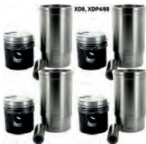
P 404D/504/J7/HY, Kolben + Zylinder (4 Stück), passend für Peugeot 404 Diesel, 504 Diesel, Peugeot J7 Diesel. Citroen HY Diesel. Für Motor: XD8, XDP4/88 (1 Serie). Hubraum: 1948ccm. Bohrung: 88mm. Kolbenbolzen: 28 x 74,40mm. Kolbenringe: 2,0 - 2,0 - 4,5mm. Abmessungen der Laufbuchse = Aussendurchmesser unten: 94mm. Höhe gesamt: 173,20mm. Aussendurchmesser oben: 104,90mm. Höhe von unten bis Wulst (Auflage) der Laufbuchse: 129mm.
