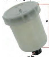
Bremsflüssigkeitsbehälter mit Verschlussdeckel, für das Bremssystem DOT. Passend für Citroen 2CV bis Baujahr 1963. Peugeot 202, 203, 403, 404. Renault Heckmotor, R4. Durchmesser: 57mm. Behälterhöhe mit Verschlussdeckel: 97mm. Gewindeanschluß auf dem Hauptbremszylinder: 3/4 16h. Made in Spain.
