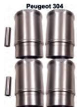
P 304, Kolben + Zylinder (4 Stück). Passend für Peugeot 304, 304S, ab Baujahr 10/1976. Motor: XL5/S. Verdichtung: 8,8:1. Hubraum: 1290ccm. Bohrung: 78mm. Kolbenbolzen: 20,50 x 68mm. Kolbenhöhe: 72,0mm. Gesamthöhe Zylinder: 133,0mm. Kolbenringe: 1,75 + 2,0 + 4,0mm.
