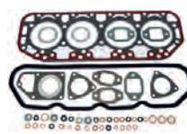
Zylinderkopfdichtsatz Indenor Diesel XDP88. Bohrung 94mm. Passend für Citroen HY Diesel + Peugeot 404 D + 504 D. Die Zylinderkopfdichtung ist 1,7mm dick.
