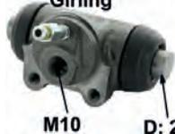
P 504, Pick Up, Radbremszylinder hinten links + rechts, per Stück. Bj. 10/81->, M 10 Anschluß, System Girling, Kolbendurchmesser = 22 mm, Ankerplattenbohrung = 32 mm, Leitungsanschluss = 10 mm, Länge über alles = 60 mm,
