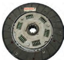
P 403, Mitnehmerscheibe Kupplung. Passend für Peugeot 403, altes Modell. Durchmesser: 215mm. Kupplungsbelag Stärke: gesamt 8,5mm. 10 Zähne mit 29/24mm Durchmesser.
