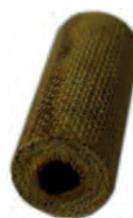
P 403/404/504, Führungshülse für die Hupenbetätigungsstange in der Lenksäule. Passend für Peugeot 403, 404 teilweise 504. Material Celaron. 2,7x6x15mm. Or. Nr. 626305
