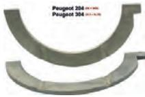
P 204/304, Anlaufscheibe für die Kurbelwelle. Passend für Peugeot 204 (Motor XK + XK4). Peugeot 304 (Motor XL3 + XL3S).
