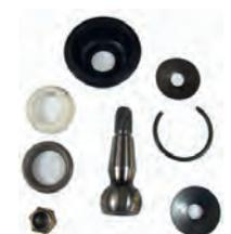
P 204/304/404, Spurstangenkopf Reparatursatz. Passend für Peugeot 204, 304 + 404. Gewinde M10, Länge 58mm, Kugelkopfdurchmesser 22mm - 14mm hoch. Die Kunststoffhalbschale (Nylon) ist 6,5mm hoch!
