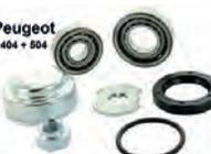
P 404/504, Radlagersatz vorne. Passend für Peugeot 404 + 504 (bis Baujahr 10/1976). Abmessung Lager 1: 52 x 20 x 15mm. Lager 2: 62 x 30 x 16mm. Or. Nr. 3748.01
