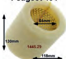
P 404, Luftfilter. Passend für Peugeot 404, ab Baujahr 03/1968. Entspricht PURFLUX A172. Höhe: ca. 130mm. Aussendurchmesser: ca. 118mm. Innendurchmesser: 84mm. Or. Nr. 1445.29
