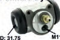
Simca/Panhard, Radbremszylinder vorne, 31.75mm Kolbendurchmesser, Simca Vedette (type abeille) vor Baujahr 1953, Panhard Dyna (4+5CV) vor Baujahr 06/1958. Ankerplattenbohrung = 36 mm, Leitungsanschluss = 11 mm, Länge über alles = 68 mm. Made in France
