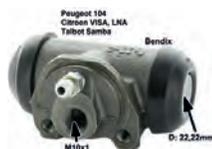
P 104/VISA/SAMBA, Radbremszylinder. Bremssystem: Bendix. Kolbendurchmesser: 22,22mm. Ankerplattenbohrung: 32mm. Bremsleitungsanschluss: M10x1. Länge über alles: 59mm. Passend für Peugeot 104, Citroen Visa, LNA, Talbot Samba
