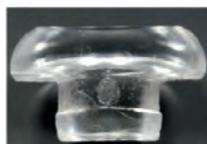
Leuchtendeckel halb (Pilzform), Farbe klar. Diese pilzförmigen Leuchten waren an vielen klassischen Peugeot montiert. In komplett klar (wird dann 2x benötigt) (Standlicht auf Kotflügel, Innenleuchte, Türeinstiegsleuchte), oder in Kombination mit einem roten oder orangen halben Pilz. (Artikelnummer 75300 + 75301). Bitte die gewünschte Kombination mit Sekundenkleber verkleben.
