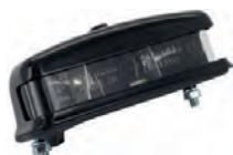
Kennzeichenleuchte aus Metall. Schwarz lackiert. Breite: 116mm. Tiefe: 51mm. Bauhöhe: 38mm. Incl. Glühbirne. Zulassung: EEC, ECE, SAE. Diese hochwertige Leuchte ist komplett aus Metall gefertigt. Daher kann sie auch farblich sehr einfach dem Auto angepasst werden. Schönes, nostalgisches Design. Made in England. Inclusive 2x Glühlampe 12V4W (Ba9s). Kabel Anschluss: Rundstecker 4mm.
