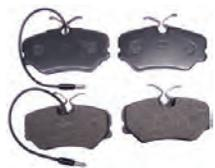
P 405/ZX, Bremsklötze vorne, Bremssystem Girling, für Peugeot 405 Serie 1 + 2, Citroen ZX. Breite 95mm, Höhe 49mm, Bremsbelagstärke 18,6mm.
