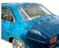
P 504, Heck - Jalousie . Passend für Peugeot 504 Limousine. Schnell eingebaut (Die Halterungen werden nur in das obere und untere Heckfenstergummi gesteckt). Ein typisches Zubehör aus den sechziger Jahren. Made In France
