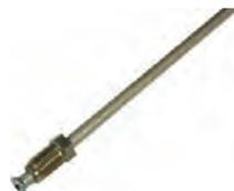
P 204, Bremsleitung hinten rechts, für Peugeot 204. Länge 650mm. Leitungsdurchmesser 4,76mm. Gewinde: M10 x 1.
