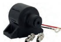
Benzinpumpe elektrisch, universal einsetzbar, nur für Vergasermotoren! 12 Volt. Diese Pumpe lässt sich sehr einfach anschrauben. Optimal für Fahrzeuge, Boote, Trecker und alle anderen Maschinen. Druck/kg: 0,5-0,7. Maximale Fördermenge: 130L/Std. Die Pumpe kann für Benzin, Diesel, Ethanol + Metahnol benutzt werden. Anschlüsse: Standard 6mm Schlauchnippel.
