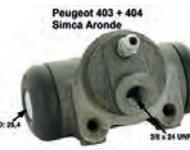
P 403/404/Simca, Radbremszylinder hinten. Passend für Peugeot 403, von Baujahr 5/1958 bis 1965. Peugeot 404 bis Baujahr 10/1965. Simca Aronde. Kolbendurchmesser: 25,4mm. Bremsleitungsanschluss: 3/8 x 24 UNF. Ankerplattenbohrung: 36mm. Länge über alles: 72mm. Or.Nr. 440215. Made in Europe.
