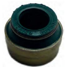
Ventilschaftdichtung (per Stück). Passend für Peugeot 504 V6. Renault R30 V6, Alpine V6. Innendurchmesser: 8,00mm. Aussendurchmesser: 14,2mm. Höhe: 10mm.
