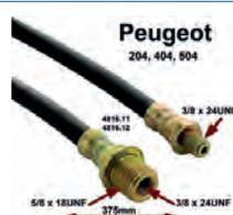
Peugeot 204, 404, 504, Bremsschlauch vorne + hinten. Passend für Peugeot 404, von Baujahr 1969 bis 1975. Peugeot 504, von 1968 bis 08/1975. Peugeot 204, von 1968 bis 1970. Länge: 375mm. Anschluß: 1x Aussengewinde 3/8x24UNF. 1x Aussengewinde 5/8x18UNF mit Innengewinde 3/8x24UNF. Or. Nr. 4816.11 + 4816.12. Made in Europe.
