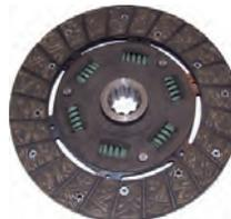
P 404/504/505, Mitnehmerscheibe. Abmessung: 215mm x 29 x 10mm. 6 Federn, 10 Zähne. Passend für Peugeot 404, ab Baujahr 1967 (alle Benziner). Peugeot 504 + 505 Benziner, mit 215mm Druckplatte und 6 Federn in der Mitnehmerscheibe.
