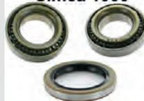
Simca, Radlagersatz Hinterachse. Passend für Simca 1000 von Baujahr 1961 bis 1978. Simca 1200 S, von Baujahr 1968 bis 1971. Inhalt: 2x baugleiche Lager. Aussendurchmesser: 50,3mm. Innendurchmesser: 27,0mm. Bauhöhe: 14,8mm.
