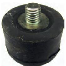
P 204/304. Gummianschlag rund, an den Motoraufhängungen. Passend für Peugeot 204, ab Baujahr 1968. Peugeot 304, bis Baujahr 11/1980. Aussendurchmesser: ca. 39mm. Bauhöhe: ca. 23mm. Gewinde: M10. Or. Nr. 1807.35
