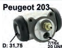
P 203/D3A, Radbremszylinder vorne, 31.75mm Kolbendurchmesser, Peugeot 203 ab Baujahr 07/1954 bis Produktionsende. Ankerplattenbohrung = 36 mm, Leitungsanschluss = 7/16x20 UNF, Länge über alles = 68 mm. Made in France
