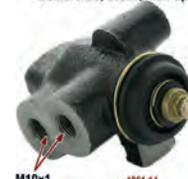
P 504, Bremskraftregler. Passend für Peugeot 504 Comerciale (Lieferwagen). 504 Break, Pick Up. Bremsleitungsanschluss: 2x M10x1. Befestigungsschraube: 2x M8. Or. Nr. 4861.14
