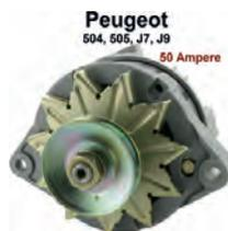
P 504/505/J7/J9, Lichtmaschine. Passend für Peugeot J7, J9, 505, 504. (Benziner mit Vergaser). 50A. Einfachschwenkarm. Drehrichtung im Uhrzeigersinn. Mit intergrierten Regler.
