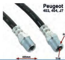
Peugeot 403/404/J7, Bremsschlauch hinten, 404 -> 1966, 5/8 ca 16mm Außengewinde, 7/16 ca 11mm Innengewinde Länge 485mm, 403 zweites Modell. J7 erste Modelle. Made in Spain.
