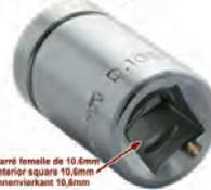
Ölwechselschlüssel (Nuss für Knarre) Innenvierkant 10.6mm. Für Ölablaßschrauben + Getriebeschrauben die einen Aussenvierkant haben. Renault R4 alte Modelle, 4CV usw. Original Facom!
