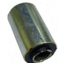
P 203/403, Silentbuchse für den oberen Querlenker. Aufnahme oben für den Stoßdämpfer. Passend für Peugeot 203 + 403. Maße: 12 x 44 x 25 x 40mm. Or. Nr. 5248.03
