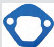
Benzinpumpendichtung für die Verschraubung am Motorblock. Passend für Citroen 2CV, Citroen DS ab 1968, Renault, Peugeot. Diese Dichtung ersetzt die Papierdichtung und ist aus "KLINGERSIL". 0,5mm dick. Klingersil ist ein extrem widerstandsfähiges Material, beständig gegen Öle, Benzin, Alkohol usw.
