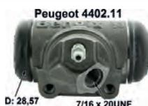
P 203/403/404, Radbremszylinder hinten. Kolbendurchmesser: 28,57mm. Bremsleitungsanschluss: 7/16 x 24 UNF. Or. Nr. 4402.11. Bendix Nr. 621019. Ankerplattenbohrung = 36 mm. Länge über alles = 72 mm. Passend für Peugeot 403 hinten links, ab 2757588, 2819485. Peugeot 403 hinten rechts, bis 2757587, 2819484 (bei dem 403 wurde die Führung der Bremsleitung geändert). Peugeot 404 hinten links.
