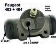
P 403/404, Radbremszylinder hinten rechts, Or.Nr.440227, Kolbendurchmesser = 23,81 mm, Ankerplattenanschluss = 36 mm, Leitungsanschluss = 3/8 x 24UNF, Länge über alles = 72 mm. Made in Europe.
