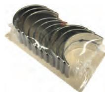
Kurbelwellenlager, Übermaß 0,50. Passend für Citroen HY Diesel. Peugeot 403D, 404D, 504D, J7D. Motor: XD/P85 + XDP90 (1816cc + 2112cc). Abmessung: 0,50 (für Kurbelwellen mit dem Maß 54,494 bis 54,509mm).
