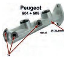
P 504/505, Hauptbremszylinder Zweikreis. Bremssystem: Bendix. Kolbendurchmesser: 20,6mm. 3x Bremsleitungsanschluss M10. Passend für Peugeot 504 Break, ab Baujahr 07/1981. 504 Pick Up, 505 Limousine.
