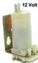
Scheibenwaschpumpe elektrisch. 12 Volt. Sehr stabile Ausführung mit verzinkter Metallhalterung. 2x Flachstecker, Anschluß von oben! Made in der EU. Die Abbildung zeigt die richtige Einbaulage. Der Pumpenteil ist unten, der Elektromotor oben! Bitte so herum einbauen. Ansonsten zieht die Pumpe nur Luft.
