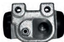
P 205, Radbremszylinder hinten rechts, Peugeot 205 ab 1983. 19,05mm Kolben, Bremsleitungsanschluss M12x1. Bremssystem Girling. Or. Nr. 440274.
