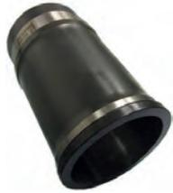
P 404/504/HY, Zylinder (ohne Kolben) Diesel. Passend für Peugeot 404 D + 504D. Citroen HY Diesel. Motor: XD88, XDP88. Bohrung: 88,0mm. Hubraum: 1948ccm. Aussendurchmesser unten: 96,0mm. Aussendurchmesser oben: 106,3mm. Höhe gesamt: 174,0mm.
