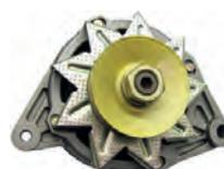
P 104, Lichtmaschine. Passend für Peugeot 104, bis Baujahr 3/1980. 40A. Einfachschwenkarm. Einbaulage: 45°. 77mm Riemenscheibe. Or. Nr. 5557.92
