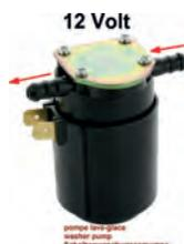
Scheibenwaschpumpe, elektrisch, Farbe schwarz. Passend für Citroen DS. Diese Pumpe ist auch super für die Nachrüstung zu verwenden, zB. 2CV, Dyane, Peugeot, Renault. Achtung: Die Pumpe ist nicht selbstansaugend. Das Wasser muss von alleine hinein laufen. Ausgang Wasser = Stromanschluß Seite. Läuft die Pumpe mehr als 15 Sekunden ohne Wasser, geht sie kaputt.
