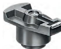
Paris Rhone, Verteilerfinger. Passend für Peugeot 204, 304, 305, 504, 505. Renault R12. Länge über alles: 50mm. Höhe über alles: 23mm. Innendurchmesser 13mm. Or. Nr. 5937.12
