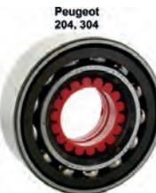
P 204/304, Radlager vorne. Aussendurchmesser: 80mm. Innendurchmesser: 40mm. Breite: 30,2mm. Passend für Peugeot 204, von Baujahr 09/1968 bis 1976. Peugeot 304, bis Baujahr 1980. Or. Nr. 3326.20 Made in Spain
