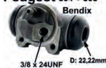
P 504/505, Radbremszylinder hinten links, System Bendix, Berline 04/75->, GL-GR-DR-Diesel 07/77->, 22mm Kolben, 3/8 x 24UNF Anschluss, Ankerplattenbohrung = 36 mm, Länge über alles = 72 mm
