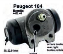
Peugeot 104. Radbremszylinder hinten rechts, Peugeot 104. Fahrzeuge mit 1 Kreis Bremsanlage ab 08/1975, Fahrzeuge mit 2 Kreis Bremsanlage von 1976 bis 09/1977. Kolbendurchmesser 23,81mm. Bremssystem Bendix. Bremsleitungsanschluss: M10x1. Or. Nr. 4402.46. Made in Europe.
