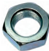
Mutter 1/2 -20 UNF, (Flachmutter). Für die Befestigung von Bremsschläuchen. Schlüsselweite: 3/4 x 5/16.
