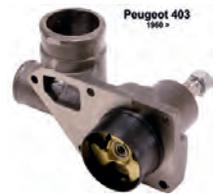
P 403, Wasserpumpe für Peugeot 403, letzte Modelle ab Baujahr 1960. Durchmesser Achse: 15mm. Länge: 53mm. Achtung: Der Peugeot 403 hat ein offenes Kühlsystem, unbedingt darauf achten dass der richtige Kühlerdeckel ohne Dichtung montiert ist. Die Wasserpumpe hat eine Leckbohrung, wo etwas Wasser austreten kann. Neue Wasserpumpen benötigen ca. 500 bis 1000km, bis sie richtig eingelaufen sind und zu 99,5% abdichten. Etwas tropfen ist normal!
