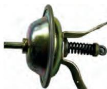
P 304, Unterdruckdose für Verteiler Ducellier M70. Peugeot 304. NOS Peugeot. Or. Nr. 5952.23
