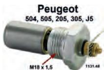
Öldruckschalter. Gewinde: M18 x 1,5. Passend für Peugeot 504 (4 Zylinder + V6). Peugeot 305 + 505, 205, J5, J7. Schaltdruck: 0,6 Bar. Or. Nr. 1131.48
