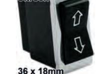
Fensterheberschalter, mit Chromrahmen. Passend für Peugeot 504, 604. Citroen CX1. Renault R16. Abmessung: 36 x 18mm.
