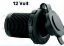
12 Volt Einbau Steckdose zur Nachrüstung (passend für einen Zigarettenanzünder). Einbauöffnung: 29mm. Einbautiefe: 48mm.
