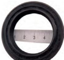
Simmerring (40 x 58 x 10) Differential beidseitig. Passend für Peugeot 204, 304, 305, 504, J7. Talbot Horizon, Samba, Solara. Innendurchmesser: 40.00mm. Aussendurchmesser: 58.00mm. Dicke: 10.00mm. Or. Nr. 3121.09. Made in Germany.
