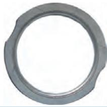
Auspuffrohrdichtung. Passend für Citroen HY Diesel (XDP88). Peugeot 504 2.3D (XD2). Peugeot J7 (XDP88, XDP4.88, XDP90, XDPX90). Innendurchmesser: 46mm. Aussendurchmesser: 60mm mit 2 Nuten! Or. Nr. 171019
