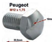
Radkappen Schraube. Passend für Peugeot 203, 403, 404. Gewinde: M12 x 1,75. Länge: 22mm. Werkzeug: 19mm.
