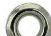
Rosette vernickelt. Für 4mm Schraube. Aussendurchmesser: 11mm. Höhe: 2,4mm. Diese Rosetten wurden verwendet für Armaturenbrett, Türverkleidungen. Passend für Citroen 2CV, DS, HY und in vielen Peugeot + Renault.
