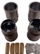
P 304, Kolben + Zylinder (4 Stück). Passend für Peugeot 304, von Baujahr 09/1970 bis 10/1975. Peugeot 304S, von Baujahr 09/1972 bis 10/1975. Motor XL3 XL3S, zweite Generation. Bohrung: 76mm. Hubraum: 1288ccm. Kolbenringe: 1,75 + 2,0 + 4,0mm. Kolbenhöhe: 73,5mm. Kolbenbolzen: 20,5 x 63mm. Höhe Laufbuchse gesamt: 128,00mm.
