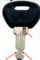
Schlüsselrohling für Zündschloß + Türschloß. Passend für Peugeot 104, von 1982 bis 1988. 305 ab 1978. 505 ab 1981. 604 von 1981 bis 1985. Citroen AXEL ab 1984. LNA ab 1984. Visa von 1982 bis 1984. Für Schlosshersteller: NEIMAN. Bitte beachten Sie den Querschnitt von dem Schlüsselbart. Schaftlänge: 24,0mm. Schaftbreite: 7,5mm.
