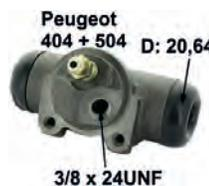
P 404/504, Radbremszylinder hinten rechts, Bremsleitungsanschluss 3/8 24UNF (9,525mm). System Bendix, 20,64mm Kolben, 404 alle Modelle mit Thermostable Bremsen ab 1969, 504 10/70 bis 01/71. Or.Nr. 4402-40, Gesamtlänge 84mm. Made in Europe.
