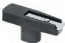
Paris Rhone, Verteilerfinger. Passend für Peugeot 104. Citroen VISA 11E. Renault R14. Talbot Samba. Länge über alles: 50mm. Bauhöhe über alles: 19mm. Innendurchmesser: 8mm. Or. Nr. 5937.20
