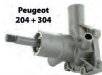
P 204/304, Wasserpumpe, mit auskuppelbaren Lüfterflügel. Länge der Achse: 54,5mm bis Wasserpumpengehäuse. 60mm bis zu der Lagerung. Passend für Peugeot 204 + 304. Für Motor: XK5/4, XK, XL, XIDL. Or. Nr. 1202.67
