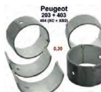
P 203/403/404 Pleuellager (kompletter Satz) für Benzin Motoren mit 3 Kurbelwellenlager. Abmessung: 0,30 Übermaß. Durchmesser Kurbelwelle: 44,675 bis 44,691mm. Breite: 27mm. Passend für Peugeot 203 (alle Motoren). Peugeot 403 (alle Benziner). Peugeot 404 erste Serie (8CV), Motor XC + XB2 (404 U6). Or. Nr. 0606.15
