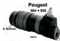
P 504/505, Kupplung Nehmerzylinder. Passend für Peugeot 504 Benziner, ab Baujahr 11/74 (4 + 6 Zylinder). Peugeot 505 + 604. Kolbendurchmesser: 28,57mm. Anschlußgewinde: M10x1. Or. Nr. 2086.10. Made in Europe.
