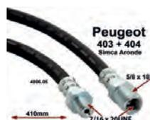
Peugeot 403+404, Bremsschlauch vorne Peugeot 403 erstes Modell, Peugeot 404 erstes Modell, Simca Aronde. Gesamtlänge 410mm. Außengewinde 7/16 x 20 UNF, andere Seite 7/16 x 20 UNF Innengewinde + 5/8 x 18H Außengewinde. Or. Nr. 4806.05. Made in Spain.
