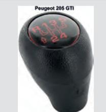
P 205, Schaltknauf, passend für Peugeot 205 GTI. Der Rückwärtsgang ist vorne links. Befestigung: Runde Aufnahme mit 4 Kerben.
