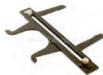
Bremstrommel und Bremsbelag Einstelllehre (nur für Bremstrommel). Komplett aus Metall. Mit dieser Lehre kann der Ist Bremstrommeldurchmesser ermittelt werden. Dieses messergebnis wird mit ca. abzüglich 2mm auf den Bremsbelag übertragen. Somit sind die Bremsbeläge optimal eingestellt, und ein zu großer Bremsleerweg, mangelnde Bremswirkung oder sogar dadurch leckende Radbremszylinder werden vermieden. Für Bremstrommeldurchmesser von 160 bis 400mm. Metrische und zöllige Skala!
