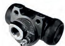
P 205, Radbremszylinder hinten links, Peugeot 205 ohne Bremskraftverstärker. Kolbendurchmesser 20,64mm. Bremssystem Bendix, Bremsleitungsanschluss M12x1. Or.Nr.440267. Made in Europe.
