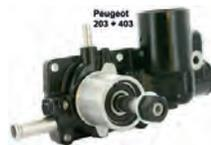
P 203/403, Wasserpumpe für Peugeot 203 + 403. Der Ventilator ist auskuppelbar, Vorwärmung für Vergaser. Achse Riemenscheibe 15mm, das Lager kommt von SKF. Or.Nr. 120243. Achtung: Der P 203 hat ein offenes Kühlsystem, unbedingt darauf achten dass der richtige Kühlerdeckel ohne Dichtung montiert ist. Die Wasserpumpe hat eine Leckbohrung, wo etwas Wasser austreten kann. Neue Wasserpumpen benötigen ca. 500 bis 1000km, bis sie richtig eingelaufen sind und zu 99,5% abdichten. Etwas tropfen ist normal!
