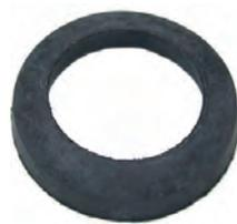
Dichtung für den Zündkerzenstecker (Kerzenschacht) in dem Ventildeckel. Passend für Citroen C25 (1,8E - Motor XM7T). Peugeot Peugeot 404, 504, J7, 505. Aussendurchmesser: 40mm. Innendurchmesser: 29mm. Höhe: 9,5mm. Or. Nr. 0213.03
