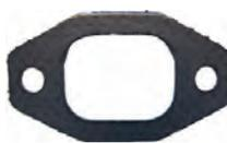
P 504/505/J7/HY, Auslasskrümmerdichtung, passend für Indenor Diesel XDP88. Bohrung 94mm. Passend für Citroen HY Diesel. Peugeot 504D, 505D, J7D, J9D. Innendurchmesser: 40 x 30mm. Bohrungsdurchmesser: 9mm. Bohrungsabstand von Mitte zu Mitte: 64mm.
