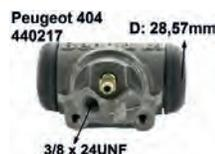
P 404, Radbremszylinder hinten rechts, Original Hersteller, 28,57mm Kolben, Ankerplattenanschluss = 36 mm, Leitungsanschluss = 3/8 x 24UNF, Länge über alles = 71 mm Made in Spain.
