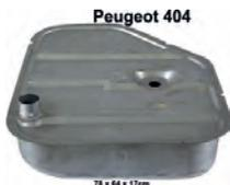
Benzintank Peugeot 404 Vergaser-Motoren, für Fahrzeuge mit Reserverad im Kofferraum! Abmessung: 78 x 64 x 17cm.
