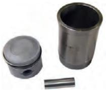
P 404, Kolben + Zylinder (4 Stück). Passend für Peugeot 404. Für Motor: XC5. Hubraum: 1618ccm. Bohrung: 84mm. Kolbenbolzen: 23 x 69mm. Kolbenringe: 2,0 - 2,0 - 4,5mm. Abmessungen der Laufbuchse = Aussendurchmesser unten: 89mm. Höhe gesamt: 136mm. Aussendurchmesser oben: 99mm. Höhe von unten bis Wulst (Auflage) der Laufbuchse: 114mm.
