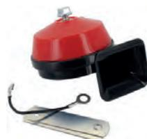
Hupe (Trompete) 12 Volt, hoher Ton. 480Hz, 108dB(A). Sehr hochwertige Hupe, made in der EU. Die Hupe ist aus Metall mit einer Abdeckung (Trompete) aus rotem Kunststoff! Universal passend. Durchmesser: ca. 110mm. ECE geprüft.
