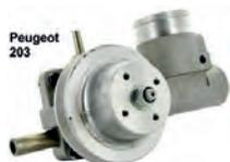
P 203, Wasserpumpe für Peugeot 203. Starrer Ventilator, Vorwärmung für Vergaser. Die Wasserpumpe wird mit Riemenscheibe geliefert. Or.Nr. 120117. Achtung: Der P 203 hat ein offenes Kühlsystem, unbedingt darauf achten dass der richtige Kühlerdeckel ohne Dichtung montiert ist. Die Wasserpumpe hat eine Leckbohrung, wo etwas Wasser austreten kann. Neue Wasserpumpen benötigen ca. 500 bis 1000km, bis sie richtig eingelaufen sind und zu 99,5% abdichten. Etwas tropfen ist normal!
