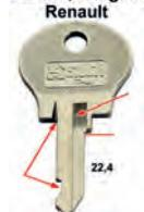
Schlüsselrohling für Zündschloß + Türschloß. Passend für Peugeot 104. 204 ab 1965. 304 ab 1969. 404 ab 1965. 504 von 1975 bis 1983. 604 von 1975 bis 1980. 104 ab 1972. Renault R4, ab Baujahr 1961 bis 1981. Citroen LN + VISA. Für Schlosshersteller: NEIMAN. Bitte beachten Sie den Querschnitt von dem Schlüsselbart. Schaftlänge: 22,4mm. Schaftbreite: 7,0mm.
