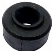
J5/C25, Gummi für Stabilisator. Peugeot J5 ab 1981, Citroen C25 ab 1985. Or. Nr. 3561.08. Innendurchmesser: 22mm. Aussendurchmesser: 48mm. Bauhöhe: 20mm.
