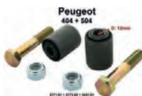
P 404/504, Panhard-Stab + Stabilisator Reparatur Satz, für die Hinterachse. Passend für Peugeot 404 Break + Pick Up. Peugeot 504 Limousine, Coupe, Cabriolet. 504 Break + Pick Up. Silentbuchse : Ø 12 x Ø 30mm, Länge 42 x 36mm (5171.01). Schraube M12x70mm (5173.03). Mutter M12 (3431.01).
