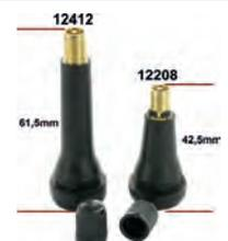
Ventil (Gummiventil) für Felge. Passend für Citroen 2CV, DS, CX, HY, GS. Renault R4, R5, R6, R8, R10, Heckmotoren. Peugeot 203, 403, 404, 504, 604, 204, 304, J7. Für Ventilloch: 11,3mm. Länge: 42,5mm.
