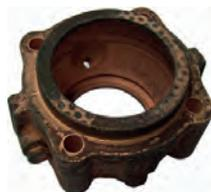
P 404/504, Halslagerflansch (Austritt Kardanwelle am Getriebe). Passend für Peugeot 404 + 504. Or. Nr. 2608.10
