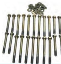
Zylinderkopfschraubensatz komplett. Passend für Peugeot 404D + 504D, J7D, Citroen HY Diesel. Für Dieselmotor XD88 + XD90. Bestehend aus: 8 x M11x91 Aussensechskant. 7 x M11x108 Aussensechskant. 7 x M11x118 Aussensechskant.
