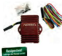
Transistorzündanlage 12V, universal passend für alle französischen Autos mit Zündkontakten. Der Kontakt dient nach dem Einbau nur noch als Schalter und verschleißt wesentlich langsamer. Lizenznachbau von Bosch!
