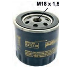
Ölfilter LS127. Passend für Peugeot Diesel + Citroen HY Diesel. Peugeot 204D, ab Baujahr 10/1969. 304D, 403D, 404D ab Baujahr 10/1969, 504 D. Höhe: 88mm. Außendurchmesser: 86mm. Gewinde: M18x1,5. Or. Nr. 1109.35
