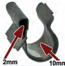
Befestigungsklammer aus Metall, für bis 10mm Leitungen. (Kabelbaum, Benzinleitung, Wasserschlauch usw.). Die Klammer kann auf jeden Blechfalz bis zur maximalen Stärke von 2mm gesteckt werden.
