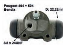
P 404/504, Radbremszylinder hinten rechts, passend für Peugeot 404, ab Baujahr 5/1968. Peugeot 504 (1,9 + 2,1 Diesel), von Baujahr 1970 bis 1975. Bremssystem Bendix. Kolbendurchmesser: 22,22mm. Bremsleitungsanschluss: 3/8 x 24UNF. Länge gesamt: ca. 72mm. Or. Nr. 4402.22. Made in Europe.
