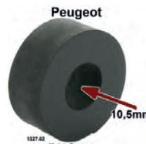
Kühler Silentgummi (Gummiblock unter der Kühlerbefestigung). Passend für Peugeot 204, 304, 403, 404, 504, 505. Innendurchmesser: 10,5mm. Durchmesser: 28mm. Bauhöhe: 12mm. Or. Nr. 1327.02 / Made in Germany
