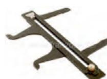
Brmsstrommel und Bremsbelag Einstelllehre (nur für Bremstrommel). Komplett aus Metall. Mit dieser Lehre kann der Ist Bremstrommeldurchmesser ermittelt werden. Dieses messergebnis wird mit ca. abzüglich 2mm auf den Bremsbelag übertragen. Somit sind die Bremsbeläge optimal eingestellt, und ein zu großer Bremsleerweg, mangelnde Bremswirkung oder sogar dadurch leckende Radbremszylinder werden vermieden. Für Bremstrommeldurchmesser von 160 bis 400mm. Metrische und zöllige Skala!
