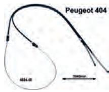
P 404, Handbremsseil hinten. Passend für Peugeot 404. Länge gesamt: 3940mm. Or. Nr. 4834.48. Made in France.
