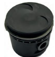
Simca 1000/1100 (Special, Rally). Kolben (4 Stück). Passend für Simca 1000 + 1100. Motor: 350/152. 2 Übermaß (0,40mm). Bohrung: 74,0mm. Kompression 9,6:1. Kolbenringe 1,75 + 2,0 + 4,0mm. Kolbenbolzen 22 x 64mm.
