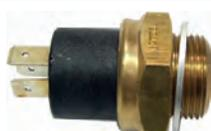
Temperaturschalter Kühlwasser CX, BX, 604 Motor J6RA600 + J6TA500 + M25 662/666/629/648/669 (Diesel+Renault). Farbmarkierung schwarz, M22x1,5. 3 Anschlüsse. Temperaturschaltung 88-83° erster Lüfter, 92-87° zweiter Lüfter.
