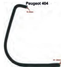
P 404, Kühlerschlauch. Passend für Peugeot 404. Gesamtlänge: ca. 550mm. Am Ende 90° abgewinkelt. Am abgewinkelten Stück 8mm Innendurchmesser. An der Gegenseite 12mm Innendurchmesser.
