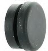
Blindstopfen aus Gummi, 8mm. Zum verschließen von z.B. Bohrungen für Hohlraumversieglungen. Für Bleche bis 2mm Stärke.
