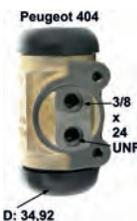
P 404, Radbremszylinder vorne (links + rechts sind baugleich). Passend für Peugeot 404, mit Hydrovac Bremsanlage (thermostable). Kolbendurchmesser: 34,92mm. Gesamtlänge: 82mm. Bremsleitungsanschluss: 3/8 x 24 UNF. Abstand Befestigungsschrauben: 44mm. Ohne Entlüftungsschraube! Made in France
