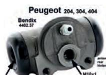
P 204/304/404, Radbremszylinder hinten, 304S Cabrio/Coupe, 404, Kolben 15/16 Zoll (23,81mm), links oder rechts passend. Bendix Nr. 621672, Or. Peugeot Nr.440237. P 204 10/65>12/77, Leitungsanschluss = 10mm, Kolbendurchmesser = 23,81 mm, Ankerplattenbohrung = 36 mm, Länge über alles = 68 mm. Made in Europe.
