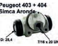
P 403/404/Simca, Radbremszylinder hinten. Passend für Peugeot 403, von Baujahr 5/1958 bis 1965. Peugeot 404 bis Baujahr 10/1965. Simca Aronde. Kolbendurchmesser: 25,4mm. Bremsleitungsanschluss: 7/16 x 20 UNF. Ankerplattenbohrung: 36mm. Länge über alles: 72mm. Bördelung Typ "E" Made in Spain.
