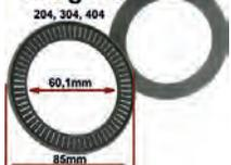
P 204/304/404, Nadellager Federbein oben (Domlager). Aussendurchmesser: 85mm. Innendurchmesser: 60,1mm. Dicke: 3,6mm. Passend für Peugeot 204, 304 + 404.
