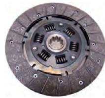
P 504, Mitnehmerscheibe. Passend für Peugeot 504 V6, ab Fin.3.644722. Getriebe: BA10/5. Durchmesser: 235mm. Zähne: 10. (235x162x3,2) (24,5x29xev). Or. Nr. 2055.67
