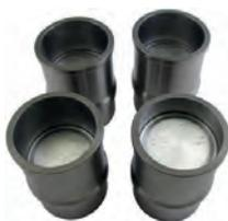
P 504 Injection, Kolben + Zylinder (4 Stück). Passend für Peugeot 504 Injection, ab Baujahr 1970. Motor: XM. Bohrung: 84,0mm. Hubraum: 1796ccm. Kolbenringe: 1,5 + 2,0 + 4,0mm. Kolbenbolzen: 23 x 70mm. Aussendurchmesser unten: 93,0mm. Aussendurchmesser oben: 99,20mm. Höhe gesamt: 136,20mm.
