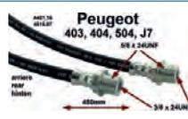
Peugeot 403/404/504/J7, Bremsschlauch hinten, passend für Peugeot 403, 404, 504, J7. Gesamtlänge 480mm. Anschlüsse beidseitig: Außengewinde 5/8 x 24UNF, Innengewinde 3/8 x 24 UNF. Or. Nr. 445116 + 481607. Made in Europe.
