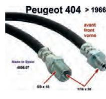
Peugeot 404 > 1966, Bremsschlauch vorne, passend für Peugeot 404 bis Baujahr 1966. Länge: 354mm. Gewinde: 7/16x20 + 5/8x18 + 7/16x20. Passend für Fahrzeuge mit 6,35mm Bremsleitung. Or. Nr. 480607. Made in Spain.
