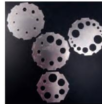
Gewindelehren, in einer neuen, simplen Form. Bestehend aus 4 Lehren aus Aluminium. Ermittlung von Durchmesser und Gewindesteigung, metrisch und zöllig imperial + US. Von Durchmesser 2,5-22mm (5/16>3/4). Gewindesteigung pitch 0,45 - 2,5mm. Da hat doch mal jemand eine wirklich gute Idee gehabt.
