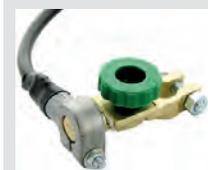
Batteriepol - Trennschalter gerade. Einfach die Rändelschraube lösen und der gesamte Stromkreis im Auto ist unterbrochen. Optimal für eine längere Nichtbenutzung des PKW. (Winterruhe). Einfacher geht es nicht! Die Minusklemme an der Batterie wird durch diesen trennbaren Pol ersetzt! (die Minusklemme die an der Batterie gesessen hat, wird nun einfach auf den Polanschluß des Trennschalters gesteckt). Umbauzeit ca. 1 Minute!
