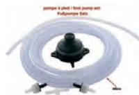
Scheibenwaschwasser Fußpumpenset. Bestehend aus Fußpumpe, 2x Rücklaufstop, 1x T-Ventil, 3 Meter Schlauch. Montage: Abgehend von der Fußpumpe mit dem T-Ventil 1x zu dem Vorratbehälter (Ventil so setzen, dass das Wasser vom Vorratbehälter durch kann) und 1x zu der Scheibenwaschdüse (Ventil lässt das Wasser in Richtung Düse durch). Die Durchflussrichtungen sind auf dem Ventil mit einem Pfeil gekennzeichnet. Montageanleitung online im Shop.
