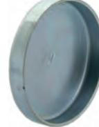
Froststopfen (Kernloch Verschlussdeckel). Durchmesser: 42mm. Passend für Peugeot 404, 504, J7. Or. Nr. 0153.05
