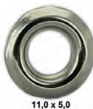
Rosette vernickelt. Für 4mm Schraube. Aussendurchmesser: 11mm. Höhe: 2,4mm. Diese Rosetten wurden verwendet für Armaturenbrett, Türverkleidungen. Passend für Citroen 2CV, DS, HY und in vielen Peugeot + Renault.
