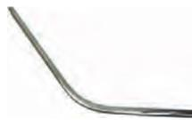
P 404, Zierleiste Edelstahl poliert, Peugeot 404. Übergang C-Säule Kotflügel oben, rechts! Or.Nr.856201
