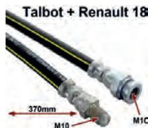
**Talbot + Renault 18** Talbot Samba/R18, Bremsschlauch. Länge: 370mm Länge. Gewinde: 1x Innengewinde M10x1. 1x Außengewinde M10x1.
