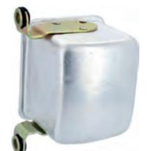
Lichtmaschinen Laderegler Gleichstrom, 12V, 9-12 A, universal. Anschlüsse: D: über Klemme 15 an Anschluss D oder D+ an der Lichtmaschine. E: =Masse. A: =Batterie Plus. F: =Dynamo Feld. Einstellbar. Für hängende Montage!
