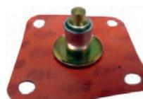
Membrane Beschleunigerpumpe, Simca 1300, Vergaser 28/35 SDIDA.
