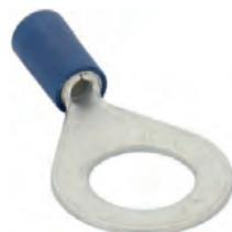
Ringzunge blau, 10mm Anschraubzunge. Blau = Kabelquerschnitt: 2,3 bis 5,0mm.
