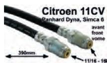
Bremsschlauch vorne, passend für Citroen 11CV Panhard Dyna, Simca 6 avant front vorne (bis Baujahr 1957). Simca 6. Panhard Dyna (ab Baujahr 10/1954). Gewinde: 11/16-16. Länge: 390mm.
