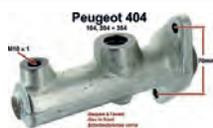
P 104/204/304/404, Hauptbremszylinder, Einkreis Bremsanlage. 19mm Kolbendurchmesser. Passend für alle Modelle bis Baujahr 1977, die vorne Scheibenbremse + hinten Trommelbremse haben. Ohne Anschluss für Bremslichtschalter. Bremsleitungsanschluss: M10x1. Die Anschlüsse sind seitlich versetzt zum Flanschanschluss. Der Flansch hat 7,5mm Bohrungsdurchmesser. 70mm Bohrungsabstand im Flansch. Made in Europe.
