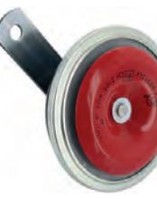
Hupe 6 Volt, hoher Ton. 430Hz, 114dB(A). Sehr hochwertige Hupe, made in der EU. Die Hupe ist von vorne in rot lackiert! Universal passend. Durchmesser: ca. 91mm. Metallgehäuse. ECE geprüft.
