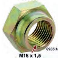
Achsmutter, Peugeot 104, 204, 304, 305, 404, 504. Gewinde M16x1,5. Schlüsselweite 24mm. Or.Nr. 693542
