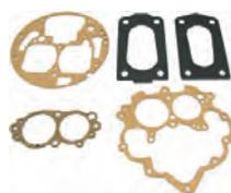
P 504/505, Vergaserdichtsatz Zenith 35/40 INAT. Passend für Peugeot 504 GL/GR. Peugeot 505 GR/SR/GL
