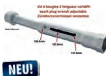
Zündkerzenschlüssel (In der Länge verstellbar), für 20,8mm Zündkerzen. Dieser Schlüssel ist genial für den Citroen DS. Er kann mit der normalen Elektrodenverlängerung genutzt werden. Aufnahme für 3/8 Zoll Knarre (mittlere Größe). Passt natürlich auch auf alle anderen Zündkerzen, für 21mm Werkzeug. Hersteller: HAZET. Längenverstellbar von: 137,5mm auf 157,5mm und 195,5mm. Mit Zündkerzen Haltegummi.
