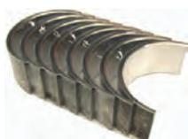
P 204/304, Pleuellager, 0,30 Übermaß. Passend für Peugeot 204 + 304. Motor XK5 1130ccm, XL5/S 1290ccm. Breite: 19,6mm
