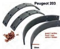
P 203, Bremsbacken Beläge, zum aufnieten. Für Bremstrommeldurchmesser: 254mm. Belagbreite: 35mm. Passend für Peugeot 203 Vorderachse + Hinterachse.
