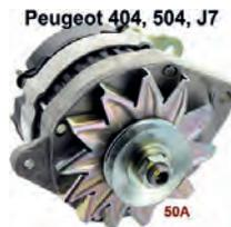
P 404/504/J7, Lichtmaschine 12V, 50A. Passend für Peugeot Fahrzeuge mit Voltmeter, oder Ladekontrollleuchte! Einfachschwenkarm. Einbauanlage rechts 20°. Neuteil, (mit integrierten Lichtmaschinenregler). Altteilerückgabe nicht erforderlich.
