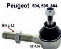
P 504/505/604, Spurstangenkopf M14x1,5, links oder rechts passend. Kugelkopf: M10. Höhe Kugelkopf: 74mm. Länge Gewindestange bis Kugelkopf: 75mm. Passend für Peugeot 504 bis Baujahr 1980. Peugeot 505 + 604.
