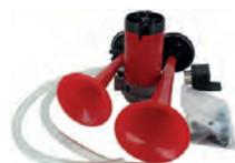
Hupe (Horn, 12 Volt), komplett mit Luftkompressor + 2 x Drucklufthorn, Relais und Luftschläuche. 750 + 800Hz (2 verschiedene Töne). 115dB(A). Länge der Luftpfeifen: 210 + 165mm. Länge des Luftkompressors: ca. 105mm.
