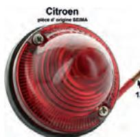
Rückleuchte bzw. Bremslicht rund, original Seima 3054. 3055. (kein Nachbau, mit Prüfzeichen). 1 Faden Leuchte, nur Brems oder Rücklicht! Mit Metallsockel + Fassung! Das Glas hat 68,5mm Durchmesser! Verwendet in HY, AZU, DS, aber auch viele Renault + Peugeot Modelle!
