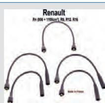
Zündkabelsatz, passend für Renault R4 (956 + 1108cc). R16 alle Modelle. R8 (980 + 1108cc). R12 (1,3L). R15 (1,3L). Matra Bagheera (1,3-1,4L). Talbot Murena (1,6L). Simca Sunbeam (alle Modelle). Zündkabelängen: 325mm, 325mm, 400mm, 425mm. Kabellänge Zündspule zu Verteilerkappe: 470mm. Made in France.
