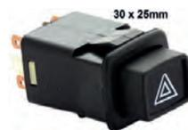
Warnblinklichtschalter Citroen LNA, Peugeot 104 von 1980 bis 1985, Peugeot 205 von 1984 bis 1987, Peugeot 504 von 1979 bis 1982, Peugeot 505 von 1979 bis 1985. 30x25mm
