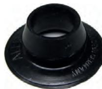
Reifenventiladapter von TR13 (13mm) auf TR15 (15mm). Dieser Adapter wird benötigt, wenn Sie alte Felgen haben, die noch ein Loch für 15mm Ventile haben. Neue Ventile sind immer 13mm im Durchmesser.
