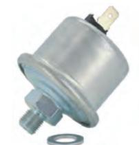
Öldrucksensor. Messbereich 0 bis 8 Bar. Gewinde M10 x 1. Passend für Citroen CX GTI Turbo. Peugeot 205 GTI. Simca 1000 Rally.
