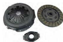
P 504/505, Kupplung komplett (Diesel). Passend für Peugeot 504 D + 505 D. Motoren: XD90, ab Baujahr 08/1981 (2,1 L). XD2, ab Baujahr 08/1981 (2,3 L). Für Getriebe: BA7, BA7/5. Nachbau mit Zentrierdorn. Durchmesser: 215mm. Zähne: 10. Verzahnung Aussendurchmesser: 29 mm. Or. Nr. 2001.92 + 2004.88
