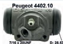
P 203/403/404, Radbremszylinder hinten. Kolbendurchmesser: 28,57mm. Bremsleitungsanschluss: 7/16 x 20 UNF. Or. Nr. 4402.10. Bendix Nr. 621019. Ankerplattenbohrung = 36 mm. Länge über alles = 72 mm. Passend für Peugeot 403 hinten links, bis 2757587 + 2819484. Peugeot 403 hinten rechts, ab 2757588, 2819485 (bei dem 403 wurde die Führung der Bremsleitung geändert). Peugeot 404 hinten rechts.
