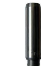
Ventilführung, für das Einlassventil + Auslassventil (per Stück). Passend für Peugeot 203 + 403 (Motoren 1290ccm TM4, TMP4, D4A, D4B, 1468ccm Motoren U8, B8). Peugeot 404 (Motor: 1468ccm U6 + 1618ccm). Innendurchmesser: 8,5mm. Aussendurchmesser: 14,05mm. Länge: 55,4mm.
