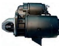
P 504/505/604/Talbot, Anlasser Peugeot 504/505/604 Diesel XD4X90, Talbot Tagora. 2,5KW, Drehrichtung Uhrzeigersinn, 10 Zähne, 3x Befestigung. Verbaut ab 08/1981.
