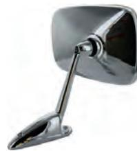
Spiegel verchromt. Nachbau (aus Taiwan) von dem "CIPA" Spiegel. Passend für Peugeot 204, 404, 504. Renault R4 bis Baujahr 1985. R5, R8, R10, R16 usw.. Lochabstand: 65,5mm. Abmessung Spiegelglas: 145 x 100mm. Ohne Prüfzeichen.
