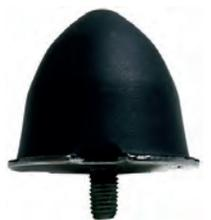
P 204, Gummianschlag Hinterachse, Peugeot 204. Or.Nr. 516610. Der Blechteller hat einen Durchmesser von 55mm, M8 Gewinde, Höhe ca. 47mm.
