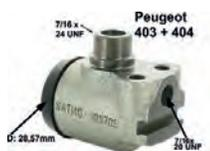
P 403/404, Radbremszylinder vorne. Links + rechts passend. Für Peugeot 403 (7-D-BD-U-L). Peugeot 404B + Coupe. Kolbendurchmesser: 28,57 mm. Bremsleitungsanschluss: 7/16 x 20UNF. Ankerplattenbohrung: 22mm. Or. Nr. 4401.14. Verbaut bei Fahrzeugen, vor Baujahr 10/1964! Made in France
