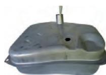
Benzintank 60 Liter. Passend für Peugeot 504 mit Benzin Motor. 1 Öffnung (36,6mm). Abmessung ca. 685 x 520mm. Bauhöhe ohne Stützen: 310 + 200mm. Bauhöhe mit Stützen: 400mm.
