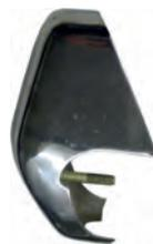
P 404, Stoßstangenhorn vorne links. Edelstahl poliert. Passend für Peugeot 404. Dieses Horn ist ohne Gummi montiert worden. Or.Nr.744850. Original!
