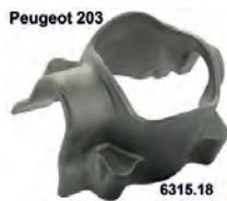
P 203, Schalthebelgehäuse (aus Metall) am Lenkrad. Passend für Peugeot 203. Or. Nr. 6315.18
