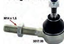
P 304/104/205/Visa, Spurstangenkopf M14x1,5, links oder rechts passend. Kugelkopf: M10. Höhe Kugelkopf: 74mm. Länge Gewindestange bis Kugelkopf: 75mm. Passend für Peugeot 304 ab 1972, Peugeot 104, Peugeot 205, Citroen Visa.
