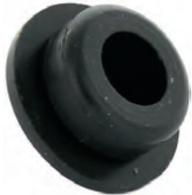
Blindstopfen aus Gummi, 12mm. Zum verschließen von z.B. Bohrungen für Hohlraumversieglungen. Für Bleche bis 2mm Stärke.
