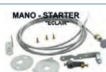
Umbausatz Startautomatik (automatischer Kaltstart, Choke) auf handbetätigten Choke. Passend für Renault 4CV, Dauphine, R8, Floride, frühe Estafette. Simca Aronde. Gesamtlänge Kabel: 2200mm.
