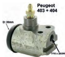
P 403/404, Radbremszylinder vorne. 1 Kolben (30mm). Bremsleitungsanschluss: 7/16 x 20 UNF. Passend für Peugeot 403 + 404 (ab Baujahr 1965). Ankerplattenbohrung 22mm. Länge über alles 65mm. Or. Nr. 4401-20. Made in France
