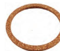
Benzinpumpen Deckeldichtung, für mechanische SEV Benzinpumpen. Abmessung: 65 x 73 x 3mm. Teilweise passend für Citroen 11CV, 15CV. Citroen HY. Renault 4CV + Dauphine. Renault 203 + 403. Made in Germany.
