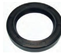
P 203/403/404/504, Simmerring für die Lagerung der Steckachse. Abmessung: 52 x 75 x 12mm. Passend für Peugeot 203, 403, 404, 504. Or. Nr. 3345.09
