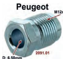
Kupplungsleitung Verschraubung. Gewinde: M12x1. Innendurchmesser: 6,5mm. Passend für Peugeot 204, 304, 404, 504, 505, J7. Or. Nr. 2091.01. Achtung: Es gab Kunststoffleitung mit 6,3mm, 7,0mm + 7,3mm Durchmesser. Gegebenfalls die Schraube auf den passenden Durchmesser aufbohren.
