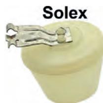
Schwimmer im Vergaser, für Solex Vergaser 30/32/34-PICS/PCIS. Durchmesser oben: 37mm, unten: 25mm, Schwimmkörperhöhe: 27mm. Verbaut zB. in 2CV4+6, Peugeot, Dauphine usw.
