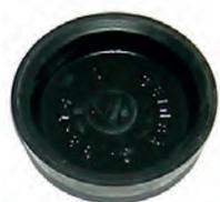
Dichtmanschette Radbremszylinder. Für 1 Zoll (25,4mm) Kolben. Or. Nr. 373005
