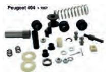
P 404, Schaltgestänge Reparatursatz, für die Lenkradschaltung. Passend für Peugeot 404, bis Baujahr 1967.
