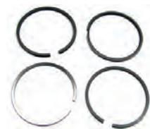
P 403, Kolbenringsatz (für 4 Kolben). Passend für Peugeot 403. Bohrung: 80,0mm. Kolbenringe: 2,0mm + 2,0mm + 4,5mm + 4,5mm.
