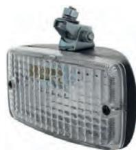
Rückfahrcheinwerfer Nachbau (Hella). Das Gehäuse ist aus Kunststoff. Breite 120mm, Höhe 70mm. Der Scheinwerfer ist für eine nachträgliche Montage unterhalb der Stoßstange! Er kann nicht als Ersatz für die originalen Rückfahrleuchten beim R4 genutzt werden! Fassung für die Glühbirne: Ba15s. Maximal 21Watt. (Unsere Nummer 14035 + 14045).
