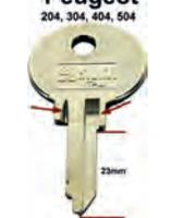
Schlüsselrohling für Zündschloss + Türschloss. Passend für Peugeot 204 ab 1965. Peugeot 304 ab 1969. 404 ab 1965. 504 Berlina von 1969 bis 1974. Für Schlosshersteller: NEIMAN. Bitte beachten Sie den Querschnitt von dem Schlüsselbart. Schaftlänge: 23,0mm. Schaftbreite: 7,0mm.
