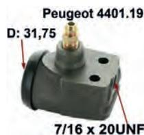
P 203/403/404, Radbremszylinder vorne. 1 Kolben, Durchmesser 1 1/4 Zoll.(31,75mm). Ohne Entlüftungsschraube. Or.Nr. 4401-19. Ankerplattenbohrung 22mm, Bremsleitungsanschluss 7/16x24 UNF, Länge über alles 63,5mm. Made in France
