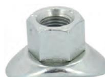
Radmutter kurz, verzinkt, für 2CV, Dyane, Mehari, AMI, GS, DS. Peugeot 403, 404, 204, 304, 504, 505. Gewinde: M12x1,25. Vor Montage ein wenig ölen. Original Lieferant, besser verarbeitet! Geeignet bis Drehmoment: 100Nm
