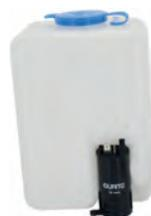
Scheibenwaschbehälter mit integrierter, elektrischer Wasserpumpe. 12 Volt. Fassungsvermögen: 1,2 L. Breite: 122mm, Bauhöhe gesamt: 185mm. Bautiefe insgesamt: 100mm. Der Behälter wird mit Halterung geliefert. Die Halterung ist von hinten an dem Behälter, und nicht zu sehen.
