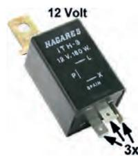
Blinkerrelais, 12 Volt, 3 polig. 180 Watt Ausgangsleistung. Passend für Citroen 2CV, DS, HY. Renault R4, Peugeot 203, 403, 404 usw.. Das Blinkerrelais macht keine "Klick-Klick" Geräusche. Steckerbelegung französisch: Stromversorgung Symbol (+). Anschluß Blinker vorne + hinten = Symbol (C). Anschluß Kontrollleuchte Armaturenbrett = Symbol (R). Falls ein japanisches Relais benutzt wird: Plus + = Symbol X oder B. Anschluß Blinker C = Symbol L. Anschluß Kontrolle R = Symbol P.
