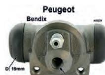
P 204/304/404, Radbremszylinder hinten Peugeot 204,304,404 Thermostable! System Bendix, 19mm Kolben, li + re, Simca 1000 ab 67 passend/ OE 440221 bis Ident:3298000 Kolbendurchmesser = 19 mm, Ankerplattenbohrung = 36 mm, Leitungsanschluss = 3/8 x 24UNF, Länge über alles = 68 mm. Made in Europe.
