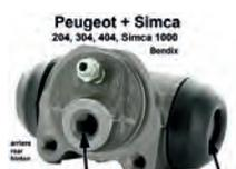
P 204/304/404, Radbremszylinder hinten (links + rechts sind baugleich). Passend für Peugeot 204, 304, 404. Für Thermostable Bremse (Bremskraftverstärker). Simca 1000, ab Baujahr 1967. System Bendix. Kolbendurchmesser: 19,0mm. Or. Nr. 4402.21 Ankerplattenbohrung: 36 mm. Leitungsanschluss: 3/8 x 24 UNF. Länge über alles: 68 mm. Made in Spain.
