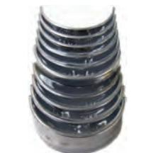
Kurbelwellenlager, Übermaß 0,30. Passend für Citroen HY Diesel. Peugeot 403D, 404D, 504D, J7D. Motor: XD/P85 + XDP90 (1816cc + 2112cc). Abmessung: 0,30 (für Kurbelwellen mit dem Maß 54,694 bis 54,709mm).
