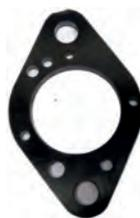
Vergaserfußdichtung Simca 1000. (Isolierplatte zwischen Krümmer + Vergaser). Öffnung 32.4mm, Lochabstand ca. 60mm.
