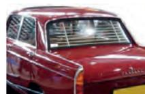
P 404, Heck - Jalousie . Passend für Peugeot 404 Limousine. Schnell eingebaut (Die Halterungen werden nur in das obere und untere Heckfenstergummi gesteckt). Ein typisches Zubehör aus den fünfziger Jahren. Made In France
