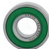
P 505/604. Führungslager (Pilotlager) für die Kupplung. Passend für Peugeot 505 + 604. Aussendurchmesser: 40,0mm. Innendurchmesser: 17,0mm. Bauhöhe: 12,0mm. Or. Nr. 524090
