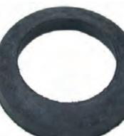
Dichtung für den Zündkerzenstecker (Kerzenschacht) in dem Ventildeckel. Passend für Citroen C25 (1,8E - Motor XM7T). Peugeot Peugeot 404, 504, J7, 505. Aussendurchmesser: 40mm. Innendurchmesser: 29mm. Höhe: 9,5mm. Or. Nr. 0213.03
