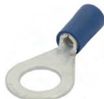
Ringzunge blau, 8mm Anschraubzunge. Blau = Kabelquerschnitt: 2,3 bis 5,0mm.
