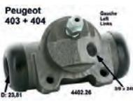
P 403/404, Radbremszylinder hinten links, Or.Nr.440226, Kolbendurchmesser = 23,81 mm, Ankerplattenanschluss = 36 mm, Leitungsanschluss = 3/8 x 24UNF, Länge über alles = 72 mm. Made in Europe.
