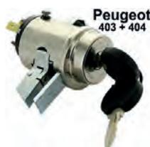
P 403/404, Zündschloß (im Armaturenbrett), passend für Peugeot 403 + 404 (erste Version). 3-Polig, davon werden zwei doppelt belegt. Gehäusedurchmesser: 39mm. Sperrbolzen: 8x13 mm. Gehäusehöhe über alles: 64 mm (ohne Kabelanschlüsse)
