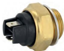
Temperaturschalter Kühlwasser. 82°-68°. Gewinde: M22x1,5. 2x elektrischer Anschluss. Passend für Peugeot 404 (alle Motoren). Peugeot 504, 505, J7, J9. Peugeot 304 (Motor XL3, XK5, XL4D), von Baujahr 09/1969 bis 06/1974. Or. Nr. 0242.12
