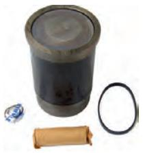
P 204, Kolben + Zylinder (1 Stück). Passend für Peugeot 204, von Baujahr 1965 bis 1967 (erste Generation). Motor: XK. Verdichtung: 8,8:1. Hubraum: 1130ccm. Wulst von oben: 7mm. Bohrung: 75mm. Kolbenbolzen: 20,5mm. Kolbenringe: 2,0 + 2,0 + 4,5mm. 53PS- Der Motorblock ist geteilt!
