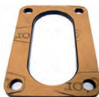
Vergaserfußdichtung Simca 1100. (Isolierplatte zwischen Krümmer + Vergaser). Aussenmaß: 70 x 103mm. Dicke: 5,0mm. Innenmaß ca: 40 x 86mm.
