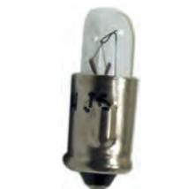
Glühlampe 12 Volt, 2 Watt. Sockel BA7 s. Original Kontrollleuchten 2CV, HY usw
