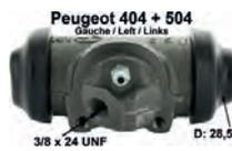
P 404/504, Radbremszylinder hinten links. System Bendix. Kolbendurchmesser: 28,57mm. Bremsleitungsanschluss: 3/8 x 24UNF. Ankerplattenbohrung: 36mm. Länge über alles: 82mm. Passend für Peugeot 404, ab Baujahr 10/1969. Peugeot 504 Pick Up, von Baujahr 06/1979 bis 09/1981. Or. Nr. 4402.29. Made in Europe.
