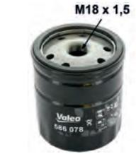
Ölfilter LS152B/LS144B. Passend für Peugeot 204, von Baujahr 10/1970 bis 09/1975. Peugeot 304, Peugeot 404 ab Baujahr 1968, 504, J5, Citroen C25. Anschlußgewinde: M18 x 1,5mm. Höhe: ca. 98mm
