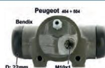
P 404/504, Radbremszylinder hinten rechts, Peugeot 404 + 504, System Bendix, Kolbendurchmesser = 22 mm, Ankerplattenanschluss = 36 mm, Leitungsanschluss = M10x1, Länge über alles = 82 mm> Made in Europe.
