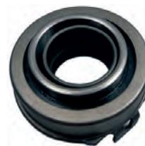
P J5/C25, Kupplung Ausrücklager. Passend für Peugeot J5 (Benziner + Diesel). Citroen C25 (Benziner + Diesel).
