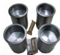
P 403/404/J7, Kolben + Zylinder (4 Stück). Passend für Peugeot 403 (8CV), von Baujahr 1955 bis 1961. Peugeot 404 U6 Commerciale (8CV). Peugeot J7 B 1400kg. Hubraum: 1468ccm. Bohrung: 80,0mm. Kolbenbolzen: 22 x 67mm. Kolbenringe: 2,0 + 2,0 + 4,5 + 4,5mm (4 Ringe). Gesamtlänge der Zylinder: 140mm.
