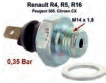
Öldruckschalter. Gewinde: M14 x 1,5. Schaltdruck: 0,2 bis 0,45 Bar. Passend für Renault R4 (ab Baujahr 1967), R5, R16. Citroen CX1 2000-2200, CX2 20RE. Peugeot 505 2.0 + 2,2.
