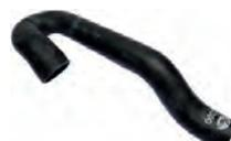
P 504/505, Kühlerschlauch oben. Passend für Peugeot 504 Diesel (2,3), Peugeot 505 (2,3D). Or. Nr. 1343.36 + 1343.61
