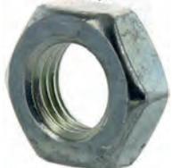
M12x1,5 Mutter. Flache Bauform. Für die Befestigung von Bremsschläuchen.
