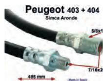
Peugeot 403+404, Bremsschlauch hinten. Länge: 495mm. Passend für Peugeot 404, erste Baujahre. Peugeot 403. Simca Aronde. Gewinde: 1 Seite Außengewinde 5/8-18H + Innengewinde 7/16-20H. Andere Seite: Aussengewinde 7/16-20H. Made in Spain.
