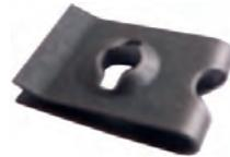
Aufschiebemutter 2,9 (Blechmutter). Für Blechtreiberschraube mit 2,9mm Kerndurchmesser. Abmessung: 12,0 x 11,0mm.
