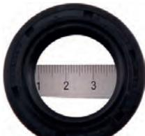
Simmerring (29,85 x 47 x 9,9) Differential rechts. Passend für Peugeot 205, 305. Citroen ZX 1.4. Talbot Horizon, Solara. Innendurchmesser: 29,85mm. Aussendurchmesser: 47mm. Dicke: 9,9mm. Or. Nr. 3121.10
