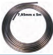
Brems + Hydraulikleitung. Durchmesser: 7,95mm (5/16 Zoll). Länge: 5 Meter. Material: Kunifer (Kupfer - Nickel Legierung, gut zu verbiegen, Kunifer rostet nicht). Bördelschrauben bitte extra bestellen!
