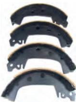
Brmsbacken (1 Satz). Bremssystem: Bendix. Passend für die Vorderachse bei Renault R4, R5. Passend für die Hinterachse für, Renault R16 von Baujahr 06/1965 bis 07/1967. Peugeot Hinterachse: 204/304, von Baujahr 03/1966 bis 12/1972. Peugeot 404, ab Baujahr 1965. Bremstrommeldurchmesser: 229mm. Belagbreite: 42mm. Nachbau.
