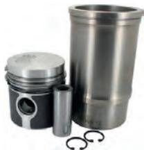
P 404D/504/J7/HY, Kolben + Zylinder (1 Stück), passend für Peugeot 404 Diesel, 504 Diesel, Peugeot J7 Diesel. Citroen HY Diesel. Für Motor: XD8, XDP4/88. Hubraum: 1948ccm. Bohrung: 88mm. Kolbenbolzen: 28 x 72,0mm. Kolbenringe: 2,0 - 2,0 - 4,5mm. Abmessungen der Laufbuchse = Aussendurchmesser unten: 96mm. Höhe gesamt: 173,10mm. Aussendurchmesser oben: 106,30mm. Original Kolbenschild!
