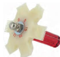
Kühler Kamm (Lamellen Kamm). Mit diesem Werkzeug können die Lamellen von Autokühler, Ölkühler und Wärmetauscher der Heizung geglättet werden. Es gibt 6 verschiedene Aufsätze, sodass für jede Kühlerlamelle das richtige Werkzeug vorhanden ist. Durch ausgerichtete Lamellen ist dann die volle Kühlleistung wieder gegeben!
