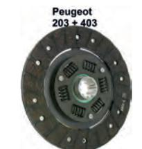
P 203, Kupplung Mitnehmerscheibe. Passend für Peugeot 203. Durchmesser: 200mm. 10 Zähne. Für Welle mit 30x25mm. Or. Nr. 2054.12
