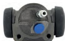
Simca, 1000, Radbremszylinder vorne links. Passend für Simca 1000, ab Baujahr 09/1961. Kolbendurchmesser: 22 mm. Ankerplattenbohrung: 36mm. Bremsleitungsanschluss: 9 mm. Länge über alles: 68 mm Made in Spain.
