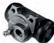
P 205, Radbremszylinder hinten rechts, Peugeot 205 mit Bremskraftverstärker. Kolbendurchmesser 19,05mm. Bremssystem Bendix, Bremsleitungsanschluss M12x1. Or.Nr.440266. Made in Europe.
