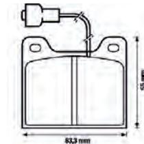
Simca 1100, u. Talbot Horizon, Bremsklötze vorne. System Girling. Breite: 63,5mm, Höhe: 55,2mm Dicke: 14,4mm.
