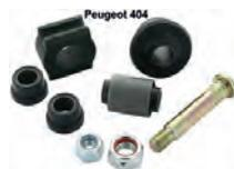
P 404, Radaufhängungs Reparatur Satz vorne (Querlenker), pro Seite für Peugeot 404. Bestehend aus: Gummiblock 4-eckig mit 24mm Bohrung, 1x Buchse 29x32mm, 2x Buchse 16mm Innendurchmesser - Aussendurchmesser 25 x 30mm - Länge 17mm, 1x Silentbuchse 16mm Innendurchmesser - Aussendurchmesser 34mm - Länge 41,5mm. Der Bolzen hat 14mm Durchmesser.
