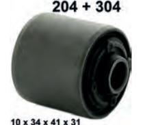
P 204/304, Silentbuchse Dreieckslenker am Fahrschemel, Peugeot 204 + 304. Maße : Innen 10mm, außen 34mm. Lang: Innen 41mm, außen 31mm. Or Nr. 352311
