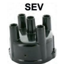
SEV, Verteilerkappe, feststehende Kohlestifte. Verteilerdurchmesser: 63,0mm. Passend für Citroen 11CV, HY, DS, Peugeot, Citroen. Der passende Verteilerfinger hat unsere Nummer 48247. Or. Nr. DM211-15A + DM211-15B
