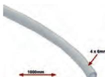
Wasserschlauch Scheibenwasser, PVC klar. Innendurchmesser: 4mm, Aussendurchmesser: 6mm. Betriebsdruck maximal 6,0 bar. Per Meter. Kundenzuschnitt, Rückgabe nicht möglich!
