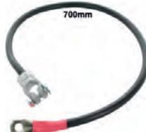
Pluskabel (Batterie zu Anlasser). Gesamtlänge: 700mm. Kabelquerschnitt: 25mm<sup>2</sup>. Made in EU. Universal passend.
