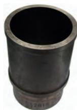
P 304, Zylinder (4 Stück). Passend für Peugeot 304 (75PS). Motor: XL3S. Verdichtung: 8,8:1. Hubraum: 1288ccm. Bohrung: 76,0mm. Aussendurchmesser: 89,200 mm. Länge über alles: 128,30mm.
