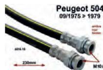
Peugeot 504, Bremsschlauch hinten. Passend für Peugeot 504 mit hinterer Scheibenbremse. Baujahr 09/75 bis 1979, 230mm lang, Anschluss: 2x Innengewinde M10x1. Made in Europe.
