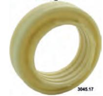
P 203/403/404/504, Ölrückhalterung (Ölfangring) Hinterachsrohr rechts. Passend für Peugeot 203, 404, 404 + 504. Aussendurchmesser: 61,12mm. Innendurchmesser: 40,2mm. Markierung: weiß. Or. Nr. 3045.17
