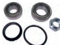
P 104/VISA/Talbot, Radlagersatz hinten Visa alle Modelle, LNA, Peugeot 104, Talbot Samba. 1x Lager 47,1mm aussen, 24,9mm innen, 11,6mm Breit. 1x Lager 42,1mm aussen, 19,8mm innen, 12mm Breit. Hersteller SKF.
