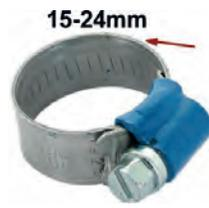
Schlauchschele 15-24mm, speziell für Kühlerschlauch. Nostalgische Optik. Geprägtes Band mit hochgestellten Kanten. Somit wird ein Verquetschen des Schlauches vermieden. Kleines Schraubgehäuse mit 7mm Sechskantschraube (mit Schlitz). Bandbreite: 12mm. Normale, moderne Schlauchsellen zerquetschen den Schlauch. Das wird mit diesen Schellen komplett vermieden. Und sie sehen auch noch besser aus.
