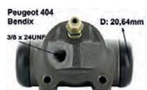
P 404, Radbremszylinder hinten rechts. System Bendix. Kolbendurchmesser: 20,64mm. Anschlussgewinde: 3/8 x 24UNF. Ankerplattenbohrung: 35,7mm. Baulänge: 70mm. Passend für Peugeot 404, alle Modelle Saloon. Von Baujahr 10/1967 bis 05/1968. 404 alle Thermostable Saloon, von 1966 bis 10/1969. 404 alle Modelle USA, ab 1966. Or. Nr. 4402.23, Made in Europe.
