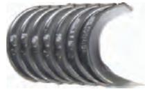
P 204/304, Pleuellager, 0,50 Übermaß. Passend für Peugeot 204 + 304. Motor XK5 1130ccm, XL5/S 1290ccm. Breite: 19,6mm
