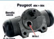
P 404/504, Radbremszylinder hinten links, Peugeot 404 + 504, System Bendix, 22mm Kolben, M10x1 Anschluss, Ankerplattenbohrung = 36 mm, Länge über alles = 82 mm. Made in Europe.
