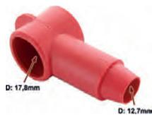
Gummikappe für den Anschluß an den Anlasser. (Schutzkappe). Diese Kappe sollte nie fehlen. Universal passend! Für max. Kabeldurchmesser: 12,7mm. Innendurchmesser 17,8mm. Farbe: rot
