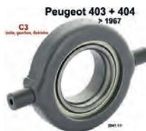
P 403/404, Ausrücklager, für C3 Getriebe (nicht für BA7 passend). Passend für Peugeot 403 + 404, bis Baujahr 1967 (ausgenommen 403 U8, 403/7 Diesel). Für alle Motoren. Das Ausrücklager ist kugellagert. Or. Nr. 2041.11. Bitte die Vorlast der Kupplung neu einstellen. Peugeot Arbeitsanweisung 2/0101-0102 + 2/0201 + 2/0401 > 0405.
