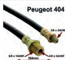
Peugeot 404, Bremsschlauch vorne, passend für Peugeot 404 bis Baujahr 1966. Länge: 354mm. Gewinde: 3/8 x 24 Außengewinde, 3/8 x 24 Innengewinde + 5/8 x 18 Aussengewinde. Passend für Fahrzeuge mit 4,5mm Bremsleitung. Made in Spain.
