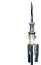
Zylinderhongergerät 50-180mm. Zum Einsatz in elektrische Bohrmaschinen. Durch einstellbaren Druck keine Einschnitte in dem Zylinder (z.B. für Radbremszylinder, HBZ, Laufbuchsen). Mit Honsegmenten 100mm, 3-armig.
