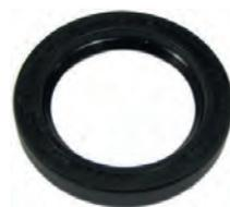
Simmerring für die Nockenwelle. Abmessung: 35 x 50 x 8. Passend für Peugeot Diesel Motoren: XUD7, XUD9, XUD11 bis Baujahr 01/1994. Or. Nr. 0236.14
