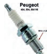
Zündkerze NGK BP5ES. Passend für Peugeot 404 Vergaser, Peugeot 504 (2,0 TI), 504 V6. Gewinde: M14 x 1,25 x 16mm. Schlüsselweite 21mm.
