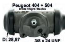
P 404/504, Radbremszylinder hinten rechts. System Bendix. Kolbendurchmesser: 28,57mm. Bremsleitungsanschluss: 3/8 x 24UNF. Ankerplattenbohrung: 36mm. Länge über alles: 82mm. Passend für Peugeot 404, ab Baujahr 10/1969. Peugeot 504 Pick Up, von Baujahr 06/1979 bis 09/1981. Or. Nr. 4402.28. Made in Europe.
