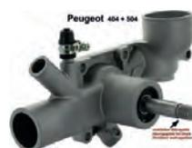
P 404/504, Wasserpumpe, für auskuppelbaren Lüfterflügel. Passend für Peugeot 404 + Peugeot 504. Motor: Für 1,6, 1,8, 2,0L (XC7). Verbaut ab Baujahr 1960. Die Wasserpumpe ist für die erste Version, mit auskuppelbaren Lüfterflügel. Länge der Welle: 53mm. 3x Anschluß (1x verschlossen). Or. Nr. 1202.60
