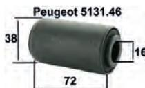
J5, Silentbuchse Hinterachse, Peugeot J5 ab 1981. Aussendurchmesser: 38mm. Innendurchmesser: 16mm. Länge über alles: 72mm. Or. Nr. 513146
