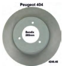
P 404, Brems Scheibe vorne (1 Stück). System Bendix. Passend für Peugeot 404, ab Baujahr 10/1968. Durchmesser: 285mm. Dicke: 10mm. Innenlochdurchmesser: 80mm. 3 Lochbefestigung. Or. Nr. 4246.46
