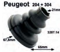
P 204/304, Antriebswellenmanschette getriebeseitig. Passend für Peugeot 204 + 304. Durchmesser: 21mm + 67,5mm. Höhe: 65mm. Or. Nr. 3287.14
