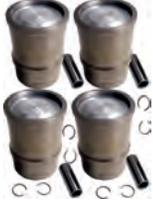
P 404/504/J7, Kolben + Zylinder (4 Stück), passend für Peugeot 404, 504 + J7. Für Motor: XC7, XC7P. Hubraum: 1618ccm. Verdichtung: 7,6:1. Bohrung: 84mm. Kolbenbolzen: 23 x 70mm. Kolbenringe: 2,0 - 2,0 - 4,5mm. Abmessungen der Laufbuchse = Aussendurchmesser unten: 93mm. Höhe gesamt: 136,20mm. Aussendurchmesser oben: 99,20mm. Höhe von unten bis Wulst (Auflage) der Laufbuchse: 90,03mm.
