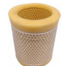
P 205, Luftfilter. Passend für Peugeot 205 (1.0 bis 1.4L), von Baujahr 02/1983 bis 10/1987. Aussendurchmesser: 128mm. Innendurchmesser: 94mm. Höhe: 145mm. Or. Nr. 1445.95
