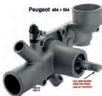
P 404/504, Wasserpumpe, für starren Lüfterflügel. Passend für Peugeot 404 + Peugeot 504. Motor: Für 1,6, 1,8, 2,0L (XC7). Verbaut ab Baujahr 1960. Die Wasserpumpe ist für die erste Version, mit starren Lüfterflügel. Länge der Welle: 37mm. 3x Anschluß. Or. Nr. 1202.13 + 1202.37
