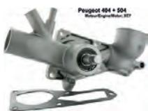
P 404/504, Wasserpumpe, starrer Ventilator. Passend für Peugeot 404 + Peugeot 504. Für 1,6, 1,8, 2,0L Motoren (XM/XM7). Die Wasserpumpe ist für die zweite Version, mit starren Lüfterflügel. 4x Anschluß. Länge der Welle: 37mm. Or. Nr. 1201.78 + 1202.69 + 1202.83
