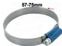
Schlauchselle 57-75mm, speziell für Kühlerschlauch. Nostalgische Optik. Geprägtes Band mit hochgestellten Kanten. Somit wird ein verquetschen des Schlauches vermieden. Kleines Schraubgehäuse mit 7mm Sechskantschraube (mit Schlitz). Bandbreite: 12mm. Normale, moderne Schlauchschellen zerquetschen den Schlauch. Das wird mit diesen Schellen komplett vermieden. Und sie sehen auch noch besser aus.
