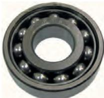
P 403/404/504, Differentiallager (vorderes Lager). Passend für Peugeot 403, 404, 504. Außendurchmesser: 62mm. Innendurchmesser: 25mm. Bauhöhe: 16,9mm.
