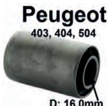
P 403/404/504, Silentbuchse Aufnahme Blattfeder an der Hinterachse, Peugeot 403, Peugeot 404 + 404 Pick Up, Peugeot 504 Pick Up. Maße innen 16mm, außen 32mm. Länge innen 54mm, außen 50mm
