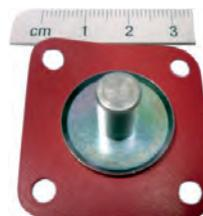
Membrane Beschleunigerpumpe, Peugeot 204, 304 Solex 34 PBISA3-4. Peugeot 404 Solex 34 BICSA3, Renault R6 Solex PDIS. Simca 1000, 1100, 1307 Vergaser Solex 32/34 BICSA, 32 BISA.
