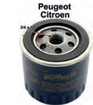
Ölfilter LS498C. Passend für Peugeot 204 (ab Baujahr 10/1975), 304, 205, 305. Citroen BX, C15, LN, Visa (10-11-14). Anschlußgewinde: 3/4 x 16. Bauhöhe: ca. 92mm.
