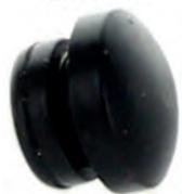
Blindstopfen aus Gummi, 6mm. Zum verschließen von z.B. 6mm Bohrungen für Hohlraumversieglungen. Für Bleche bis 2mm Stärke.
