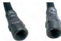
Simca 900/1000/1100/1200, Bremsschlauch hinten. Anschluss M10 Innengewinde beidseitig. Länge 330mm. Original Hersteller!
