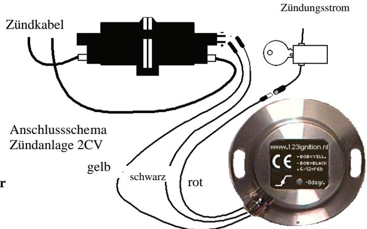
An die **frei werdende** Steckverbindung der Zündspule montieren Sie nun das gelbe Kabel!
