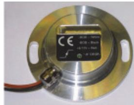
Le système est prêt à la pose. Dans l'emballage, vous trouverez le boîtier avec 3 fils et un sachet avec 2 petits cylindres couleur laiton ainsi que des raccords électriques. Enfilez les 2 petits cylindres sur les tiges qui tenaient les masselottes auparavant. Ces deux cylindres magnétiques sont les émetteurs.
