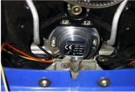
Führen Sie die Kabel durch das Motorlüftergehäuse nach oben zur Zündspule!
