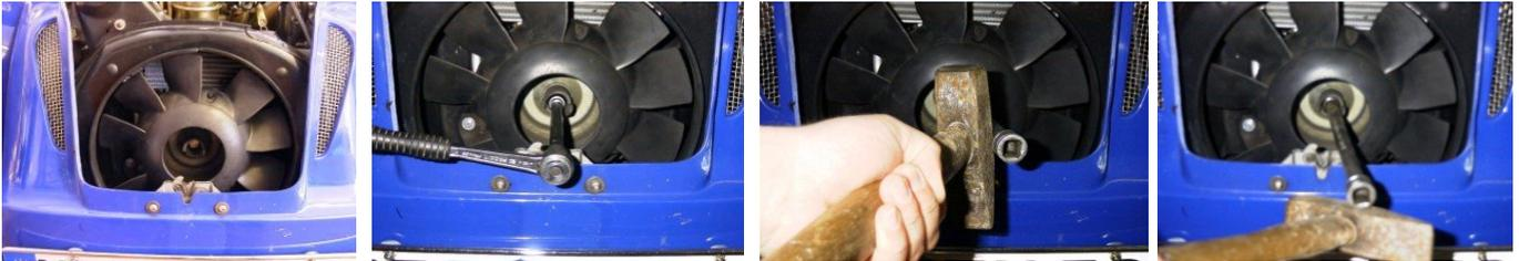
Die Riemenscheibe ist mittig mit einer Schraube gesichert. Sie müssen nun diese Schraube mit einer dünnwandigen 14 Nuss lösen. Blockieren Sie dazu mit einen Schraubendreher oder Meißel die Schwungscheibe am Zahnkranz!
