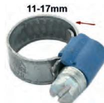
Schlauchschele 11-17mm, speziell für Kühlerschlauch. Nostalgische Optik. Geprägtes Band mit hochgestellten Kanten. Somit wird ein Verquetschen des Schlauches vermieden. Kleines Schraubgehäuse mit 7mm Sechskantschraube (mit Schlitz). Bandbreite: 9mm. Normale, moderne Schlauchschele zerquetschen den Schlauch. Das wird mit diesen Schellen komplett vermieden. Und sie sehen auch noch besser aus.
