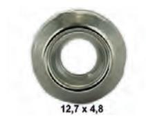
Rosette vernickelt. Für 4mm Schraube. Aussendurchmesser: 12,7mm. Höhe: 2,5mm. Diese Rosetten wurden verwendet für Armaturenbrett, Türverkleidungen. Passend für Citroën 2CV, DS, HY und in vielen Peugeot + Renault.
