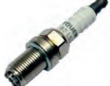
Zündkerze NGK BP6ES. Passend für Citroën GSA, Citroën SM IE. Peugeot 505. Renault R16, R17, R18. Gewinde M14x1,25. Schlüsselweite: 21mm. Gewindelänge: 19mm. Für die Montage einer Elektrodenverlängerung.
