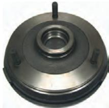
Bremsstrommel hinten (per Stück). Passend für Renault R4 (852ccm), bis Baujahr 08/1986. Renault R5 + R6. Durchmesser: 160mm. Gesamthöhe: 68mm. Bremsfläche: 35mm.
