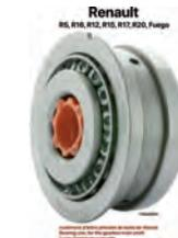
Lager hinten, für die Getriebehauptwelle. Passend für Renault R16, R12, R15, R17, R20, Fuego, R5. Aussendurchmesser: 67/75mm. Innendurchmesser: 25mm. Bauhöhe: 40,5mm Or. Nr. 770309181
