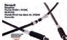
Handbremsseil Trommelbremse. Passend für Renault Dauphine, Floride R1094 + R1095. R8 R1132 + Floride R1131 bis Ident. Nr. 372240. Caravelle bis Ident. Nr. 205187. Länge gesamt: 1900mm. Tülle: 830 + 810mm. Or. Nr. 8551733
