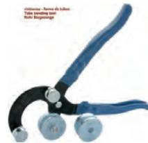
Biegezange für Bremsleitungen! Geeignet für Blech-, Kupfer-, Stahl- und Aluminiumleitungen. Biegungen bis zu 90°. Passend für Rohr-Ø: 3/16" (4,75mm), 1/4" (6,35mm), 5/16" (7,93mm), 3/8 (9,52mm).
