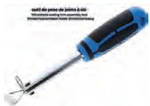
Scheiben (Windschutzscheibe) Keder Montagewerkzeug. Mit diesem Werkzeug wird die Gummilippe (Dichtung) gespreizt und es kann dann gleichzeitig der Keder eingezogen werden.
