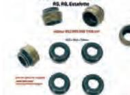
Ventilschaftdichtung, für Einlass und Auslass passend (8 Stück). Für Motor: 852ccm, 955ccm, 956ccm, 1108ccm. Passend für Renault R4, R5, R8, Estafette. Aussendurchmesser: 13,2mm. Höhe: 10mm. Innendurchmesser: 7,0mm.
