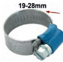
Schlauchschnelle 19-28mm, speziell für Kühlerschlauch. Nostalgische Optik. Geprägtes Band mit hochgestellten Kanten. Somit wird ein Verquetschen des Schlauches vermieden. Kleines Schraubgehäuse mit 7mm Sechskantschraube (mit Schlitz). Bandbreite: 12mm. Normale, moderne Schlauchschnellen zerquetschen den Schlauch. Das wird mit diesen Schnellen komplett vermieden. Und sie sehen auch noch besser aus.
