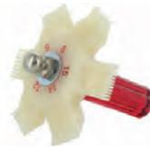
Kühler Kamm (Lamellen Kamm). Mit diesem Werkzeug können die Lamellen von Autokühler, Ölkühler und Wärmetauscher der Heizung geglättet werden. Es gibt 6 verschiedene Aufsätze, sodass für jede Kühlerlamelle das richtige Werkzeug vorhanden ist. Durch ausgerichtete Lamellen ist dann die volle Kühlleistung wieder gegeben!
