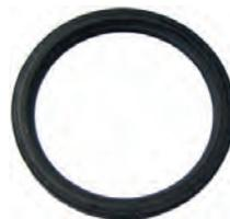
Simmerring Radnabe Hinterachse. Passend für Renault R5 + R16. Abmessung: 58 x 48 x 4mm. Or. Nr. 0855599900
