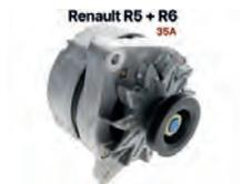
Lichtmaschine Renault R5 + R6, ohne Lichtmaschinenregler. 12 Volt. 35 Ampere. Einbaulage: 45°. Drehrichtung gegen den Uhrzeigersinn.
