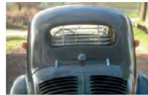
4CV, Heck - Jalousie . Passend für Renault 4CV. Schnell eingebaut (Die Halterungen werden nur in das obere und untere Heckfenstergummi gesteckt). Ein typisches Zubehör aus den fünfziger Jahren. Made In France
