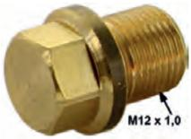
Benzintank Ablassschraube (M12 x 1). Passend für Citroën 11CV + 15CV, ab Baujahr 07/1952. Or. Nr. 595362. Auch für viele Peugeot + Renault passend.
