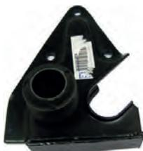
R4, Schwingarmaufnahme, hinten links (schwingarmseitig, dreieckig mit Silentbuchse). Passend für Renault R4. Or. Nr. 0832108100
