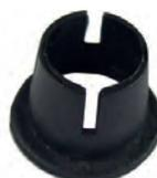
R5, Buchse für die Gangschaltung. Passend für Renault R5, für den Umbau auf Getriebe 385. Dadurch ist unten am Getriebe nur ein 12mm Bolzen. Da der Durchmesser der Schaltstange dann größer ist, wird diese Buche zur Reduzierung benötigt.
