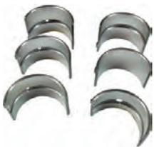
R4/4CV/Dauphine/R5, Kurbelwellenlager (3 Lager, B = Billancourt). Standardmaß. Breite: 1x 27,10mm, 1x 30,10mm, 1x 32,84mm. Kurbelwelle: 39,975 bis 39,990mm. Passend für Renault Motor: 662, 680 702, 690, 839 706, 670, 800,B1B, 800 70. Hubraum 603cc, 748cc, 782cc, 845cc. Passend für Renault R4, 4CV, Dauphine, Dauphinoise, Juvaquatre, R5 (782cm<sup>3</sup>), Floride
