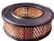
Luftfilter - Einsatz (System Lautrette). Passend für Renault R4 (0,8L). Aussendurchmesser: 187mm. Innendurchmesser: 109mm. Höhe: 62mm.
