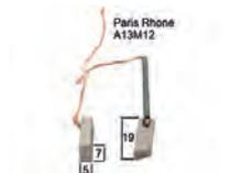
Lichtmaschinenkohlen, für Paris Rhone A13M12. Passend für Peugeot, Renault, Citroën (2CV, DS). Länge: 19mm. Dicke: 5mm. Höhe: 7mm.
