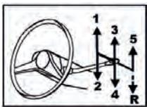
R16, Aufkleber für das Schaltschema (ist an der Windschutzscheibe angebracht). Passend für Renault R16. 5 Gang Getriebe.
