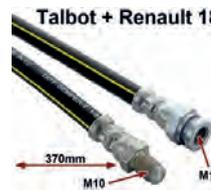
Talbot Samba/R18, Bremsschlauch. Länge: 370mm Länge. Gewinde: 1x Innengewinde M10x1. 1x Außengewinde M10x1.
