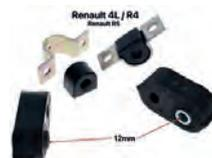
R4/R5, Stabilisator Reparatur Satz, für 12mm Stabilisator. Passend für Renault R4 + R5. Inhalt: 2x Schelle, 2x Gummibuchse für Schelle, 2x Aufhängungsgummi außen (Metallhülslenlänge = 32 mm). Achtung: Die Gummibuchse für die Halterung Stabi an der Karosserie hat immer ca. 15-16mm Durchmesser, die drückt sich erst durch die Verschraubung mit der Halteschelle richtig an.
