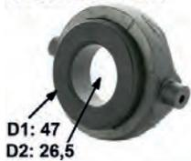
4CV, Ausrücklager Kupplung, mit Graphitring. Passend für Renault 4CV. Aussendurchmesser Graphitring: 47mm. Innendurchmesser Graphitring: 26,5mm. Benötigtes Ausrückgabel-Innenmaß 60mm. Das Lager ist eine verstärkte Nachfertigung.
