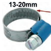
Schlauchschnelle 13-20mm, speziell für Kühlerschlauch. Nostalgische Optik. Geprägtes Band mit hochgestellten Kanten. Somit wird ein Verquetschen des Schlauches vermieden. Kleines Schraubgehäuse mit 7mm Sechskantschraube (mit Schlitz). Bandbreite: 9mm. Normale, moderne Schlauchschnellen zerquetschen den Schlauch. Das wird mit diesen Schnellen komplett vermieden. Und sie sehen auch noch besser aus.
