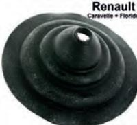
Dauphine, Gummimanschette für den Schalthebel (im Innenraum). Passend für Renault Dauphine.
