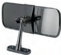
Innenspiegel verchromt. Abmessung ca.: 155 x 60mm. Der Spiegel hat eine Halterung zum verschrauben. Lochabstand für die Verschraubung: 40,0mm.
