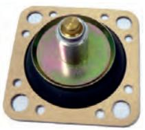
Membrane Beschleunigerpumpe, Peugeot 504 mit vergaser Solex 32/35 SEIEA 3, P 104 + 305 35/35 TMIMA + 28/35 CICSA, Renault R5 32 TMIMA, R9 + R14 + R21 32/34 Z2 - 32 BIS - 32/35 TACIC. Citroën BX 14 - Solex 32/34 Z2. Stößelhöhe 12,5mm. Rechteckig 36x36mm.
