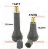
Ventil kurz (Gummiventil) für Felge. Passend für Citroën 2CV, DS, CX, HY, GS. Renault R4, R5, R6, R8, R10, Heckmotoren. Peugeot 203, 403, 404, 504, 604, 204, 304, J7. Für Ventilloch: 11,3mm. Länge: 42,5mm.
