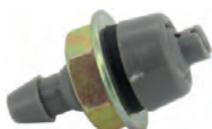
Scheibenwaschdüse Kunststoff grau. Universal passend. 4mm Schlauch Anschluß. Die Scheibenwaschdüse wird mit einer Mutter von hinten verschraubt. 1 Wasserstrahl. Geringe Aufbauhöhe. Montage Durchmesser: 8,0mm.
