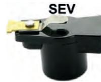
SEV, Verteilerfinger für Verteilerkappe 48134. (feststehende Kohlestifte). Passend für Citroën 11CV, HY, DS, Peugeot, Citroën. Innendurchmesser 14mm. (Aufnahme am Verteiler). Tiefe der Aufnahme 8,5mm. Verteilerfingerlänge über alles = 50mm.
