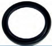
Simmerring Kurbelwelle hinten. Abmessung: 70 x 90 x 10mm. Passend für Renault R4 (852ccm). R5, R6, R8, R10, R12, R15.
