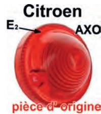
Rücklichtkappe rot (Original AXO, mit Prüfzeichen). Passend für Citroën AK. Citroën DS Break. HY, Mehari. Breiter Leuchtenkragen. Aussendurchmesser 71mm, Befestigungslöcher mitte zu mitte ca. 55mm, Kragenhöhe von innen gemessen: 14,5mm. Wir konnten einige tausend Kappen aufkaufen. Kein Nachbau (NOS).
