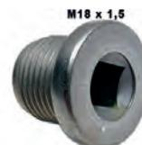
Ölablaßschraube (Motor, Peugeot Getriebe, Peugeot Hinterachse). Gewinde: M18 x 1,5mm (Innenvierkant). Passend für Peugeot 203, 403, 404, 504, J7. Passend für alle Motoren. Renault R4. Citroën HY Diesel. Or. Nr. 0311.07 + 0311.04
