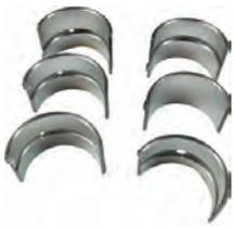
R4/4CV/Dauphine/R5, Kurbelwellenlager (3 Lager, B = Billancourt). 1 Übermaß (+0,25). Breite: 1x 27,10mm, 1x 30,10mm, 1x 32,84mm. Kurbelwelle: 39,975 bis 39,990mm. Passend für Renault Motor: 662, 680 702, 690, 839 706, 670, 800,B1B, 800 70. Hubraum 603cc, 748cc, 782cc, 845cc. Passend für Renault R4, 4CV, Dauphine, Dauphinoise, Juvaquatre, R5 (782cm<sup>3</sup>), Floride
