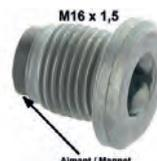
Ölablaßschraube mit Magnet (Innenvierkant 8x8). Gewinde: M16 x 1,5. Passend für Peugeot 204, 304, 404, 504, 604, 505, J5, J7, J9. Renault R5. Citroën CX, BX, ZX, C15. Or. Nr. 2221.11
