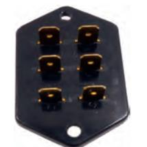
Elektrik Verbinder (Sicherung). Passend für Renault R4, R8, R10, R12, R16. Or. Nr. 77.00.502.746
