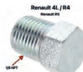
R4/R5, Motorblock Verschlusschraube. Gewinde: 1/8 NPT (sehr ähnlich zu M10x1, wird oft verwechselt). Passend für Renault R4 und R5 (Motor 688, C1E + C1C, Hubraum 956cm<sup>3</sup> + 1108cm<sup>3</sup>). Diese Schraube ist mindestens 2x im Motorblock montiert. Zum kompletten entleeren der Kühlflüssigkeit aus dem Motor, kann diese Schraube raus geschraubt werden! Or. Nr. 7703075009
