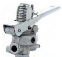
**R18/Feugo, Bremskraftregler.** Passend für Renault 18, FUEGO (1.4+1.6). Bremssystem: Bosch-Bendix. Anschlüsse: 3/8x24 UNF + M12x1.
