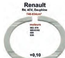
R4/4CV/Dauphine/R5, Kurbelwelle Anlaufscheibe (Axialspiel), 0,10mm Übermaß. Abmessung: Innendurchmesser 44mm, Außendurchmesser 55,6mm. Passend für Renault Motor: 662, 680 702, 690, 839 706, 670, 800,B1B, 800 70. Hubraum 603cc, 748cc, 782cc, 845cc. Passend für Renault R4, 4CV, Dauphine, Dauphinoise, Juvaquatre, R5 (782cm<sup>3</sup>), Floride
