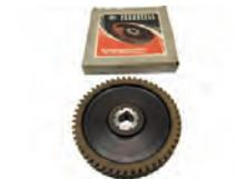
Primaquat, Nockenwellen Antriebsrad (Novotex). 52 Zähne. Aussendurchmesser: 161mm. Innendurchmesser: 22mm. Original von Ferrozell
