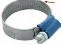
Schlauchschelle 26-38mm, speziell für Kühlerschlauch. Nostalgische Optik. Geprägtes Band mit hochgestellten Kanten. Somit wird ein Verquetschen des Schlauches vermieden. Kleines Schraubgehäuse mit 7mm Sechskantschraube (mit Schlitz). Bandbreite: 12mm. Normale, moderne Schlauchschellen zerquetschen den Schlauch. Das wird mit diesen Schellen komplett vermieden. Und sie sehen auch noch besser aus.
