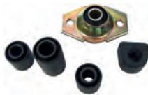
R4, Vorderachsgummisatz, für eine Seite. Passend für Renault R4. Inhalt: 3x Gummisilentbuchse, Stabilisatorlagerung + Lagerflansch für Schubstrebe unter Querlenker.
