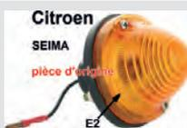
Blinker komplett (orange), original Seima 3054. 3055 (kein Nachbau, mit Prüfzeichen). Metallsockel + Metallfassung! Das Glas hat 68,5mm Durchmesser! Passend für Citroën 2CV (vorne), AZU + AK (hinten), Mehari (vorne + hinten), DS Break (hinten), HY (vorne + hinten). Renault R4, frühe Baujahre.
