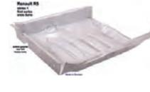
R5, Bodenwanne innen, hinten links, Renault R5, 1 Serie. Nachfertigung mit allen Sicken und Verstärkungen. Made in Europe.
