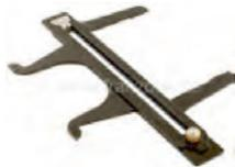
Bremsstrommel und Bremsbelag Einstelllehre (nur für Bremsstrommel). Komplett aus Metall. Mit dieser Lehre kann der Ist Bremsstrommeldurchmesser ermittelt werden. Dieses messergebnis wird mit ca. abzüglich 2mm auf den Bremsbelag übertragen. Somit sind die Bremsbeläge optimal eingestellt, und ein zu großer Bremsleerweg, mangelnde Bremswirkung oder sogar dadurch leckende Radbremszylinder werden vermieden. Für Bremsstrommeldurchmesser von 160 bis 400mm. Metrische und zöllige Skala!
