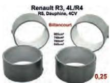
R4/4CV/Dauphine/R5, Pleuellagersatz. Breite 21,16mm. 1 Übermaß (+0,25). Passend für Renault Motoren: 662, 690, 680 702, 839 706, 670, 800 710. (603cc, 748cc, 782cc, 845cc). Verbaut von Baujahr 1951 bis 12/1985. Für Pleuelzapfen: 37,75mm. Passend für R4, 4CV, Dauphine, Dauphinoise, Juvaquatre, R5 (782cm<sup>3</sup>), Floride, Estafette (747cm<sup>3</sup>)
