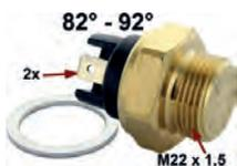
Temperaturschalter Kühlwasser. 92°-82°. Gewinde: M22. 2x elektrischer Anschluss. Passend für Peugeot 204, 504, 505, 604. Renault R4, R5, R6, R16, R20. Or. Nr. Peugeot: 1810.14
