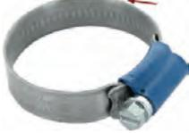
Schlauchschelle 32-44mm, speziell für Kühlerschlauch. Nostalgische Optik. Geprägtes Band mit hochgestellten Kanten. Somit wird ein Verquetschen des Schlauches vermieden. Kleines Schraubgehäuse mit 7mm Sechskantschraube (mit Schlitz). Bandbreite: 12mm. Normale, moderne Schlauchschellen zerquetschen den Schlauch. Das wird mit diesen Schellen komplett vermieden. Und sie sehen auch noch besser aus.
