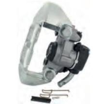
Bremsattel (1 Kolben) hinten links, mit integrierter Feststellbremse. Bremssystem Bendix. Kolbendurchmesser: 30mm. Dieser Bremsattel ist in sehr vielen Peugeot 205, Renault R5 Super verbaut worden. Neuteil. Altteilerückgabe nicht erforderlich. Or. Nr. 440161, 441007, 440161, 7701202142
