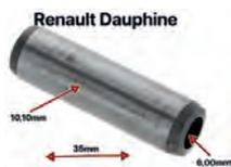
Ventilführung Einlass + Auslass. Passend für Renault mit Heckmotor (Dauphine). Innendurchmesser: 6,00mm. Aussendurchmesser: 10,10mm. Länge: 35mm
