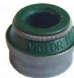
Ventilschaftdichtung, für Einlass und Auslass passend (per Stück). Für Motor: 747ccm, 782ccm, 845ccm. Passend für Renault R4, R5, Dauphine. Aussendurchmesser: 14,2mm. Höhe: 10mm. Innendurchmesser: 8,0mm.
