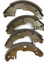
Bremsbacken hinten (1 Satz). Bremssystem: Bendix. Passend für Renault R4, R5 (ab Baujahr 09/1977). Bremstrommeldurchmesser: 180mm. Belagbreite: 32mm. Nachbau.
