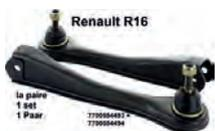
R16, Spurstange links + rechts (1 Set). Passend für Renault R16. Or. Nr. 7700554493 + 7700554494 Made in Italy
