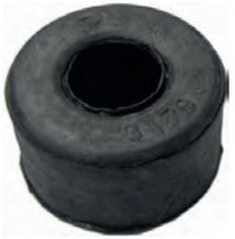
R8/R10, Gummibuchse für den Stabilisator. Passend für Renault R8 + R10. Innendurchmesser: 18mm. Außendurchmesser: 40mm. Bauhöhe: 25mm.
