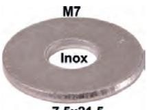
M7, Unterlegscheibe groß, aus Edelstahl, 7,5x21,5mm, 2mm dick. (Karoseriescheibe)
