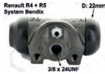
R4/R5, Radbremszylinder hinten. Links + rechts passend. Bremssystem: Bendix. Passend für Renault R4 (R1128 ab 07/1982, R112C ab 7/1986, R2340 + 2430 ab 10/1977). Renault R5 TL, TS, GTL, LS, Alpine. Renault R6. Kolbendurchmesser: 22,2mm. Bremsleitungsanschluss: 3/8 x 24UNF. Ankerplattenbohrung: 32mm. Länge: 59mm. Made in Europe.
