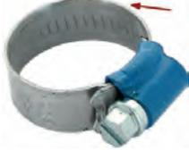
Schlauchschelle 19-28mm, speziell für Kühlerschlauch. Nostalgische Optik. Geprägtes Band mit hochgestellten Kanten. Somit wird ein Verquetschen des Schlauches vermieden. Kleines Schraubgehäuse mit 7mm Sechskantschraube (mit Schlitz). Bandbreite: 12mm. Normale, moderne Schlauchschellen zerquetschen den Schlauch. Das wird mit diesen Schellen komplett vermieden. Und sie sehen auch noch besser aus.
