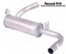
R16, R1150, R1152, R1153, R1155, R1157. Vorschalldämpfer (erster Schalldämpfer), passend für Renault R16 1150, 1152, 1153, von Baujahr 1969 bis 1975. R1155, R1157, verbaut bis Baujahr 1976. 1x Anschluss Innendurchmesser 45,5mm. 1x Anschluss Aussendurchmesser 45mm.
