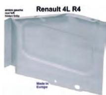
R4, Verschlussblech hinten links, für den Längsholm. Passend für Renault R4. Made in Europe.
