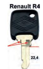
Schlüsselrohling für Zündschloß + Türschloß. Passend für Renault R4, von Baujahr 1961 bis 1991. Für Schlosshersteller: NEIMAN. Bitte beachten Sie den Querschnitt von dem Schlüsselbart. Schaftlänge: 22,4mm. Schaftbreite: 6,9mm.
