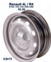
Felge 4,0x13 (Nachbau). Passend für Renault R4 (R112C, 1123, 1128, 210B, 239B). Renault R5, R6. Lochkreis: 3x130mm. Einpresstiefe: 28mm. Die Felge hat mittig kein Loch für die Aufnahme einer Radkappe! Or. Nr. 7701349069.
