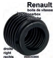
Dichtung rechts, für die Schaltstange Achse, am Getriebe (365 Getriebe). Passend für alle Renault mit 365 Getriebe. Z.B Renault R12, R16, R20, Fuego, Alpine. Or. Nr. 0608353800. Öffnung Durchmesser: 23 + 25mm. Länge: 35mm.
