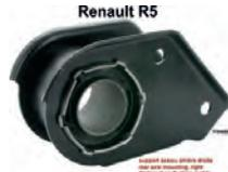
R5, Hinterachsaufnahme rechts (mit Silentbuchse). Passend für Renault R5. Or. Nr. 77006558. Silentbuchse: Innendurchmesser 35,5mm. Außendurchmesser: 62,0mm. Länge Buchse: 50mm.
