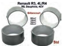
R4/4CV/Dauphine/R5, Pleuellager (kompletter Satz). Abmessung: Standardmaß (41,128 bis 41,138mm). Breite: 21,16mm. Passend für Renault Motoren: 662, 690, 680 702, 839 706, 670, 800 710, B1B. (603cc, 748cc, 782cc, 845cc). Verbaut von Baujahr 1951 bis 12/1985. Passend für Renault R4, 4CV, Dauphine, Dauphinoise, Juvaquatre, R5 (782cm<sup>3</sup>), Floride, Estafette (747cm<sup>3</sup>). Für Pleuelzapfen: 38,00mm.
