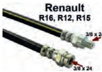
R16/R12/R15, Bremsschlauch vorne (links + rechts passend). Passend für Renault R16, von Baujahr 1965 bis 1976. Renault R12, R15. 1x Innengewinde 3/8 x 24h. 1x Außengewinde: 3/8 x 24h. Or. Nr. 7701348758
