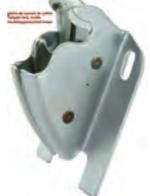
R4, Kofferraumschloss innenseitig (Heckklappenschloss). Passend für Renault R4. Je nach Ausführung, muss die Aufnahme in dem Schloss um 0,25mm aufgefeilt werden, damit die Schlossfalle einrücken kann.
