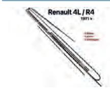
R4, Bremsleitungssatz. Passend für Renault R4, ab Baujahr 1971. 6 Leitungen. "E" Bördel beidseitig. (Trichter). Länge ca.: 45cm, 60cm, 60cm, 105cm, 128cm, 296cm. Alle Leitungen haben 3/8 UNF Gewinde. Schlüsselweite 10.
