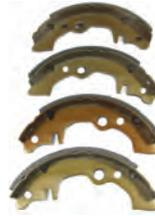
Bremsbacken hinten (1 Satz). Bremssystem: Bendix. Passend für Renault R4, ab Baujahr 07/1986. Renault R5. Peugeot 104. Citroën LNA, Visa. Bremstrommeldurchmesser: 180mm. Belagbreite: 32mm. Nachbau
