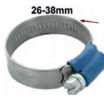
Schlauchschnelle 26-38mm, speziell für Kühlerschlauch. Nostalgische Optik. Geprägtes Band mit hochgestellten Kanten. Somit wird ein Verquetschen des Schlauches vermieden. Kleines Schraubgehäuse mit 7mm Sechskantschraube (mit Schlitz). Bandbreite: 12mm. Normale, moderne Schlauchschnellen zerquetschen den Schlauch. Das wird mit diesen Schnellen komplett vermieden. Und sie sehen auch noch besser aus.
