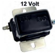
Lichtmaschinen Laderegler Drehstrom 12V, universal. Anschlüsse: IGN = +(15). FLD = EXC, oder DF an Lichtmaschine (Anschluss an den Kohlen). Masse - über Gehäusebefestigung! Optisch sehr ansprechend! Abmessung Gehäuse: 64mm x 40mm. Gesamtbauhöhe: 56mm. Abmessung Verschraubung Grundplatte: 83mm x 83mm. Verschraubung Abstand (Langlöcher) von 60 bis 70mm.
