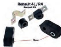
R4/R5, Stabilisator Reparatur Satz, für 10mm Stabilisator. Passend für Renault R4 + R5. Inhalt: 2x Schelle, 2x Gummibuchse für Schelle, 2x Aufhängungsgummi außen (Metallhülslenlänge = 32 mm). Achtung: Die Gummibuchse für die Halterung Stabi an der Karosserie hat immer ca. 15-16mm Durchmesser, die drückt sich erst durch die Verschraubung mit der Halteschelle richtig an.
