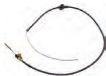
Handbremsseil Renault R16 vorne, von Baujahr 1965 bis 1974. Or. Nr. 7700521741. Gesamtlänge: 1940mm. Tülle: 1380mm.
