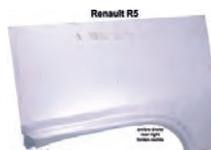
R5, Radlaufblech hinten rechts (Kotflügel Teilstück).
