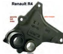
R4, Drehstabaufnahme hinten rechts. Feinverzahnt. Original Renault, kein Nachbau. Passend für Renault R4.
