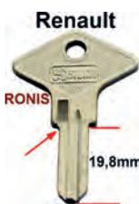
Schlüsselrohling für Türschloß. Passend für Renault R12, von 1969 bis 1971. R15 von 1971 bis 1979. R16 von 1965 bis 1980. R17 von 1971 bis 1979. R5 von 1972 bis 1979. R6 von 1968 bis 1980. Für Schlosshersteller: RONIS. Bitte beachten Sie den Querschnitt von dem Schlüsselbart. Schaftlänge: 19,8mm. Schaftbreite: 7,0mm.
