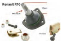
R16, Trag-Führungsgelenk. Passend für Renault R16 unten. Verbaut ab Baujahr 09/1968 (R1151, 1152, 1153, 1154, 1156, 1157). Bolzenhöhe bis Anschraubfläche: 75mm. Gewindehöhe: 20mm. Gewindemaß: M12 x 1,25. Or. Nr. 7701453022. Made in Italy
