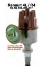
Zündverteiler, passend für Renault R4 (alle Motoren, außer Motortyp 800 = 3 Kurbelwellenlager, 747ccm, 782ccm, 845ccm), R5, R8, R10, R12, R15, R17. Ersatztyp für Ducellier Verteiler. Incl. Unterdruckdose. Passende Verschleißteile: Kontakt = 34084, Kondensator = 34026, Verteilerfinger = 72007
