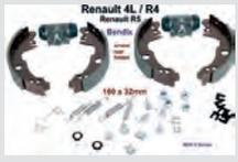
Bremsbacken hinten (Bremsensatz, mit 2x Radbremszylinder + Bremsbacken). Ohne Hebel für Handbremse. Bremssystem: Bendix. Passend für Renault R4, R5. Kolbendurchmesser: 22mm. Bremstrommeldurchmesser: 180mm. Belagbreite: 32mm. Erstaustatter Qualität. Made in Europe.
