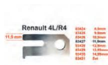
R4, Lenkgetriebe Einstellscheibe. Maß 11,9mm. Diese Einstellscheibe ist für die korrekte Ausrichtung des Lenkgetriebes (damit es nicht zu Verspannungen kommt). Siehe im Werkstatthandbuch! Es gibt 7 verschiedene Einstellscheiben! Passend für Renault R4. Or. Nr. 7700555566
