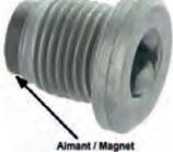
Ölablaßschraube mit Magnet (Innenvierkant 8x8). Gewinde: M16 x 1,5. Passend für Peugeot 204, 304, 404, 504, 604, 505, J5, J7, J9. Renault R5. Citroën CX, BX, ZX, C15. Or. Nr. 2221.11
