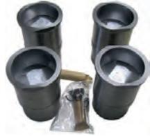
A110, Kolben + Zylinder (4 Stück). Passend für Renault Alpine A110. Hubraum: 1596cc. Bohrung: 77,8mm. Kolbenbolzen: 21 x 66,50mm. Kolbenringe: 1,75 + 2 + 4,0mm. Aussendurchmesser unten: 82,50mm. Aussendurchmesser oben: 96,0mm. Höhe gesamt: 143,50mm.
