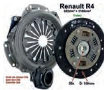
Kupplung komplett. Passend für Renault R4 (852ccm + 1108ccm), bis Baujahr 1975 (R2106, R2109 1968>, R2391, R1120, R1123, R1126). Getriebe 354. Die Kupplung hat 160mm Durchmesser, die Mitnehmerscheibe 20 Zähne. Markenqualität (VALEO). Or. Nr. 7701464763 (komplett). 7701033150 (Mitnehmerscheibe). 7701032876 (Druckplatte). 7701616841 (Ausrücklager)
