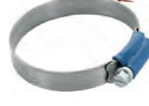
Schlauchschelle 50-65mm, speziell für Kühlerschlauch. Nostalgische Optik. Geprägtes Band mit hochgestellten Kanten. Somit wird ein Verquetschen des Schlauches vermieden. Kleines Schraubgehäuse mit 7mm Sechskantschraube (mit Schlitz). Bandbreite: 12mm. Normale, moderne Schlauchschellen zerquetschen den Schlauch. Das wird mit diesen Schellen komplett vermieden. Und sie sehen auch noch besser aus.
