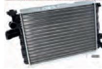
R5, Kühler für Renault R5 1,3(R1224, 1394) von Baujahr 09/1975 bis 09/1984. R5 1,4 Alpine (R1223), von 06/1979 bis 09/1981. R5 1,4 Alpine Turbo (122B), von 10/1981 bis 01/1985. Kühlernetzabmessung: 430mm + 280mm + 22mm. Or. Nr. 7700704654 + 6001000460.
