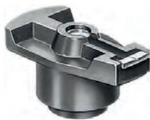
**Bosch**, Verteilerfinger. Passend für Peugeot 204, 304, 504, 505, 305. Renault R12. Länge über alles: 50mm. Höhe über alles: 24mm. Innendurchmesser: 13mm. Or. Nr. 5937.12
