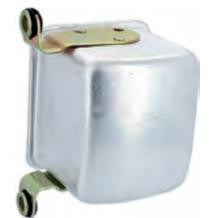
Lichtmaschinen Laderegler Gleichstrom, 12V, 9-12 A, universal. Anschlüsse: D: über Klemme 15 an Anschluss D oder D+ an der Lichtmaschine. E: =Masse. A: =Batterie Plus. F: =Dynamo Feld. Einstellbar. Für hängende Montage!
