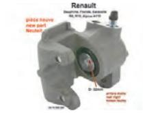
Heckmotor, Bremsattel hinten rechts (Neuteil). Bremssystem: Bendix. Kolbendurchmesser: 32mm. Passend für Renault R8, R10, A110, Floride, Caravelle, Dauphine. Gewinde für Bremserschlauch: 3/8 x 24 UNF
