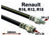
R16/R15/R12, Bremsschlauch vorne. Passend für Renault R16, R12, R15. Länge: 345mm. Gewinde: 1x Innengewinde 3/8x24. 1x Außengewinde 3/8x24. Made in Europe.
