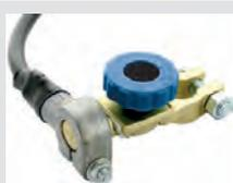
Batteriepole - Trennschalter gerade. Einfach die Rändelschraube lösen und der gesamte Stromkreis im Auto ist unterbrochen. Optimal für eine längere Nichtbenutzung des PKW. (Winterruhe). Einfacher geht es nicht! Die Minusklemme an der Batterie wird durch diesen trennbaren Pol ersetzt!(die Minusklemme die an der Batterie gesessen hat, wird nun einfach auf den Polanschluß des Trennschalters gesteckt). Umbauzeit ca. 1 Minute!
