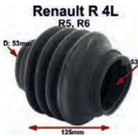
Antriebswellenmanschette, getriebeseitig. Passend für Renault R4, R5, R6. Innendurchmesser beidseitig: 53mm. Gesamtlänge: 125mm.
