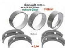
R4/R5/R8/R10/Estafette, Kurbelwellenlager (5 Lager, C = Cleon). Für Kurbelwellen mit 54,8mm Durchmesser. 0,50 Übermaß. Breite: 5x 19,47mm. Passend für Renault Motoren: 688 1, C1E700, C1E754, C1E715, C1E720, C1E750. Hubraum: 1108cc. Für Motoren ab Baujahr 1975 (54,8mm). Bis Baujahr 1974 wurden Kurbelwellen mit 44mm Durchmesser verbaut.
