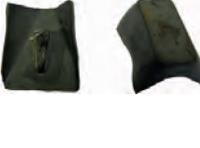
R16, Führungsgummis (2 Stück) für die Heckklappe vom Renault R16. Or.Nr. 0830051000 + 0830051100
