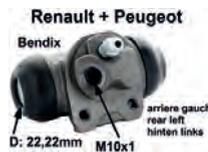
Radbremszylinder hinten links. Bremssystem Bendix. Kolbendurchmesser: 22,22mm. Bremsleitungsanschluß: M10x1. Achtung: Der Abstand der Befestigungsbohrungen (Gewinde) ist nur 25mm! Ankerplattenbohrung: 32mm. Passend für Peugeot 309. Renault Fuego, R5, Super 5, R9, R11, R18, R21. Made in Europe.
