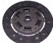
Mitnehmerscheibe, passend für Renault Caravelle, R8. Durchmesser: 160mm. Anzahl Zähne: 20. Nabenprofil: 15,2 x 17,3-20N. Nachbau
