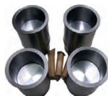
R4/R5/R6/R8/R10, Kolben + Zylinder (4 Stück). Passend für Renault Motor mit Hubraum: 1108ccm (34 bis 53 PS). Motor: 688/C1E. Bohrung: 70,0mm. Verdichtung: 9,5:1. Schaftmaß: 85,8mm (Motorblockbohrung). Kolbenbolzen: 18 x 62mm. Kolbenringe: 1,75 - 2,0 - 3,5mm. Passend für Renault R4 GTL, R4 F6, R5 TL + GTL, R6 TL, R8 Major/S, R10, Estafette. Aussendurchmesser unten: 75,44mm. Aussendurchmesser oben: 85,80mm. Höhe gesamt: 135,0mm.
