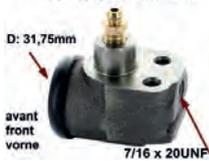
Estafette, Radbremszylinder vorne, 1 Kolben (31,75mm / 1 1/4 Zoll). Bremsleitungsanschluß: 7/16 x 24UNF. Passend für Renault Estafette. Ohne Entlüftungsschraube. Ankerplattenbohrung: 22mm. Länge über alles 63,5mm.
