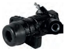
Kupplungsnehmerzylinder. Passend für Renault Alpine 310 (2,7L). Alpine V6 2,9GT. Renault R20, R25, R30. Kolbendurchmesser: 28,6mm. Or. Nr. 7700732756 + 7700588892
