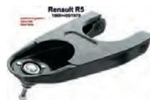
R5, Querlenker Vorderachse, oben links. Passend für Renault R5, von Baujahr 1969 bis 05/1979.
