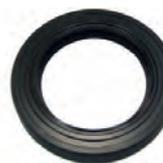
Simmerring Kurbelwelle vorne. Passend für V6 Euromotor (PRV). Peugeot 504 V6. Peugeot 604 V6. Renault Alpine A310 V6, R30 V6. Abmessung: 42 x 62 x 10mm.
