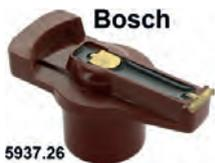
**Bosch**, Verteilerfinger. Passend für Peugeot 504 V6. Peugeot 604. Renault R30. Or. Nr. 593726. Rotorlänge über alles = 67 mm. Rotorhöhe über alles = 33 mm. Wellendurchmesser = 14 mm. Aufstecktiefe = 18 mm.
