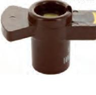
Ducellier, Verteilerfinger. Passend für Citroën DS (Baujahr 04/1966 bis 10/1972), HY, BX, C15, CX, Visa, XM, GS. Peugeot 504, 205, 505, 104. Renault R11, R18, R19, R21, R12. Aufnahme: 10mm Innendurchmesser. Rotorlänge über alles = 48 mm. Rotorhöhe über alles = 31 mm. Aufstecktiefe = 13 mm. Or. Nr. 5937.28. Made in France.
