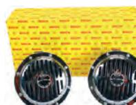
Hupen Set (2 Stück) verchromt, von Bosch. Frequenzen: 325 und 400 Hz. Lautstärke: 118 db(A), Betriebsspannung: 12 V, Leistungsaufnahme: je 48 W, Durchmesser: 156 mm, Einbautiefe: 91 mm, EMV-Schutz: inbegriffen. Universal passend.
