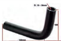
Universal Kühlerschlauch 90° Bogen. Innendurchmesser: 15-16mm. Aussendurchmesser: 25mm. Schenkellänge 130 + 100mm.
