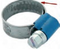
Schlauchschelle 13-20mm, speziell für Kühlerschlauch. Nostalgische Optik. Geprägtes Band mit hochgestellten Kanten. Somit wird ein Verquetschen des Schlauches vermieden. Kleines Schraubgehäuse mit 7mm Sechskantschraube (mit Schlitz). Bandbreite: 9mm. Normale, moderne Schlauchschellen zerquetschen den Schlauch. Das wird mit diesen Schellen komplett vermieden. Und sie sehen auch noch besser aus.
