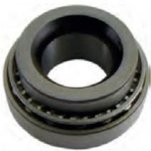
Radlager hinten. Passend für Renault R8, R10, Alpine 110, Floride. Außendurchmesser: 47mm. Innendurchmesser: 21,9mm. Breite: 21,75mm.
