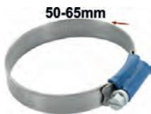
Schlauchschele 50-65mm, speziell für Kühlerschlauch. Nostalgische Optik. Geprägtes Band mit hochgestellten Kanten. Somit wird ein Verquetschen des Schlauches vermieden. Kleines Schraubgehäuse mit 7mm Sechskantschraube (mit Schlitz). Bandbreite: 12mm. Normale, moderne Schlauchschellen zerquetschen den Schlauch. Das wird mit diesen Schellen komplett vermieden. Und sie sehen auch noch besser aus.
