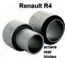
R4, Silentbuchse (2 Stück) für die Lagerung der Hinterachsschwinge (pro Seite). Passend für Renault R4.
