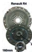
Kupplung komplett. Passend für Renault R4 (852ccm + 1108ccm). 20 Zähne. 160mm Durchmesser. Getriebe 354. Verbaut bis Baujahr 1981 (R1129, R2108, R2370, R2430). R-5 TL (956 cc) >1979. R6 TL (1108cc) von 1969 bis 1980. R8S + R10 (1108cc) von Baujahr 1970 bis 1971.
