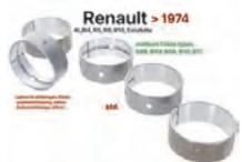
R4/R5/R8/R10/Estafette, Kurbelwellenlager (5 Lager, C = Cleon). Für Kurbelwellen mit 44mm Durchmesser. Standardmaß. Passend für Renault Motoren: 688, 689, 804, 810, 812. Für Motoren bis Baujahr 1974! Ab Baujahr 1975 wurden Kurbelwellen mit 54,8mm Durchmesser verbaut.
