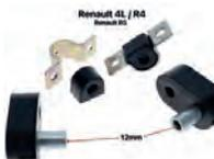
R4, Stabilisator Reparatur Satz, für 12mm Metallhülse. Passend für Renault R4, R5. Inhalt: 2x Schelle, 2x Gummibuchse für Schelle, 2x Aufhängungsgummi außen (Metallhülslänge = 51 mm). Achtung: Die Gummibuchse für die Halterung Stabi an der Karosserie hat immer ca. 15-16mm Durchmesser, die drückt sich erst durch die Verschraubung mit der Halteschelle richtig an.
