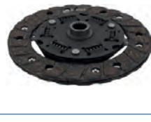
Mitnehmerscheibe, passend für Renault Caravelle, R8. Durchmesser: 160mm. Anzahl Zähne: 20. Nabenprofil: 15,2 x 17,3-20N. Hersteller: Sachs
