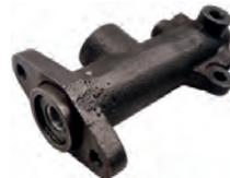
R4/R5/R6, Hauptbremszylinder, passend für Renault R4 bis Fahr.Nr. 1109666 (Fahrzeuge mit vorderer Trommelbremse). Renault R5 0,8L von Baujahr 10/1972 bis 08/1984. Renault R6 von Baujahr 10/1969 bis 04/1980. Kolbendurchmesser: 22mm. Bremsleitungsanschluß: 3x 3/8x24 UNF + 1x stirnseitig 7/16x20 UNF. Der Betätigungskolben hat eine Bohrung mit 11mm Durchmesser und ca. 40mm tief.
