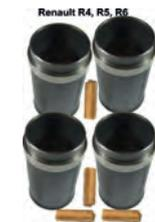
R4/R5, Kolben + Zylinder (4 Stück). Passend für Renault R4 (R1123, R1124, R2104, R2106), von Baujahr 1969 bis 1986. Renault R5L + R6. Motor: 800 B1B, 800 10/ 02 / 03 / 01 / 05. Hubraum: 845ccm. Verdichtung: 8:1. Kolbenbolzen: 16 x 49mm. Kolbenringe 2,0/2,0/3,5. Aussendurchmesser unten: 62,50mm. Aussendurchmesser oben: 69,80mm. Höhe gesamt: 126,0mm. Montage mit Zylinder Papier-Fußdichtung (kein Kupferdichtring)
