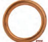
Ölablaßschraubendichtung für 2CV6, BX, XM, 204, 203, 304, 404, 504. Ein + Auslaßschraube. Maß: 16,3x22x2mm. Ausführung C, gewölbt mit einer Dichtung im inneren. (PTFE)
