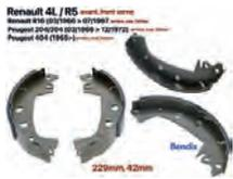
Bremsbacken (1 Satz). Bremssystem: Bendix. Passend für die Vorderachse bei Renault R4, R5. Passend für die Hinterachse für, Renault R16 von Baujahr 06/1965 bis 07/1967. Peugeot Hinterachse: 204/304, von Baujahr 03/1966 bis 12/1972. Peugeot 404, ab Baujahr 1965. Bremstrommeldurchmesser: 229mm. Belagbreite: 42mm. Nachbau.
