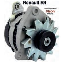
Lichtmaschine (Neuteil) Renault R4 (Motor: Cléon 1108ccm), mit integrierten Lichtmaschinenregler. 12 Volt, 50 Ampere. Einbaulage: 70°. Riemenscheibe: 62mm. 3 x Befestigung (Doppelarm).
