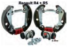
Bremsbacken hinten (Bremsensatz, mit 2x Radbremszylinder + Bremsbacken). Incl. Verstellhebel für die Handbremse. Bremssystem: Bendix. Passend für Renault R4, R5. Kolbendurchmesser: 22mm. Bremstrommeldurchmesser: 180mm. Belagbreite: 32mm. Made in Europe
