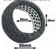
Luftfiltereinsatz für 2CV aus den fünfziger Jahren + Renault R4 aus den sechziger Jahren und vielen Renault mit Heckmotor. Drahtgeflecht rund. Aussendurchmesser: ca. 90mm, Innendurchmesser: 65mm, Höhe: 40mm.
