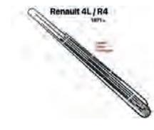
R4, Bremsleitungssatz. Passend für Renault R4, ab Baujahr 1971. 7 Leitungen. "E" Bördel beidseitig. (Trichter). Länge ca.: 15cm, 60cm, 66cm, 81cm, 90cm, 122cm, 273cm. Alle Leitungen haben 3/8 UNF Gewinde. Schlüsselweite 10mm.
