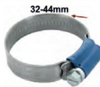
Schlauchschnelle 32-44mm, speziell für Kühlerschlauch. Nostalgische Optik. Geprägtes Band mit hochgestellten Kanten. Somit wird ein Verquetschen des Schlauches vermieden. Kleines Schraubgehäuse mit 7mm Sechskantschraube (mit Schlitz). Bandbreite: 12mm. Normale, moderne Schlauchschnellen zerquetschen den Schlauch. Das wird mit diesen Schnellen komplett vermieden. Und sie sehen auch noch besser aus.
