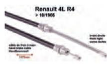
R4, Handbremsseil, vorne rechts. Passend für Renault R4, bis Baujahr 10/1966. Tülle: 1275mm. Gesamtlänge: 1479mm. Or. Nr. 854693200
