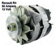
Lichtmaschine Renault R4 (Motor: Billancourt, 845ccm), mit integrierten Lichtmaschinenregler (im Austausch). R6 (845ccm). 12 Volt, 50 Ampere. Einbaulage: 20°. Riemenscheibe: 80mm. 2 x Befestigung. Zuzüglich 100 Euro Altteilstück.
