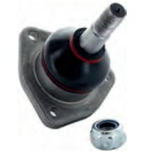
R8/R10/Alpine110, Trag - Führungsgelenk oben. Passend für Renault R8, R10, Alpine A110. Bolzenhöhe bis Anschraubfläche: 77mm. Gewindehöhe: 20mm. Gewindemaß: M12 x 1,25. Or. Nr. 0996006600
