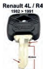
Schlüsselrohling für Zündschloß + Türschloß. Passend für Renault R4, von Baujahr 1982 bis 1991. R4 F4 + F6, bis Baujahr 1994. Für Schlosshersteller: NEIMAN. Bitte beachten Sie den Querschnitt von dem Schlüsselbart. Schaftlänge: 22,4mm. Schaftbreite: 6,9mm.
