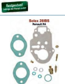
Vergaserreparatursatz Solex 28IBS (incl. Schwimmernadelventil 1.3). Passend für Renault R4.
