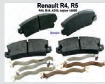
Bremsklötze vorne (1 Satz). Bremssystem: Bendix. Passend für Renault R4, R5, R16, R15, Alpine A310, R12, Alpine 1600S. Breite: 108,9mm. Höhe: 49mm. Dicke: 14,0mm. Nachbau
