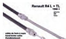
R4, Handbremsseil, links. Passend für Renault R4 L-TL, ab Baujahr 1966. Tülle: 820mm. Gesamtlänge: 1055mm. Or. Nr. 7701348035
