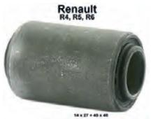
R4/R5/R6, Silentbuchse Vorderachse, für den unteren Dreieckslenker. Passend für Renault R4, R5, R6. Innenmaß: 14 x 27mm. Außenmaß: 45 x 40mm.
