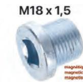
Ölablaßschraube magnetisch (Motor, Peugeot Getriebe, Peugeot Hinterachse). Gewinde: M18 x 1,5mm (Innenvierkant). Passend für alle Motoren. Renault R4. Citroën HY Diesel.
