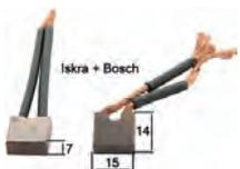
Anlasserkohlen Paris Rhone, für Anlasser Bauserie D8E74, D8E116, D8E99. Passend für Renault R4, R5, R16, Renault mit Heckmotoren. Citroën 2CV, Dyane. Breite: 15mm. Höhe: 14mm. Tiefe: 7mm.
