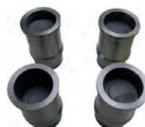
R4/R5, Kolben + Zylinder (4 Stück). Passend für Renault R4 + R5. Motor: 689.10. 956ccm (37 - 44PS). Bohrung: 65mm. Kolbenbolzen: 18 x 57mm. Kolbenringe: 1,75 + 2,0 + 3,5mm. Aussendurchmesser unten: 75,50mm. Aussendurchmesser oben: 85,80mm. Höhe gesamt: 135,0mm
