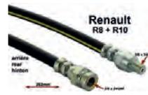
R8/R10, Bremsschlauch hinten. Passend für Renault R8 + R10. Länge: 262mm. Gewinde: 1x Innengewinde 3/8 x 24UNF. 1x Außengewinde 3/8 x 24UNF. Made in Europe.
