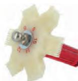
Kühler Kamm (Lamellen Kamm). Mit diesem Werkzeug können die Lamellen von Autokühler, Ölkühler und Wärmetauscher der Heizung geglättet werden. Es gibt 6 verschiedene Aufsätze, sodass für jede Kühlerlamelle das richtige Werkzeug vorhanden ist. Durch ausgerichtete Lamellen ist dann die volle Kühlleistung wieder gegeben!
