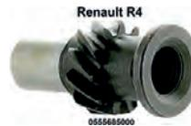
Ölpumpen Antriebswelle (Verteiler Antriebswelle) für Renault R4, R5, R6. Motor B1B + 800. 11 Zähne, innen Feinverzahnt. Für Verteiler mit 1 Spaten. (Die Welle am Verteiler ist flach). Or. Nr. 0555685000
