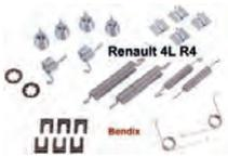
Bremsbacken Montagesatz (vorne). Bremssystem: Bendix. Passend für Renault R4. Für Bremstrommeldurchmesser: 228mm. Belagbreite: 42mm.
