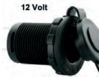
12 Volt Einbau Steckdose zur Nachrüstung (passend für einen Zigarettenanzünder). Einbauöffnung: 29mm. Einbautiefe: 48mm.
