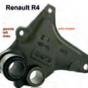
R4, Drehstabaufnahme hinten rechts. Feinverzahnt. Original Renault, kein Nachbau. Passend für Renault R4.
