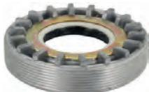
Differentiallager Einstellmutter, mit Simmerring. Passend für Renault R4, R5, R6, R12, R16 ( 4 Gang Getriebe). Aussendurchmesser: 74,0mm. Innendurchmesser: 35,5mm. Bauhöhe: 18,0mm. Or. Nr. 0556231900 + 7700554257
