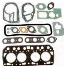
R4/5, Zylinderkopfdichtsatz komplett, inclusive Zylinderkopfdichtung (Original REINZ). Passend für Renault R4, mit 747ccm, 782ccm + 845ccm. Von Baujahr 1962 bis 1989. Renault R5 (845ccm), von Baujahr 10/1972 bis 12/1984. R6 von Baujahr 10/1969 bis 04/1980. Hersteller original REINZ!
