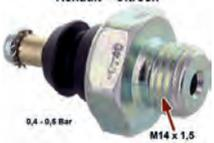
Öldruckschalter. Gewinde: M14 x 1,5. Schaltdruck: 0,5 Bar. Passend für Renault R3 + R4 (747ccm), von Baujahr 1962 bis 1967. Renault Dauphine + Floride. Citroën HY Benziner.
