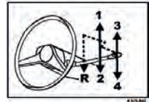
R16, Aufkleber für das Schaltschema (ist an der Windschutzscheibe angebracht). Passend für Renault R16 (erste Modelle). 4 Gang, Rückwärtsgang links.
