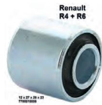
R4/R6, Silentbuchse Vorderachse, für den oberen Dreieckslenker. Passend für Renault R4 + R6. Innenmaß 12 x 27. Außenmaß: 26 x 23mm.
