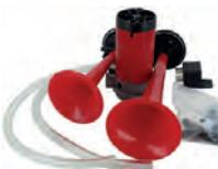
Hupe (Horn, 12 Volt), komplett mit Luftkompressor + 2 x Drucklufthorn, Relais und Luftschläuche. 750 + 800Hz (2 verschiedene Töne). 115dB(A). Länge der Lufthörner: 210 + 165mm. Länge des Luftkompressors: ca. 105mm.
