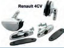
4CV, Scharniere oben (verchromt) für die Dreiecksfenster (1 Satz, links + rechts). Passend für Renault 4CV.
