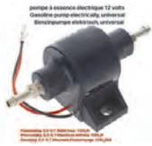
Benzinpumpe elektrisch, universal einsetzbar, nur für Vergasermotoren! 12 Volt. Diese Pumpe lässt sich sehr einfach anschrauben. Optimal für Fahrzeuge, Boote, Trecker und alle anderen Maschinen. Druck/kg: 0,5-0,7. Maximale Fördermenge: 130L/Std. Die Pumpe kann für Benzin, Diesel, Ethanol + Metanol benutzt werden. Anschlüsse: Standard 6mm Schlauchnippel.
