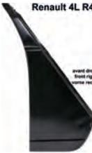
R4, Seitenwandblech vorne rechts (zwischen A-Säule und Kotflügel). Passend für Renault R4. Gute Qualität
