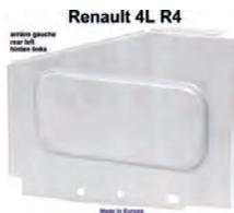
R4, Verschlussblech hinten rechts, für den Längsholm. Passend für Renault R4. Made in Europe.
