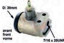
Estafette, Radbremszylinder vorne. 1 Kolben (30mm). Bremsleitungsanschluß: 7/16 x 20 UNF. Passend für Renault Estafette, ab Baujahr 1962. Ankerplattenbohrung 22mm. Länge über alles 65mm.
