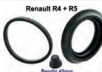
R4/R5, Bremssattel Dichtsatz. Bremssystem: Bendix. Passend für Renault R4 + R5. Kolbendurchmesser: 45mm. Die Staubmanschette ist ca. 7mm hoch.
