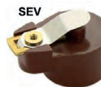
SEV, Verteilerfinger SEV 466. Passend für Citroën 11CV, ab Baujahr 1942. Citroën HY. Peugeot 202, Peugeot 203 ab Baujahr 1949. Peugeot 403, ab Baujahr 1955. Peugeot 404, ab Baujahr 1960. Renault R4, Fregate, Juva, Dauphine, Floride. Simca 8, Aronde, Ariane. Passende Verteilerkappe: 72182
