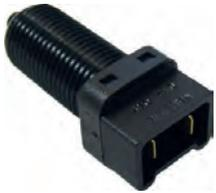
Bremslichtschalter, 2 polig. Gewinde: M16 x 1,5. Passend für Renault R4, R5, R16.
