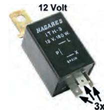
Blinkerrelais, 12 Volt, 3 polig. 180 Watt Ausgangsleistung. Passend für Citroën 2CV, DS, HY, Renault R4, Peugeot 203, 403, 404 usw.. Das Blinkerrelais macht keine "Klick-Klick" Geräusche. Steckerbelegung französisch: Stromversorgung Symbol (+). Anschluß Blinker vorne + hinten = Symbol (C). Anschluß Kontrollleuchte Armaturenbrett = Symbol (R). Falls ein japanisches Relais benutzt wird: Plus + = Symbol X oder B. Anschluß Blinker C = Symbol L. Anschluß Kontrolle R = Symbol P.
