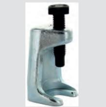
Spurstangen + Spurstangenkopfabzieher, geschmiedet. Passend für Citroën 2CV, DS, 11CV, 15CV. Renault R4, R5. Peugeot 404 usw. Spannungsbereich 16-18mm. Öffnung 19mm!
