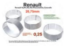
R4/R5/R8/R10/Estafette/Caravelle, Pleuellagersatz. Breite: 20,75mm. 1 Übermaß (+0,25). Passend für Renault Motoren (5 Kurbelwellenlager, Cleon) mit 54,8mm + 44mm Durchmesser. Motoren: 688 172 / 688.1 / 688.01 bis Baujahr 1975 (1108cc). Alle anderen Motoren 689 710 / C1C 700 (956cc) + 688 711 + 713. C1E 700, 754, 715, 720, 750 (1108cc). 813-02 (852cc), 688, 689, 805, 810, 812. Diese Motoren waren z.B. verbaut in Renault R4, R4F4, R4F6
