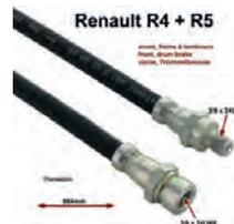
R4/R5, Bremsschlauch vorne. Passend für Renault R4, ab Baujahr 1976 (Trommelbremse). Renault R5. Länge: 506mm. Gewinde: 1x Außengewinde 3/8 x 24UNF. 1x Innengewinde 3/8 x 24UNF. Or. Nr. 7701000239. Made in Europe.
