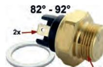
Temperaturschalter Kühlwasser. 92°-82°. Gewinde: M22. 2x elektrischer Anschluss. Passend für Peugeot 204, 504, 505, 604. Renault R4, R5, R6, R16, R20. Or. Nr. Peugeot: 1810.14
