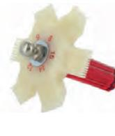
Kühler Kamm (Lamellen Kamm). Mit diesem Werkzeug können die Lamellen von Autokühler, Ölkühler und Wärmetauscher der Heizung geglättet werden. Es gibt 6 verschiedene Aufsätze, sodass für jede Kühlerlamelle das richtige Werkzeug vorhanden ist. Durch ausgerichtete Lamellen ist dann die volle Kühlleistung wieder gegeben!
