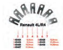
R4, Lenkgetriebe Einstellscheiben Satz (7 Stück). Maß von 8,9 bis 14,99mm. Mit diesem Kit, ist immer die richtige Scheibe dabei. Diese Einstellscheiben sind für die korrekte Ausrichtung des Lenkgetriebes (damit es nicht zu Verspannungen kommt). Siehe im Werkstatthandbuch! Es gibt 7 verschiedene Einstellscheiben! Passend für Renault R4. Or. Nr. 7700555563 bis 7700555569
