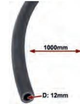
Kühlerschlauch universal. Innendurchmesser: 12,0-13,0mm. Aussendurchmesser: 19,0-22,0mm. Länge: 1000mm.
