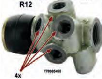
R4/R16/R12, Bremskraftregler. 4x 3/8x24UNF Bremsleitungsanschlüsse. Passend für Renault R4, von Baujahr 1976 bis 1986. Renault R16 TL, von Baujahr 01/1971 bis 12/1976. Renault R5, Renault R12. Or. Nr. 770685455. Achtung, es gibt auch Fahrzeuge mit 3x 3/8 + 1x 7/16 Anschluss. Für diese Zwecke haben wir einen passenden Adapter (84372) im Lieferprogramm.
