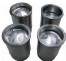
R8 Gordini, Kolben + Zylinder (4 Stück). Passend für Renault R8 Gordini. Hubraum: 1255cc. Bohrung: 74,50mm. Kolbenbolzen: 20 x 63,5mm. Kolbenringe: 1,75 + 2 + 4,0mm. Aussendurchmesser unten: 80,0mm. Aussendurchmesser oben: 89,75mm. Höhe gesamt: 128,0mm.
