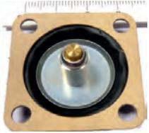
Membrane Beschleunigerpumpe, für Vergaser Solex 32 TMIMA, 32 TACIC, 32/35 TACIC, 32 BIS, 32/35 SEIFA, 35/35 TMIMA, 28/35 CICSA. Passend für Renault R5, R14, R9. Peugeot 504, 305, 104. Citroën BX 14E-RE. .
