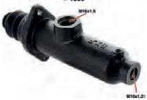
4CV, Hauptbremszylinder, passend für Renault 4CV, bis Baujahr 02/1956. Anschluß: M10 x 1,25. Made in Spain.
