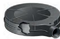
Luftfilter komplett, passend für Renault R4. Komplett mit Kunststoffgehäuse. Aussendurchmesser: 320mm, Innendurchmesser: 260mm. Höhe: 87mm. Innendurchmesser für den Anschluß auf dem Vergaser: ca. 38mm.
