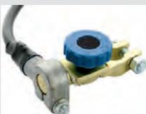
Batteriepol - Trennschalter gerade. Einfach die Rändelschraube lösen und der gesamte Stromkreis im Auto ist unterbrochen. Optimal für eine längere Nichtbenutzung des PKW. (Winterruhe). Einfacher geht es nicht! Die Minusklemme an der Batterie wird durch diesen trennbaren Pol ersetzt! (die Minusklemme die an der Batterie gesessen hat, wird nun einfach auf den Polanschluß des Trennschalters gesteckt). Umbauzeit ca. 1 Minute!
