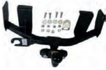
Anhängerkupplung, passend für Renault R4, ab Baujahr 1963. Mit EC E6 Zulassung! Zulässiger D Wert = 4,58KN (Max. Stützlast = 55kg. Max. Anhängergewicht gebremst = 750kg). Die genauen Anhängerdaten entnehmen Sie bitte Ihren Zulassungspapieren! Passend für alle Auspuffvarianten. Die Anhängerkupplung ist nur 62cm breit und wird an der Innenseite der Längsträger montiert!
