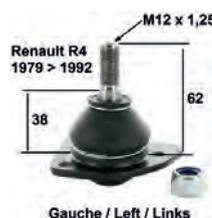
R4/R5, Trag - Führungsgelenk unten links. Passend für Renault R4 + R5. Verbaut von Baujahr 1979 bis 1992. Bolzenhöhe bis Anschraubfläche: 62mm. Gewindehöhe: 19mm. Gewindemaß: M12 x 1,25.
