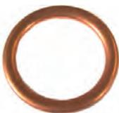
Ölablaßschraubendichtung 18 x 24 x 2mm (für M18 Gewinde). Passend für Peugeot 203, 403, 404, 504, 505, J7 (alle Motoren). Renault R4. Citroën HY. Ölkühlerverschraubung 2CV mit 16PS!
