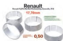
R4/R5/R8/R10/Estafette/Caravelle/R16, Pleuellagersatz. Breite: 17,70mm. 0,50 Übermaß. Passend für Renault Motoren (5 Kurbelwellenlager, Cleon) mit 54,8mm + 44mm Durchmesser. Motoren: 688 192 + 688.1 (1108ccm). Motor 810.01 bis 810.29 (1289ccm). 810.96 + 810.97 (1289ccm). 810 725, 810 726, 840 730, C2J 713, 8347 725... C1G + C1J (1397ccm). Renault R4 (selten). Renault R5, R10, Estafette, R16 (alle),.....
