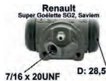
SG2, Radbremszylinder hinten rechts. Passend für Renault SG2 (Renault Super Goélette SG2, Saviem), von Baujahr 1965 bis Ende der Serie. Kolbendurchmesser: 28,57mm. Baulänge 78 mm. Bremsleitungsanschluß: 7/16 x 24 UNF. Made in France
