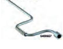
4CV, Motor Andrehkurbel. Passend für Renault 4CV (nur Fahrzeuge mit Sternfelge), von Baujahr 1947 bis 1958. Die Kurbel kann aber auch für andere Renault verwendet werden (z.B R10). Or. Nr. 5400657
