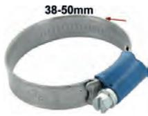
Schlauchschele 38-50mm, speziell für Kühlerschlauch. Nostalgische Optik. Geprägtes Band mit hochgestellten Kanten. Somit wird ein Verquetschen des Schlauches vermieden. Kleines Schraubgehäuse mit 7mm Sechskantschraube (mit Schlitz). Bandbreite: 12mm. Normale, moderne Schlauchschellen zerquetschen den Schlauch. Das wird mit diesen Schellen komplett vermieden. Und sie sehen auch noch besser aus.
