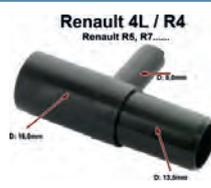
Motorentlüftung T-Verbinder (Reduzierung). Passend für viele Renault Modelle (R4, R5, R7....). Anschlüssen Außendurchmesser: 16,0 + 13,5 + 8,0mm. Das T-Stück wird oben am Vergaser Rand auf den Stutzen geschoben (verbaut).
