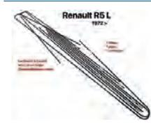
R5, Bremsleitungssatz. Passend für Renault R5L, mit vorderen Trommelbremsen, ab Baujahr 1972. 7 Leitungen. "E" Bördel alle Leitungen. (Trichter). Länge ca.: 48cm, 60cm, 65cm, 68cm, 73cm, 208cm, 300cm. Alle Leitungen haben 3/8 UNF Gewinde. Schlüsselweite 10mm.
