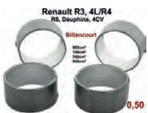
R4/4CV/Dauphine/R5, Pleuellagersatz. Breite 21,16mm. 2 Übermaß (+0,50). Passend für Renault Motoren: 662, 690, 680 702, 839 706, 670, 800 710. (603cc, 748cc, 782cc, 845cc). Verbaut von Baujahr 1951 bis 12/1985. Für Pleuelzapfen: 37,50mm. Passend für R4, R5, 4CV, Dauphine, Dauphinoise, Juvaquatre, R5 (782cm<sup>3</sup>), Floride, Estafette (747cm<sup>3</sup>)
