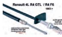
R4, Handbremsseil, vorne links. Passend für Renault 4 GTL, vorne links + Renault R4 F6 (ab Baujahr 1983) hinten links. Tülle: 920mm. Gesamtlänge: 1040mm. Or. Nr. 7701348267
