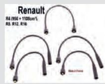
Zündkabelsatz, passend für Renault R4 (956 + 1108cc). R16 alle Modelle. R8 (980 + 1108cc). R12 (1,3L). R15 (1,3L). Matra Bagheera (1,3-1,4L). Talbot Murena (1,6L). Simca Sunbeam (alle Modelle). Zündkabelängen: 325mm, 325mm, 400mm, 425mm. Kabellänge Zündspule zu Verteilerkappe: 470mm. Made in France.
