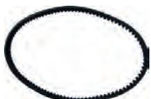
Keilriemen 10x667. Passend für Renault R4 (Motor C1C, C1E + 688, 956-1108ccm) für die Wasserpumpe. Citroën CX. Länge: 667mm.
