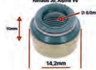
Ventilschaftdichtung (per Stück). Passend für Peugeot 504 V6. Renault R30 V6, Alpine V6. Innendurchmesser: 8,00mm. Aussendurchmesser: 14,2mm. Höhe: 10mm.
