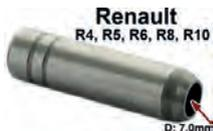
Ventilführung Einlass + Auslass. Passend für Renault R4, R5, R6, R8, R10. Innendurchmesser: 7,0mm. Aussendurchmesser: 11,15mm. Länge: 41,4mm.
