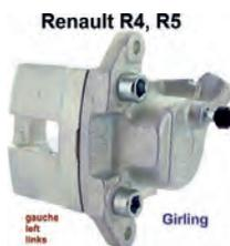
R4/R5, Bremssattel, vorne links (Neuteil). Bremssystem: Lucas-Girling. Passend für Renault R4 + R5. Kolbendurchmesser: 45mm. Or. Nr. 7701201168. Zuzüglich Altteilverkauf 150 Euro.
