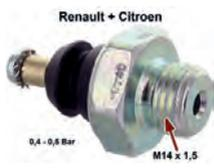
Öldruckschalter. Gewinde: M14 x 1,5. Schaltdruck: 0,5 Bar. Passend für Renault R3 + R4 (747ccm), von Baujahr 1962 bis 1967. Renault Dauphine + Floride. Citroën HY Benziner.
