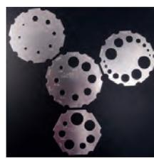
Gewindelehren, in einer neuen, simplen Form. Bestehend aus 4 Lehren aus Aluminium. Ermittlung von Durchmesser und Gewindesteigung, metrisch und zöllig imperial + US. Von Durchmesser 2,5-22mm (5/16>3/4). Gewindesteigung pitch 0,45 - 2,5mm. Da hat doch mal jemand eine wirklich gute Idee gehabt.
