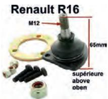
R16, Trag - Führungsgelenk oben, für Renault R16, ab Baujahr 9/1968. (R1151, 1152, 1153, 1154, 1156, 1157). Links + rechts passend. Bolzenhöhe bis Anschraubfläche: 65mm. Gewindehöhe: 18mm. Gewindemaß: M12 x 1,25. Or. Nr. 7701451902. Made in Italy
