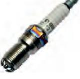
Zündkerze RC72LJS-2. Durchmesser 14mm, Schlüsselweite 16mm. 2 Elektroden! Alpine V6 2.5+2.9 Turbo, BX 16+19, CX 2200, 22TRS, Visa 14GT+16GTI, Peugeot 205GTI, P505 2.0TI, P505 2.2, Renault Espave 2.0+2.2 >1990, R21. Gewinde: M14 x 1,25 x 16mm. Konus. Schlüsselweite 16mm.
