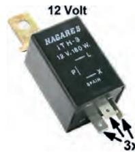
Blinkrelais, 12 Volt, 3 polig. 180 Watt Ausgangsleistung. Passend für Citroën 2CV, DS, HY, Renault R4, Peugeot 203, 403, 404 usw.. Das Blinkrelais macht keine "Klick-Klick" Geräusche. Steckerbelegung französisch: Stromversorgung Symbol (+). Anschluß Blinker vorne + hinten = Symbol (C). Anschluß Kontrollleuchte Armaturenbrett = Symbol (R). Falls ein japanisches Relais benutzt wird: Plus + = Symbol X oder B. Anschluß Blinker C = Symbol L. Anschluß Kontrolle R = Symbol P.
