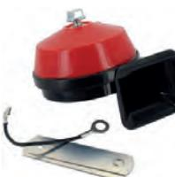
Hupe (Trompete) 12 Volt, hoher Ton. 480Hz, 108dB(A). Sehr hochwertige Hupe, made in der EU. Die Hupe ist aus Metall mit einer Abdeckung (Trompete) aus rotem Kunststoff! Universal passend. Durchmesser: ca. 110mm. ECE geprüft.
