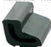
bûlée capot moteur rubber bumper bonnet Gummipuffer Motorhaube
