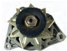
Lichtmaschine Renault R5, von Baujahr 1972 bis 1985. Renault R16, verschiedene Baujahre. Externer Lichtmaschinenregler. 12 Volt. 40 Ampere. Einbaulage: 60°. Befestigungslöcher: 10mm. Zuzüglich Altteilstück 75 Euro.
