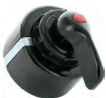
Blinkerschalter mechanisch, für den Einbau. Passend für Citroën 11CV + universal einsetzbar. Der Blinkerhebel hat ein integrierte Kontrollleuchte. Passende Glühlampe: 14425 /(12V) + 14282 (6V). Sockel = BA7s. Einsetzen der Glühlampe: Hebel erst herunterdrücken, Hebel heruntergedrückt nach links drehen, dann Hebel herausziehen und Glühlampe einsetzen!
