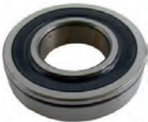
Radlager vorne. Passend für Renault R16, R12, R15. Außendurchmesser: 72mm. Innendurchmesser: 35mm. Breite: 17mm. Or. Nr. 7703090037
