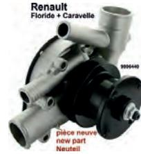
Dauphine/Floride, Wasserpumpe Renault Floride, Dauphine. Neuteil. Or.Nr.9806440. Achtung: Die Floride + Dauphine haben ein offenes Kühlsystem, unbedingt darauf achten dass der richtige Kühlerdeckel ohne Dichtung montiert ist. Die Wasserpumpe hat eine Leckbohrung, wo etwas Wasser austreten kann. Neue Wasserpumpen benötigen ca. 500 bis 1000km, bis sie richtig eingelaufen sind und zu 99,5% abdichten. Etwas tropfen ist normal!
