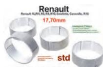
R4/R5/R8/R10/Estafette/Caravelle/R16, Pleuellagersatz. Breite: 17,70mm. Standardmaß. Passend für Renault Motoren (5 Kurbelwellenlager, Cleon) mit 54,8mm + 44mm Durchmesser. Motoren: 688 192 + 688.1 (1108ccm). Motor 810.01 bis 810.29 (1289ccm). 810.96 + 810.97 (1289ccm). 810 725, 810 726, 840 730, C2J 713, 8347 725... C1G + C1J (1397ccm). Renault R4 (selten). Renault R5, R10, Estafette, R16 (alle),.....
