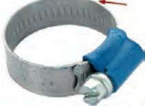
Schlauchschelle 22-32mm, speziell für Kühlerschlauch. Nostalgische Optik. Geprägtes Band mit hochgestellten Kanten. Somit wird ein Verquetschen des Schlauches vermieden. Kleines Schraubgehäuse mit 7mm Sechskantschraube (mit Schlitz). Bandbreite: 12mm. Normale, moderne Schlauchschellen zerquetschen den Schlauch. Das wird mit diesen Schellen komplett vermieden. Und sie sehen auch noch besser aus.
