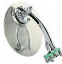
Spiegel zum anklammern an der Tür. Komplett aus Metall angefertigt. Typischer Türspiegel, wie er sehr oft in 40iger und 50iger Jahre verbaut wurde. Durchmesser: ca. 95mm.
