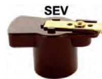
SEV, Verteilerfinger. Passend für Renault R4, Heckmotor. Peugeot 203, 403, 404. Citroën DS, Citroën HY. Or.Nr.8556679. Länge über alles: 50mm. Höhe über alles: 25mm. Innendurchmesser 14mm.
