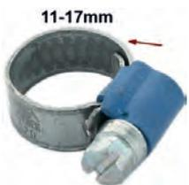
Schlauchschnelle 11-17mm, speziell für Kühlerschlauch. Nostalgische Optik. Geprägtes Band mit hochgestellten Kanten. Somit wird ein Verquetschen des Schlauches vermieden. Kleines Schraubgehäuse mit 7mm Sechskantschraube (mit Schlitz). Bandbreite: 9mm. Normale, moderne Schlauchschnellen zerquetschen den Schlauch. Das wird mit diesen Schnellen komplett vermieden. Und sie sehen auch noch besser aus.
