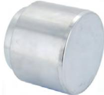
A 310, Kolben für Bremsattel, vorne + hinten. Bremssystem Bendix. Durchmesser: 54mm. Gesamthöhe: 47mm. Höhe der Lauffläche: 39mm. Kolbennut: 2mm. Kolben-Bund: 6mm. Passend für Renault Alpine A310 V6.
