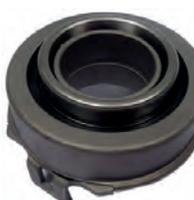
Kupplung Ausrücklager, passend für Renault R16, R18, R20, Fuego. Innendurchmesser: 30/43mm. Aussendurchmesser: ca. 68,5mm. Bauhöhe: 27,5mm.
