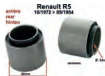
R5, Silentbuchse (2 Stück) für die Hinterachse (innen). Passend für Renault R5 (1 Serie), von Baujahr 10/1972 bis 09/1984. R6 von Baujahr 10/1969 bis 04/1980. Innendurchmesser: 34mm. Außendurchmesser: 50,0mm. Länge innen: 45,0mm. Länge außen: 39,50mm. Or. Nr. 0855599000
