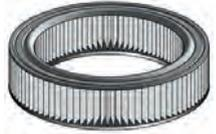
Luftfilter. Passend für Renault R5 (R1221, 1220, 1225, 1391, 1392, 1395, 2381, 2382), bis Baujahr 09/1984. Aussendurchmesser: 220mm. Innendurchmesser: 141mm. Höhe: 46mm. Or. Nr. 7701013347 + 7701019264
