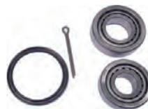
Radlagersatz hinten. Passend für Renault R4, R6, R16. Abmessung Lager 1: Außendurchmesser: 47mm. Innendurchmesser: 19,80mm. Breite 12,00mm. Abmessung Lager 2: Außendurchmesser 52mm. Innendurchmesser: 25mm. Breite 13,00mm.
