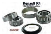
Radlagersatz hinten. Passend für Renault R4, von Baujahr 09/1962 bis 06/1986. R5 von 01/1972 bis 06/1984. R6 von 10/1968 bis 04/1980. Abmessung Lager 1: 40 x 17 x 13,25mm. Lager 2: 47 x 22 x 20,75mm. Made in Spain
