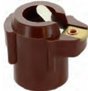
Ducellier, Verteilerfinger (kleine Ausführung). Passend für Renault 4CV, Dauphine, Floride, R5, Estafette. Rotorlänge: 18,0mm. Rotorhöhe: 26mm. Wellendurchmesser: 14,0mm. Aufstecktiefe: 15,0mm. Or. Nr. 08 54 720 000. Made in France.
