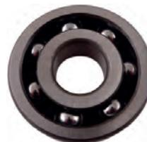
Radlager hinten. Passend für Renault R8, R10, Alpine 110, Dauphine, Caravelle. Das Lager ist auf der Steckachse montiert. Auf die Steckachse wird dann der Radteller geschoben. Aussendurchmesser: 68,0mm. Innendurchmesser: 25,0mm. Bauhöhe: 19,0mm. Or. Nr. 0852914400. Made in Spain
