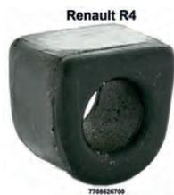
R4, Stabilisatorgummi (per Stück). Passend für Renault R4. Befestigung des Stabilisator an der Karosserie! Achtung, die Gummis haben 12mm Innendurchmesser.
