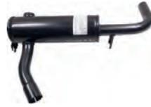
R16, R1156. Vorschalldämpfer (erster Schalldämpfer), passend für Renault R16 TX, TXA, verbaut ab Baujahr 1976 1x Anschluss Innendurchmesser 45,5mm. 1x Anschluss Aussendurchmesser 45mm. Or. Nr. 7700621231
