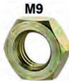
M9, Mutter M9x1,25. Niedrige (flache) Ausführung. Höhe: 5mm. Z.B für die Ventildeckelverschraubung bei dem 11CV mit D-Motor. Or. No. 2372-S
