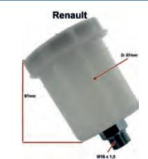
**Renault R4/Heckmotor, Bremsflüssigkeitsbehälter** mit Verschlussdeckel. Passend für viele Renault. Durchmesser: 57mm. Behälterhöhe mit Verschlussdeckel: 97mm. Gewindeanschluß auf dem Hauptbremszylinder: M16 x 1,5.
