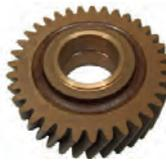
R4/R3, Stirnrad (Zwischenrad) Novotex. Passend für Renault R3 + R4. 35 Zähne. Innendurchmesser: 35,75mm. Außendurchmesser: 100,06mm.
