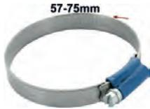
Schlauchschele 57-75mm, speziell für Kühlerschlauch. Nostalgische Optik. Geprägtes Band mit hochgestellten Kanten. Somit wird ein Verquetschen des Schlauches vermieden. Kleines Schraubgehäuse mit 7mm Sechskantschraube (mit Schlitz). Bandbreite: 12mm. Normale, moderne Schlauchschellen zerquetschen den Schlauch. Das wird mit diesen Schellen komplett vermieden. Und sie sehen auch noch besser aus.
