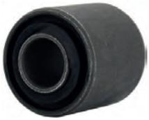
4CV/Dauphine/Florie, Silentbuchse für den Querlenker. Passend für Renault 4CV, Dauphine, Floride. Abmessung: ca. 16 x 36 x 35mm. Per Stück. Or. Nr. 8535734
