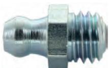
Schmiernippel M8 x 1,25. (Kegelschmiernippel H1, gerade). Schlüsselweite: 9,0mm.
