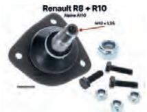
R8/R10/Alpine110, Trag - Führungsgelenk unten. Passend für Renault R8, R10, Alpine A110. Bolzenhöhe bis Anschraubfläche: 65mm. Gewindehöhe: 19mm. Gewindemaß: M12 x 1,25. Or. Nr. 0996006500
