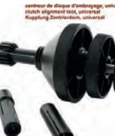
Kupplung Zentrierdorn universal (einstellbar). Einsetzbar für Schwungscheiben mit und ohne Pilotlager. Zentrierdorn passt von 14 > 28mm und der Konus für Druckplatte von 35 > 67mm (also nahezu alle klassischen Franzosen)
