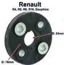
Hardyscheibe für die Lenksäule. Passend für Renault R4, R5, R8, R16, R18, Dauphine. Außendurchmesser: 76mm. Innendurchmesser: 24mm. Lockkreis: ca. 50mm.
