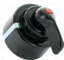
Blinkerschalter mechanisch, für den Einbau. Passend für Citroën 11CV + universal einsetzbar. Der Blinkerhebel hat ein integrierte Kontrollleuchte. Passende Glühlampe: 14425 /(12V) + 14282 (6V). Sockel = BA7s. Einsetzen der Glühlampe: Hebel erst herunterdrücken, Hebel heruntergedrückt nach links drehen, dann Hebel herausziehen und Glühlampe einsetzen!
