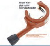
Auspuff Rohrabschneider, für 28 bis 67mm Durchmesser. Der Rohrabschneider hat eine Ratschenfunktion. Schnitttiefe bis 3mm.
