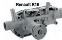
R16/A310, Wasserpumpe. Passend für Renault R16 (alle Modelle). Alpine A310 (4 Zylinder). Dreieckige Halterung der Riemenscheibe. Lochabstand: 30mm.
