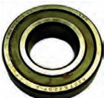
Radlager vorne. Passend für Renault R16, R12, R15. Außendurchmesser: 72mm. Innendurchmesser: 35mm. Breite: 21mm. Or. Nr. 7701460638
