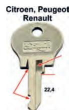
Schlüsselrohling für Zündschloß + Türschloß. Passend für Peugeot 104. 204 ab 1965. 304 ab 1969. 404 ab 1965. 504 von 1975 bis 1983. 604 von 1975 bis 1980. 104 ab 1972. Renault R4, ab Baujahr 1961 bis 1981. Citroën LN + VISA. Für Schlosshersteller: NEIMAN. Bitte beachten Sie den Querschnitt von dem Schlüsselbart. Schaftlänge: 22,4mm. Schaftbreite: 7,0mm.
