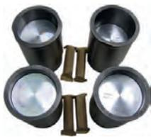
R5/R10/R12/R15, Kolben + Zylinder (4 Stück). Renault Motor 810 (1289ccm). Passend für Renault R5LS, TS, GTL. R5 Alpine. R10-1300. R12TS, LN, TR. R15TL, GTL. Bohrung: 73mm. Kolbenbolzen: 20 x 62. Kolbenringe: 1,75 + 2 + 4,0mm. Verdichtung: 9,5:1. Aussendurchmesser unten: 78,41mm. Aussendurchmesser oben: 87,78mm. Höhe gesamt: 134,0mm.
