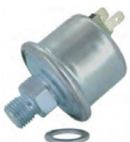
Öldrucksensor. Messbereich 0 bis 6 Bar + Festschaltdruck 0,60. Gewinde M14 x 1,5. Passend für Renault R5, alle Motoren (auch Alpine).
