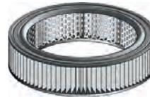
Luftfilter - Einsatz. Passend für Renault R16 (1,6l), 55 + 65PS. Außendurchmesser: 250mm. Innendurchmesser: 192mm. Höhe: 60mm.
