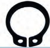
R4, Lager für Keilriemenspannrolle, Sicherungsring klein für das Lager. Größe: 14mm. Der Sicherungsring wird 2x pro Lager benötigt.
