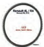
R4/R5/R12, Zahnkranz Schwungscheibe. 117 Zähne. Passend für Renault R4, R5, R12. Innendurchmesser: 22,2cm. Aussendurchmesser: 24,7cm. Dicke: 0,8cm.
