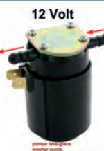
Scheibenwaschpumpe, elektrisch, Farbe schwarz. Passend für Citroën DS. Diese Pumpe ist auch super für die Nachrüstung zu verwenden, zB. 2CV, Dyane, Peugeot, Renault. Achtung: Die Pumpe ist nicht selbstansaugend. Das Wasser muss von alleine hinein laufen. Ausgang Wasser = Stromanschluß Seite. Läuft die Pumpe mehr als 15 Sekunden ohne Wasser, geht sie kaputt.
