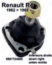
R4, Trag - Führungsgelenk unten rechts. Passend für Renault R4, von Baujahr 1962 bis 1968. Or. Nr. 0981724600. Made in Italy. Gewindemaß: M12. Der Konus verjüngt sich von 12,5 auf 14mm. Baulänge bis Innenseite der Anschraubfläche: 47mm. Baulänge bis Außenseite Anschraubfläche: 52mm.
