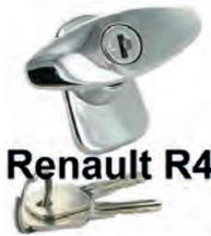
R4, Kofferraumschloss (Heckklappenschloss, Griff) außen, verchromt. Passend für Renault R4.
