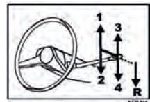
R16, Aufkleber für das Schaltschema (ist an der Windschutzscheibe angebracht). Passend für Renault R16. 4 Gang, Rückwärtsgang rechts.
