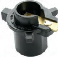
Ducellier, Verteilerfinger, Original Hersteller. Passend für Citroën DS ab Baujahr 9/1972, CX bis 1980, HY. Renault R4GTL, R5, R16. Peugeot 204, 304S, 404, 504. Ausführung D216. Länge über alles: 46mm. Höhe über alles: 36mm. Innendurchmesser: 15mm. Made in France.
