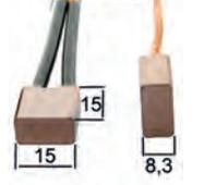
Anlasserkohlen, Ducellier (Typ 6215A), 2 Stück. Passend für Renault R4 (Anlasser mit 2 Befestigungen) + Citroën DS. Abmessung Koghen: 15,0 x 8,3 x 15,0mm. Abmessung der Buchsen: Aussendurchmesser 15mm. Innendurchmesser: 12mm. Länge: 15mm.
