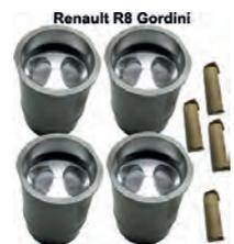
R8 Gordini, Kolben + Zylinder (4 Stück). Passend für Renault R8 Gordini. Motor: 812. Hubraum: 1296ccm. Bohrung: 75,7mm. Kolbenbolzen: 20 x 63,5mm. Kolbenringe: 1,75 + 2 + 4,0mm. Aussendurchmesser unten: 80,0mm. Aussendurchmesser oben: 89,75mm. Höhe gesamt: 128,0mm.
