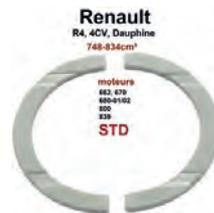
R4/4CV/Dauphine/R5, Kurbelwelle Anlaufscheibe (Axialspiel), Standardmaß. Abmessung: Innendurchmesser 44mm, Außendurchmesser 55,6mm, 2mm dick. Passend für Renault Motor: 662, 680 702, 690, 839 706, 670, 800,B1B, 800 70. Hubraum 603cc, 748cc, 782cc, 845cc. Passend für Renault R4, 4CV, Dauphine, Dauphinoise, Juvaquatre, R5 (782cm<sup>3</sup>), Floride
