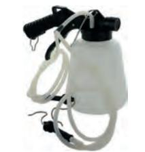
Bremsen Entlüftungs-Gerät! Arbeitsdruck 5-8 bar, max. Unterdruck 60%, Kapazität 1L. Druckluft-Anschluss 1/4 Zoll. Es ist vom Prinzip eine Druckbecherpistole, welche an dem Kompressor angeschlossen wird. An dem Behälter ist ein Schlauch welcher auf den Entlüfternippel kommt. Wenn man jetzt diese Pistole betätigt, entsteht im Behälter ein Unterdruck, welcher über den Schlauch dann an dem Entlüfternippel an steht. Somit sammelt sich die Bremsflüssigkeit im Becher des Gerätes.
