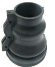
Abdichtgummi (Manschette) für das Achsrohr am Getriebe. Passend für Renault Caravelle, Floride, R8, R10. Innendurchmesser: 50 + 95mm. Länge über alles: 125mm.
