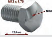
Radkappen Schraube. Passend für Renault R4, 4CV, Dauphine, Floride, Fregate. Gewinde: M12 x 1,75. Länge: 22mm. Werkzeug: 19mm
