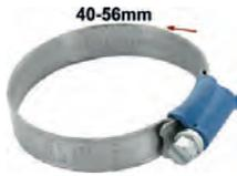
Schlauchschele 40-56mm, speziell für Kühlerschlauch. Nostalgische Optik. Geprägtes Band mit hochgestellten Kanten. Somit wird ein Verquetschen des Schlauches vermieden. Kleines Schraubgehäuse mit 7mm Sechskantschraube (mit Schlitz). Bandbreite: 12mm. Normale, moderne Schlauchschellen zerquetschen den Schlauch. Das wird mit diesen Schellen komplett vermieden. Und sie sehen auch noch besser aus.
