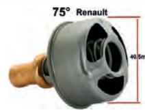
Thermostat 75°. Passend für Renault R4, R16, Heckmotoren. Alte Version. Durchmesser: 40,5mm. Höhe: 21mm. Gesamthöhe: 62mm.
