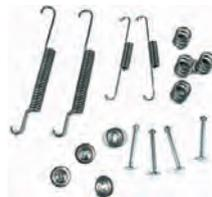
Bremsbacken Montagesatz (hinten). Bremssystem: Lucas-Girling. Passend für Renault R4, R5.
