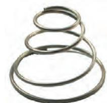
Feder, für die Montage unter der Rosette der Fensterkurbel und, oder Türgriff. Durchmesser: 40mm. Passend für Citroën 11CV. Diese Feder kann aber auch universal eingesetzt werden. (Peugeot, Renault, Citroën usw.) Or. Nr.133841
