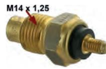
Temperaturschalter für die Kühlwasser Warnlampe. Gewinde: M14x1,25. Passend für Peugeot 304, 305, 604 (2,3TD), J7 (Benzin + Diesel), J5. Citroën C25. Renault Fuego, R9, R11, R18
