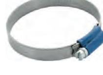
Schlauchschelle 57-75mm, speziell für Kühlerschlauch. Nostalgische Optik. Geprägtes Band mit hochgestellten Kanten. Somit wird ein Verquetschen des Schlauches vermieden. Kleines Schraubgehäuse mit 7mm Sechskantschraube (mit Schlitz). Bandbreite: 12mm. Normale, moderne Schlauchschellen zerquetschen den Schlauch. Das wird mit diesen Schellen komplett vermieden. Und sie sehen auch noch besser aus.
