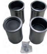
Dauphine, Kolben + Zylinder (4 Stück). Passend für Renault Dauphine. Motor: 1093ccm. Bohrung: 60mm. Kolbenbolzen Durchmesser: 14mm. Aussendurchmesser unten: 62,4mm. Aussendurchmesser oben: 72,8mm. Höhe gesamt: 121,0mm.
