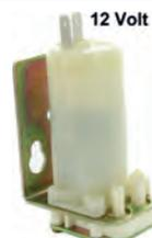
Scheibenwaschpumpe elektrisch. 12 Volt. Sehr stabile Ausführung mit verzinkter Metallhalterung. 2x Flachstecker, Anschluß von oben! Made in der EU. Die Abbildung zeigt die richtige Einbaulage. Der Pumpenteil ist unten, der Elektromotor oben! Bitte so herum einbauen. Ansonsten zieht die Pumpe nur Luft.
