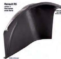
R5, Federbeinblech hinten rechts, Renault R5, 1 Serie. Nachfertigung mit allen Sicken und Verstärkungen. Made in Europe.
