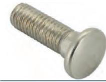
Stoßstangenschraube M8x31, verchromt. Die Schraube hat einen 8mm Vierkant zur Fixierung in der Stoßstange.
