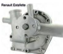
Estafette, Wasserpumpe (Achtung: Keilriemen wird extrem wenig gespannt. Fast schon locker!). Passend für Renault Estafette (Motor: 1108ccm + 1289ccm). Verbaut von Baujahr 08/1969 bis 12/1981. Or. Nr. 7701459890. Der Keilriemen wird nur sehr sehr wenig gespannt (siehe Herstellerangaben). Keine Garantie für zu stark gespannte Keilriemen (das können wir sehr gut am Lager der Wasserpumpe sehen).
