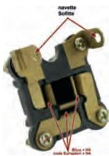
Lampenstecker, der auf die Bilux oder H4 Birne kommt. Der Stecker hat auch gleichzeitig eine Fassung für eine Soffitte. Falls ein Fahrzeug mit Standlicht nachgerüstet werden muss, kann dieser Stecker benutzt werden. Nur ein Loch in den Reflektor bohren, neues Kabel legen und schon fertig. Universal passend!
