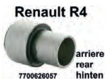
R4, Silentbuchse (per Stück) für die Lagerung der Hinterachsschwinge. Passend für Renault R4. Abmessung innen: 27mm. Außen: 45mm. Länge: 65mm + 27mm.
