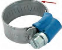
Schlauchschelle 15-24mm, speziell für Kühlerschlauch. Nostalgische Optik. Geprägtes Band mit hochgestellten Kanten. Somit wird ein Verquetschen des Schlauches vermieden. Kleines Schraubgehäuse mit 7mm Sechskantschraube (mit Schlitz). Bandbreite: 12mm. Normale, moderne Schlauchschellen zerquetschen den Schlauch. Das wird mit diesen Schellen komplett vermieden. Und sie sehen auch noch besser aus.
