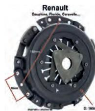
Druckplatte 160mm, im Austausch (zuzüglich 250 Euro Altteilpfand). Passend für diverse Renault mit Heckmotor (Dauphine, Floride, Caravelle, R8...). Abstand der Zentrierbolzen: 168mm (im Dreieck gemessen). Abstand der Befestigungsschrauben: 50mm. Anlaufscheibe Innendurchmesser: 26mm. Es gibt passende Mitnehmerscheiben mit 10 oder 20 Zähnen. Or. Nr. 8547585 + 8547585 99
