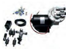
**Hydrovac Unterdruckpumpe elektrisch für Hydrovac Bremskraftverstärker universal.** Komplett mit Einbausatz. 12 Volt Anschluss, die Pumpe läuft nur an, wenn Unterdruck benötigt wird. Made in Spain.
