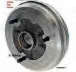
Bremsstrommel hinten (per Stück). Passend für Renault R4, ab Baujahr 09/1977. Renault R12, R15. Durchmesser: 180mm. Gesamthöhe: 68mm. Bremsfläche: 42mm. Or. Nr. 7701460327
