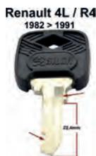
Schlüsselrohling für Zündschloss + Türschloss. Passend für Renault R4, von Baujahr 1982 bis 1991. R4 F4 + F6, bis Baujahr 1994. Für Schlosshersteller: NEIMAN. Bitte beachten Sie den Querschnitt von dem Schlüsselbart. Schaftlänge: 22,4mm. Schaftbreite: 6,9mm.
