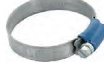
Schlauchschelle 40-56mm, speziell für Kühlerschlauch. Nostalgische Optik. Geprägtes Band mit hochgestellten Kanten. Somit wird ein Verquetschen des Schlauches vermieden. Kleines Schraubgehäuse mit 7mm Sechskantschraube (mit Schlitz). Bandbreite: 12mm. Normale, moderne Schlauchschellen zerquetschen den Schlauch. Das wird mit diesen Schellen komplett vermieden. Und sie sehen auch noch besser aus.
