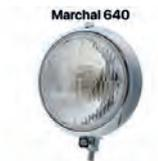
Zusatzscheinwerfer: Nebelscheinwerfer klein, Typ Marchal 640. Optisch wie Original. Universal passend. Dieser Scheinwerfer war ein originales Zubehör für den Citroën 11CV. Durchmesser: 140mm. Das Gehäuse ist aus Metall und verchromt. Ohne "E" Prüfzeichen! Passendes Leuchtmittel 12 Volt = 14415, 14418, 14417. Leuchtmittel 6 Volt = 14178
