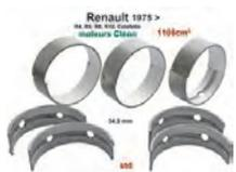
R4/R5/R8/R10/Estafette, Kurbelwellenlager (5 Lager, C = Cleon). Für Kurbelwellen mit 54,8mm Durchmesser. Standardmaß. Breite: 5x 19,47mm. Passend für Renault Motoren: 688 1, C1E700, C1E754, C1E715, C1E720, C1E750. Hubraum: 1108cc. Für Motoren ab Baujahr 1975! Bis Baujahr 1974 wurden Kurbelwellen mit 44mm Durchmesser verbaut.
