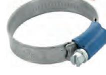
Schlauchschelle 38-50mm, speziell für Kühlerschlauch. Nostalgische Optik. Geprägtes Band mit hochgestellten Kanten. Somit wird ein Verquetschen des Schlauches vermieden. Kleines Schraubgehäuse mit 7mm Sechskantschraube (mit Schlitz). Bandbreite: 12mm. Normale, moderne Schlauchschellen zerquetschen den Schlauch. Das wird mit diesen Schellen komplett vermieden. Und sie sehen auch noch besser aus.
