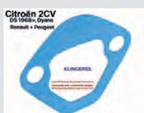
Benzinpumpendichtung für die Verschraubung am Motorblock. Passend für Citroën 2CV, Citroën DS ab 1968, Renault, Peugeot. Diese Dichtung ersetzt die Papierdichtung und ist aus "KLINGERSIL". 0,5mm dick. Klingersil ist ein extrem widerstandsfähiges Material, beständig gegen Öle, Benzin, Alkohol usw.
