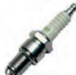
Zündkerze C62LS (BP6E, N9Y), Citroën GS/GSA, C25, Renault R18, R5, Fuego. Peugeot J7. Gewinde: M14 x 1,25 x 16mm. Schlüsselweite 21mm. Montage ohne Elektrodenverlängerung.
