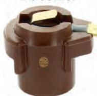
Ducellier, Verteilerfinger (kleine Ausführung). Passend für Renault R4, mit Ducellier Zündverteiler. Rotorlänge: 18,0mm. Rotorhöhe: 29mm. Wellendurchmesser: 14,0mm. Aufstecktiefe: 15,0mm. Or. Nr. 08 54 720 000, 77 01 019 885. Gutbrod Nr. 90.43.952. Passende Verteilerkappe: 82189.
