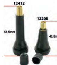
Ventil lang (Gummiventil) für Felge. Dieses lange Ventil nutzt man, wenn die Felge eine große Radkappe hat (mit Ausschnitt für das Ventil). Passend für Citroën DS, CX, HY, GS. Renault R4, R5, R6, R8, R10, Heckmotoren. Peugeot 203, 403, 404, 504, 604, 204, 304, J7. Für Ventilloch: 11,3mm. Länge: 61,5mm.
