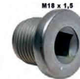
Ölablaßschraube (Motor, Peugeot Getriebe, Peugeot Hinterachse). Gewinde: M18 x 1,5mm (Innenvierkant). Passend für alle Motoren. Renault R4. Citroën HY Diesel. Or. Nr. 0311.07 + 0311.04
