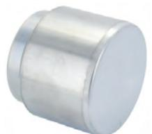
R16/A310, Kolben für Bremssattel, vorne + hinten. Bremssystem Bendix. Durchmesser: 54mm. Gesamthöhe: 47mm. Höhe der Lauffläche: 37mm. Kolbennut: 2mm. Kolben-Bund: 8mm. Passend für Renault R16 + Alpine A310 V6.
