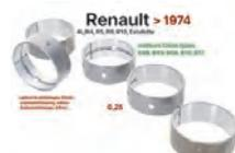
R4/R5/R8/R10/Estafette, Kurbelwellenlager (5 Lager, C = Cleon). Für Kurbelwellen mit 44mm Durchmesser. 0,25 Übermaß. Passend für Renault Motoren: 688, 689, 804, 810, 812. Für Motoren bis Baujahr 1974! Ab Baujahr 1975 wurden Kurbelwellen mit 54,8mm Durchmesser verbaut.
