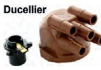
Ducellier, Verteilerkappe + Verteilerfinger (seitlicher Zündkabelabgang). Passend für Citroën DS, CX, GS, Visa, HY. Peugeot 504, 505. Renault R5, R6. Simca Talbot 1100, Matra, Bagherra, S-Rancho. Original Hersteller.
