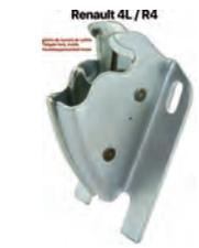
R4, Kofferraumschloss innenseitig (Heckklappenschloss). Passend für Renault R4. Je nach Ausführung, muss die Aufnahme in dem Schloss um 0,25mm aufgefeilt werden, damit die Schlossfalle einrücken kann.
