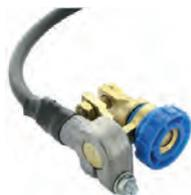
Batteriepole - Trennschalter abgewinkelt (platzsparend). Einfach die Rändelschraube lösen und der gesamte Stromkreis im Auto ist unterbrochen. Optimal für eine längere Nichtbenutzung des PKW. (Winterruhe). Einfacher geht es nicht! Die Minusklemme an der Batterie wird durch diesen trennbaren Pol ersetzt!(die Minusklemme die an der Batterie gesessen hat, wird nun einfach auf den Polanschluß des Trennschalters gesteckt). Umbauzeit ca. 1 Minute!
