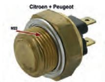
Temperaturschalter Kühlwasser CX 1985ccm (Motor M20/616, 829A5, M22) 2165ccm (M22/617) 2347 (M23/623). Auch verbaut in BX, VISA, C15, P104, 604, Talbot Samba. Renault 9+11. Gewinde M22, Temperatur 88-79°
