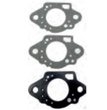
Vergaserfußdichtung (Isolierplatte zwischen Vergaser und Ansaugkrümmer). Passend für Renault R4, R5, R8, R12. Innendurchmesser: 32mm.
