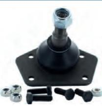
R12/R15/R17/R18 TL+TS/R20 >1980, Trag-Führungsgelenk unten. Bolzenhöhe bis Anschraubfläche: 65mm. Gewindehöhe: 23mm. Gewindemaß: M12 x 1,25. Or. 7701460886
