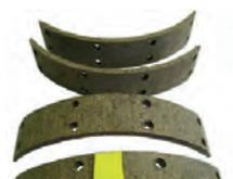
Bremsbacken Beläge, zum aufnieten. Passend für Renault R5, R6. Bremstrommeldurchmesser: 180mm. Belagbreite: 30mm. Incl. Nieten.
