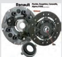
Kupplung komplett. Passend für Renault Heckmotor (Floride, Dauphine, Caravelle, A106, usw.). 10 Zähne (die Mitnehmerscheibe hat Torsionsfedern). 160mm Durchmesser. Komplett wie Original aus Neuteilen angefertigt. Eine Altteilrückgabe ist nicht erforderlich. Bitte beachten Sie die Einstellung des Kupplungsautomaten im Werkstatthandbuch!
