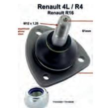
R4/R16, Trag - Führungsgelenk oben. Passend für R16 R1152 bis Fgst.Nr.02401. Bolzenhöhe bis Anschraubfläche: 61mm. Gewindehöhe: 20mm. Gewindemaß: M12 x 1,25. Or.Nr.7701453299 / 7701455299
