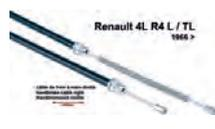
R4, Handbremsseil, rechts. Passend für Renault R4 L-TL, ab Baujahr 1966. Tülle: 1265mm. Gesamtlänge: 1495mm. Or. Nr. 7701348034
