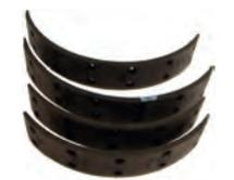
Bremsbacken Beläge, zum aufnieten. Passend für Renault R4 (R1120, 1121, 1122, 1123), ab Baujahr 7/1966. Fougonnete (R2102, 2103, 2104) ab Baujahr 3/1966. Belaglänge: 2x 240mm + 2x 180mm. Belagbreite: 35mm. Dicke: 4,6mm.
