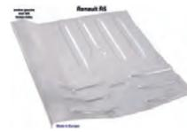
R5, Bodenblech hinten links, Renault R5, 1 Serie. Nachfertigung mit allen Sicken und Verstärkungen. Made in Europe.
