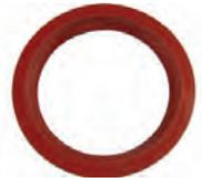
Simmerring Kurbelwelle hinten. Abmessung: 80 x 100 x 13mm. Verbesserte Ausführung aus Silicon. Passend für Renault R4 (955, 956, 1108ccm). R5, Estafette, R12, Fuego, R11, R20, R30, R25, R16, R15. Peugeot 504 V6, 604 V6, Citroën XM V6.
