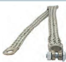
Massekabel (Batteriemasseband), mit Batteriepolklemme und Ringzunge. Länge: 450mm. Kabelquerschnitt: 22mm<sup>2</sup>. Made in der EU. Universal passend.
