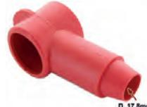
Gummikappe für den Anschluß an den Anlasser. (Schutzkappe). Diese Kappe sollte nie fehlen. Universal passend! Für max. Kabeldurchmesser: 17,8mm. Innendurchmesser 30mm. Farbe: rot
