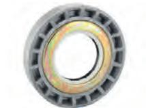
Differentiallager Einstellmutter, mit Simmerring. Passend für Renault R4, R5, R6, R12, R16 TX (5 Gang Getriebe). Aussendurchmesser: 74,8mm. Innendurchmesser: 35,0mm. Bauhöhe: 16,0mm. Or. Nr. 7700634643
