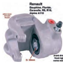
Heckmotor, Bremsattel vorne rechts. Bremssystem: Bendix. Kolbendurchmesser: 38mm. Passend für Renault R8, R10, A110, Floride, Caravelle, Dauphine.
