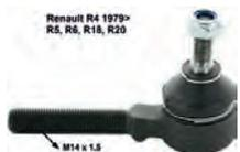
R4/R5, Spurstangenkopf. Passend für Renault R4, ab Baujahr 1979. Renault R5, R6, R18, R20. Der Spurstangenkopf ist links + rechts baugleich. Gewinde für die Spurstange: M14 x 1,5. Or. Nr. 7701460955 Made in Italy
