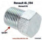
R4/R5, Motorblock Verschlußschraube. Gewinde: 1/8 NPT (sehr ähnlich zu M10x1, wird oft verwechselt). Passend für Renault R4 und R5 (Motor 688, C1E + CIC, Hubraum 956cm<sup>3</sup> + 1108cm<sup>3</sup>). Diese Schraube ist mindestens 2x im Motorblock montiert. Zum kompletten entleeren der Kühlfüssigkeit aus dem Motor, kann diese Schraube raus geschraubt werden! Or. Nr. 7703075009
