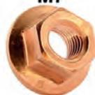
M7, Kupfermutter für Auspuffanlagen! Verkupfert! An Auspuffanlage und Auspuffkrümmer sollte man immer Kupfermutter verwenden, da sie nicht anrosten können bzw. sich durch die Hitze festbrennen können.
