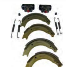
Bremsbacken hinten (Bremsensatz, mit 2x Radbremszylinder + Bremsbacken). Bremssystem: Bendix. Passend für Renault R4 + R5. Kolbendurchmesser: 20,6mm. Bremstrommeldurchmesser: 160mm. Belagbreite: 26mm.
