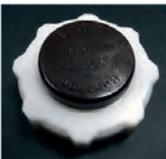
Kühlerdeckel für den Ausgleichsbehälter. Passend für Renault R4 (0,8 + 1,1L. R1123, R1128, R112C). Renault R5. Farbkennzeichnung: schwarz (1,0 Bar).
