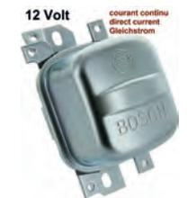
Lichtmaschinen Laderegler, für Gleichstrom (mechanisch geregelt). 12 Volt. 3 Anschlüsse (D+/61, DF, B+). Masse über Gehäuse. Ersatz Ducellier. Maximal 360 Watt! 30 Ampere. Abstand Befestigungslöcher: 125mm. Hersteller: Bosch
