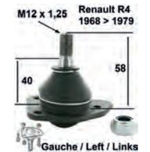
R4/R5/R6, Trag - Führungsgelenk unten links, für Renault R4 + R5, R6. Verbaut von Baujahr 1968 bis 1979. Bolzenhöhe bis Anschraubfläche: 58mm. Gewindehöhe: 19mm. Gewindemaß: M12 x 1,25. Or.Nr.: 7701450635
