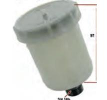
Bremsflüssigkeitsbehälter mit Verschlussdeckel, für das Bremssystem DOT. Passend für Citroën 2CV bis Baujahr 1963. Peugeot 202, 203, 403, 404. Renault Heckmotor, R4. Durchmesser: 57mm. Behälterhöhe mit Verschlussdeckel: 97mm. Gewindeanschluß auf dem Hauptbremszylinder: 3/4 16h. Made in Spain.
