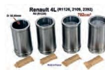
R4/R5, Kolben + Zylinder (4 Stück). Passend für Renault R4 (R1126, 2109, 2392). R5 (R1220). Motor: 839. Hubraum: 782cm<sup>3</sup>. Bohrung: 55,80mm. Kolbenbolzen: 16 x 46mm. Kolbenringe: 1,75 + 2,0 + 3,5mm.
