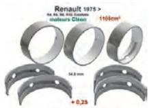
R4/R5/R8/R10/Estafette, Kurbelwellenlager (5 Lager, C = Cleon). Für Kurbelwellen mit 54,8mm Durchmesser. 0,25 Übermaß. Breite: 5x 19,47mm. Passend für Renault Motoren: 688 1, C1E700, C1E754, C1E715, C1E720, C1E750. Hubraum: 1108cc. Für Motoren ab Baujahr 1975! Bis Baujahr 1974 wurden Kurbelwellen mit 44mm Durchmesser verbaut.
