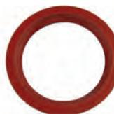
Simmerring Kurbelwelle hinten. Abmessung: 80 x 100 x 13mm. Verbesserte Ausführung aus Silicon. Passend für Renault R4 (955, 956, 1108ccm). R5, Estafette, R12, Fuego, R11, R20, R30, R25, R16, R15. Peugeot 504 V6, 604 V6, Citroën XM V6.
