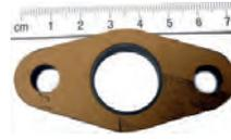
Vergaserfußdichtung (Isolierplatte zwischen Vergaser und Ansaugkrümmer). Passend für Renault R12, R15, R16. Durchmesser: 20,5mm. Befestigungslöcher: 50mm.
