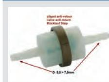
Benzinfilter universal, mit Rückschlagventil (Membrane)! Durch das Ventil wird verhindert, dass das Benzin wieder zurückläuft. Dadurch ist gerade nach längerer Standzeit ein besseres starten des Motors möglich, und die Membrane der Benzinpumpe trocknet nicht so schnell aus. Unverzichtbar bei klassischen Autos, die nur wenig bewegt werden. (Sommer-Sonntag-Auto). Für Benzinschläuche von 5,5 - 7,5mm Innendurchmesser. Durchmesser 42mm. Baulänge gesamt 100mm.
