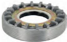
Differentiallager Einstellmutter, mit Simmerring. Passend für Renault R4, R5, R6, R12, R16 ( 4 Gang Getriebe). Aussendurchmesser: 74,0mm. Innendurchmesser: 35,5mm. Bauhöhe: 18,0mm. Or. Nr. 0556231900 + 7700554257
