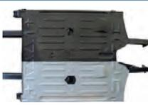
R4, Bodenblech links (mit allen Sicken). Komplett von vorne bis hinten. Passend für Renault R4. Made in Europe.
