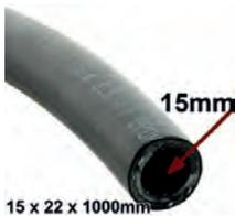
Kühlerschlauch universal. Innendurchmesser: 15,0mm. Aussendurchmesser: 22,0mm. Länge: 1000mm.
