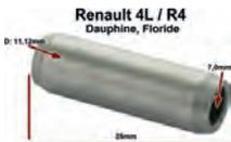
Ventilführung Einlass + Auslass. Passend für Renault mit Heckmotor (Dauphine, Floride). Renault R4. Innendurchmesser: 7,00mm. Aussendurchmesser: 11,12mm. Länge: 35mm.
