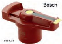
**Bosch**, Verteilerfinger. Passend für Peugeot 504 V6. Peugeot 604. Renault R30, ab Baujahr 07/1979. Or. Nr. 593721. Rotorlänge über alles = 67 mm. Rotorhöhe über alles = 35 mm. Wellendurchmesser = 14 mm. Aufstecktiefe = 19 mm.
