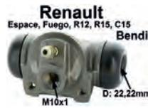
Radbremszylinder hinten (System Bendix), links oder rechts passend. Für Citroën C15. Renault Espace I, Fuego, R12, R18. Kolbendurchmesser: 22,2mm. Ankerplattenbohrung: 36mm. Bremsleitungsanschluss: 10x1 mm. Länge über alles: 70mm.
