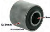
4CV/Fregate, Silentbuchse für den Hebel-Stoßdämpfer, in der Verbindungsstange (Koppelstange). Passend für Renault 4CV + Renault Fregate. Abmessung: 9 x 21 x 21 x 17mm. Or. Nr. 8 511 922
