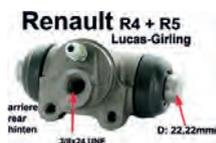
R4/R5, Radbremszylinder hinten. Links + rechts passend. Bremssystem: Lucas-Girling. Passend für Renault R4 (1108ccm, R1128, S128, R2370, 210B). Renault R5, von 1/1972 bis 12/1985. Kolbendurchmesser: 22,2mm. Bremsleitungsanschluß: 3/8 x 24 UNF. Länge: 60mm. Ankerplattenbohrung: 32mm. Or. Nr. 7701024260
