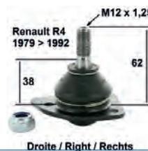
R4/R5, Trag - Führungsgelenk unten rechts. Passend für Renault R4 + R5. Verbaut von Baujahr 1979 bis 1992. Bolzenhöhe bis Anschraubfläche: 62mm. Gewindehöhe: 19mm. Gewindemaß: M12 x 1,25. Or. Nr. 7701463687
