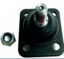
R12/R15/R17/R18 TL+TS/R20 bis 1989, Trag Führungsgelenk oben. Bolzenhöhe bis Anschraubfläche: 65mm. Gewindehöhe: 25mm. Gewindemaß: M12 x 1,25. Or. 7701460885
