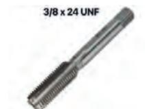
Gewindebohrer UNF 3/8 x 24 (Einschneid Gewindebohrer). Das Gewinde findet sich häufig an Bremsteilen wie Radbremszylindern, Hauptbremszylindern, Bremsschläuchen.
