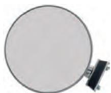
4CV, Außenspiegel rund. Für die Montage an der Tür. Passend für Renault 4CV.
