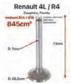
Einlassventil, passend für Renault R4, Dauphine, Floride. Motoren: B1A + B1B, 845ccm. Durchmesser: 28,2mm. Bauhöhe: 73mm. Ventilschaft: 7,0mm. Passender Ventilkeil = 81064
