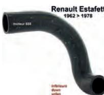
Estafette, Kühlerschlauch unten. Passend für Renault Estafette, von Baujahr 06/1962 bis 10/1978, Motorcode: 688. Durchmesser: 35mm.
