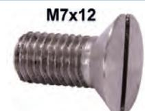
M7x12. Senkkopfschraube 7mm, mit flachem Schraubenkopf! Material: Edelstahl. Der Schraubenkopf hat ca. 12mm Durchmesser! Z.B. passend für die Türschlosseile (Citroën 11CV).
