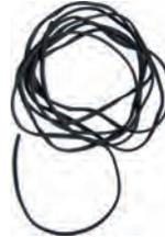
R4, Zierleiste schwarz (aus Kunststoff), für die Regenrinne am Dach. Passend für Renault R4 Limousine. Die Zierleiste wird nur aufgeklemt. Länge: 550cm.
