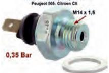
Öldruckschalter. Gewinde: M14 x 1,5. Schaltdruck: 0,2 bis 0,45 Bar. Passend für Renault R4 (ab Baujahr 1967), R5, R16. Citroën CX1 2000-2200, CX2 20RE. Peugeot 505 2.0 + 2.2.
