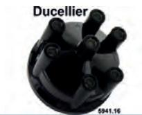
Ducellier, Verteilerkappe V6. Passend für Peugeot 504 V6 (Cabrio + Coupe), 604 V6. Renault R30. Or. Nr. 5941.16
