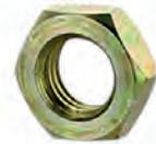
M9, Mutter M9x1,25. Niedrige (flache) Ausführung. Höhe: 5mm. Z.B. für die Ventildeckelverschraubung bei dem 11CV mit D-Motor. Or. No. 2372-S
