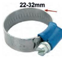
Schlauchschnelle 22-32mm, speziell für Kühlerschlauch. Nostalgische Optik. Geprägtes Band mit hochgestellten Kanten. Somit wird ein Verquetschen des Schlauches vermieden. Kleines Schraubgehäuse mit 7mm Sechskantschraube (mit Schlitz). Bandbreite: 12mm. Normale, moderne Schlauchschnellen zerquetschen den Schlauch. Das wird mit diesen Schnellen komplett vermieden. Und sie sehen auch noch besser aus.
