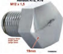
Radkappen Schraube. Passend für Renault R4 (1123, 1125, 2108). Renault R12 + R16. Gewinde: M12 x 1,5. Länge: 18mm. Werkzeug: 19mm. Or. Nr. 7700562810
