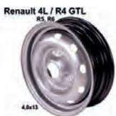
Felge 4,0x13 (Nachbau). Passend für Renault R4 GTL. Renault R5, R6. Lochkreis: 3x130mm. Einpresstiefe: 28mm. Mittenloch: 60mm. Or. Nr. 7701349506
