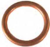
Ölablaßschraubendichtung 18 x 24 x 2mm (für M18 Gewinde). Passend für Peugeot 203, 403, 404, 504, 505, J7 (alle Motoren). Renault R4. Citroën HY. Ölkühlerverschraubung 2CV mit 16PS!
