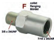
R4/R16/R12, Bremskraftregler: Bremsleitungsadapter von 3/8x24 UNF auf 7/16x20UNF, für "F" Bördelung. Achtung: Es gibt Bremskraftregler mit 3x 3/8 + 1x 7/16 Bremsleitungsanschlüsse. Unser Bremskraftregler 84076 hat nur 4x 3/8x24 Anschlüsse!
