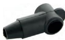
Gummikappe für den Anschluß an der Lichtmaschine. (Schutzkappe). Diese Kappe sollte nie fehlen. Universal passend! Für max. Kabeldurchmesser: 7,62mm. Innendurchmesser 12,7mm.
