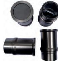
R8/Florde S/Caravelle, Kolben + Zylinder (4 Stück). Passend für Renault R8, Florde + Caravelle. Baujahr 1962 bis 1967. Motor: Motor 689 01 / 02. Hubraum: 956cc. Bohrung: 65,0mm. Kolbenbolzen: 18 x 57mm. Kolbenringe: 2,0 + 2,0 + 3,5mm. Aussendurchmesser unten: 75,48mm. Aussendurchmesser oben: 84,75mm. Höhe gesamt: 135,0mm.
