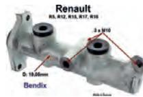
R5/R12/R15/R17/R18, Hauptbremszylinder. Bremssystem: Bendix. Kolbendurchmesser: 19,05mm. Passend für Renault R5, R12, R15, R17, R18. Bremsleitungsanschluß: 3 x M10. Made in Europe.
