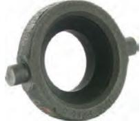
Ausrücklager 2CV alt/AMI6, alte Version (Graphit-Lager), für Benutzung der originalen Kupplung mit 3 Hebeln. Der Graphitring hat 52mm Aussendurchmesser, 32mm Innendurchmesser. Gesamt Bauhöhe 20mm. Auch passend für Renault R4 bis 1970, Dauphine, 4CV. Or.Nr.: AZ 314.01
