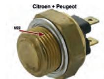
Temperaturschalter Kühlwasser CX 1985ccm (Motor M20/616, 829A5, M22) 2165ccm (M22/617) 2347 (M23/623). Auch verbaut in BX, VISA, C15, P104, 604, Talbot Samba. Renault 9+11. Gewinde M22, Temperatur 88-79°
