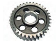
R4, Stirnrad (Stahl). Passend für Renault R4 (frühe Baujahre). Motor: 680-02 bis Motornummer 363854. Motor: 800-01 bis Motornummer 207836. 34 Zähne. Innendurchmesser: 28mm. Außendurchmesser: 99,9mm.
