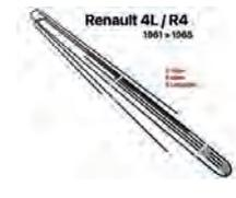
R4, Bremsleitungssatz. Passend für Renault R4, von Baujahr 1961 bis 1965. 6 Leitungen. "E" Bördel" beidseitig (Trichter). (R1123 von Fahrgestellnummer 554745 bis 733630, R1120 von 863466 - 1037654). Länge ca.: 46cm, 60cm, 60cm, 106cm, 158cm, 273cm. Alle Leitungen 3/8 UNF Gewinde. Schlüsselweite 10.
