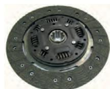
Mitnehmerscheibe, passend für Renault Alpine A310 + Renault R30. Durchmesser: 235mm (235 x 162 x 3,2mm). Anzahl Zähne: 10. Nabenprofil: 24,5x29
