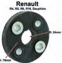
Hardyscheibe für die Lenksäule. Passend für Renault R4, R5, R8, R16, R18, Dauphine. Außendurchmesser: 76mm. Innendurchmesser: 24mm. Lochkreis: ca. 50mm.
