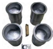
A110/R12 Gordini/R17TS, Kolben + Zylinder (4 Stück). Passend für Renault Alpine A110, R12 Gordini, R17TS (R1313, R1323). Motor: 807 12/20. Hubraum: 1564ccm. Bohrung: 77mm. Kolbenbolzen: 21 x 65mm. Kolbenringe: 1,75 + 2 + 4,0mm. Aussendurchmesser unten: 82,50mm. Aussendurchmesser oben: 96,0mm. Höhe gesamt: 143,50mm.
