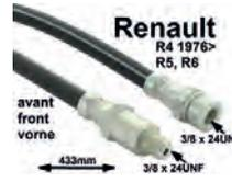
R4/R5/R6, Bremsschlauch vorne. Passend für Renault R4, ab Baujahr 1976 (Scheibenbremse). Renault R5, R6. Länge: 433mm. Gewinde: 1x Außengewinde 3/8 x 24UNF. 1x Innengewinde 3/8 x 24UNF. Or. Nr. 7700545267. Made in Europe.
