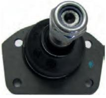
R12/R15/R17/R18, Traggelenk unten. Passend für Renault R12, R15, R17, R18. Bolzenhöhe bis Anschraubfläche: 62mm. Gewindehöhe: 23mm. Gewindemaß: M12 x 1,25.
