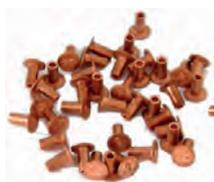
Niete für das Bremsbacken aufnieten. Universal passend z.B. für 11CV / 15CV / HY / 203 / 403 / Fregate usw.. Für einen Citroën 11CV/15CV benötigen Sie 92 Stück. Abmessung: 4mm Durchmesser. Schaftlänge 8mm.
