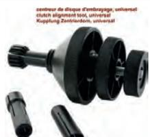
Kupplung Zentrierdorn universal (einstellbar). Einsetzbar für Schwungscheiben mit und ohne Pilotlager. Zentrierdorn passt von 14 > 28mm und der Konus für Druckplatte von 35 > 67mm (also nahezu alle klassischen Franzosen)
