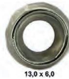
Rosette vernickelt. Für 5mm Schraube. Aussendurchmesser: 13mm. Höhe: 3,0mm. Diese Rosetten wurden verwendet für Armaturenblett, Türverkleidungen. Passend für Citroën 2CV, DS, HY und in vielen Peugeot + Renault.
