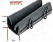
R4, Schiebefensterführung, passend für Renault R4. Per Meter! Die Fensterführung passt in den Metallrahmen der Türen (bitte nachmessen, es gibt verschiedene Ausführungen). Breite ca: 15mm. Höhe ca: 14mm. Die Fensterführung ist auf der Innenseite beflockt (damit sich das Fenster schieben lässt). Das Gummi ist relativ weich und lässt sich gut montieren.
