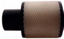
Entlüftungsfiler für Motorentlüftung. Passend für Renault R16, R15, R17. Citroën CX 2400, usw. Abmessung: Durchmesser oben: 30mm. Höhe Filter: 28mm. Gesamthöhe: 46mm. Anschlussdurchmesser: 18mm. Or. Nr. 7700550429 + 96072385
