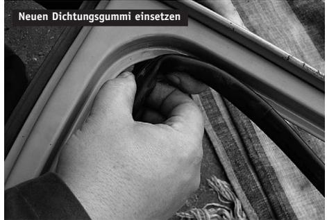
Neuen Dichtungsgummi einsetzen
