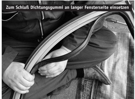
Zum Schluß Dichtungsgummi an langer Fensterseite einsetzen
