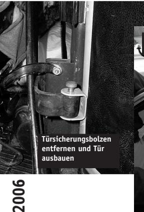
Türsicherungsbolzen entfernen und Tür ausbauen
