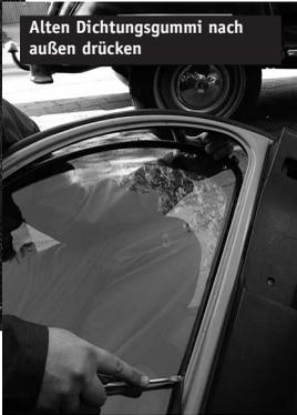
Alten Dichtungsgummi nach außen drücken
