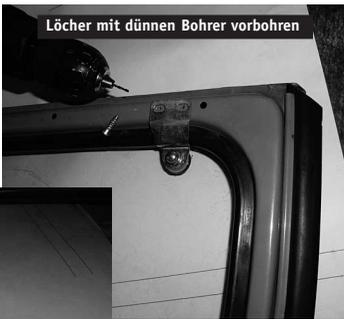
Löcher mit dünnen Bohrer vorbohren
