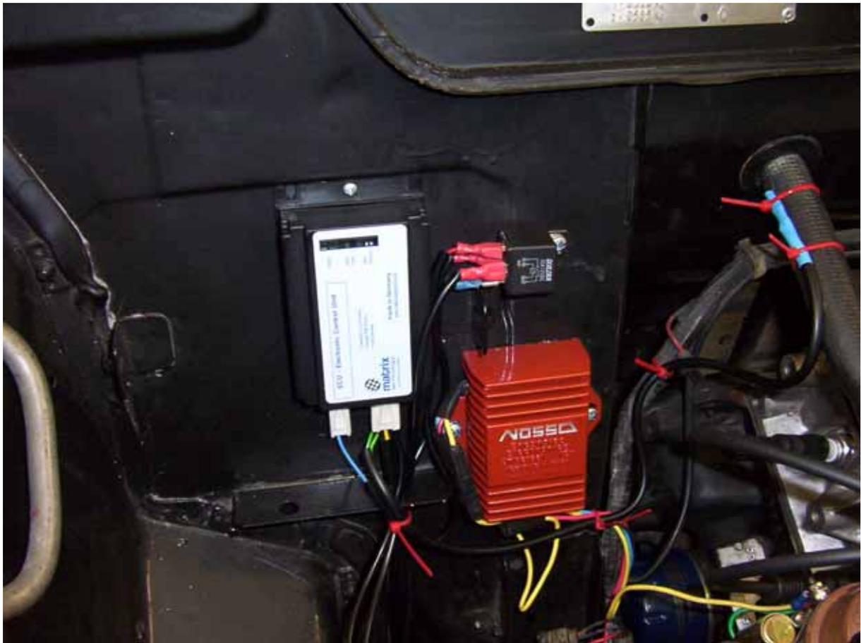
Das Verlegen sämtlicher Kabel, ist mit großer Sorgfalt zu tätigen. Hier ist darauf zu achten das keinerlei Scheuerstellen oder Zugbelastungen auf die Kabel einwirken können. Ein Mindestabstand von ca. 5 cm ist zu Hochspannung führenden Teilen ein zu halten.
