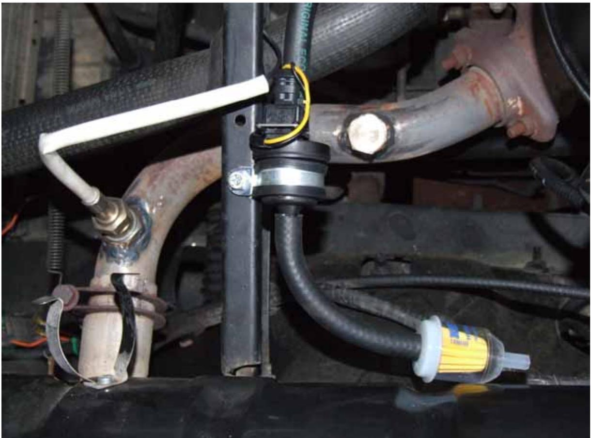
Auf dem Bild ist noch ein zweiter Stutzen für eine Lambdasonde zu erkennen. Dieses war für den Prüfstand in Hannover beim Tüv erforderlich, wird aber für die Anlage nicht benötigt.
