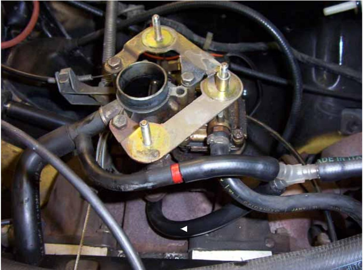
Am Ansaugkrümmer unterhalb des Vergasers befindet sich ein Schlauchanschluss. Dieser ist original mit der Motorentlüftung belegt. Bitte entfernen Sie diesen Schlauch von dem Stutzen vorsichtig. In diesem originalen Schlauch befindet sich ein **Drosselstück ( rotes Kunststoffteil auf dem Bild )**, dieses muss wie auf dem Bild zu erkennen ist montiert werden.
