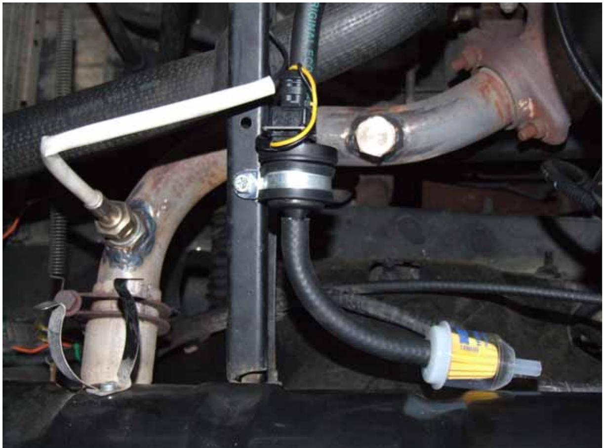
Den Ansaugfilter bitte so präparieren das ein größt möglicher Querschnitt der Schlauchanschlüsse entsteht. ( die 6mm Stücke abschneiden ).
