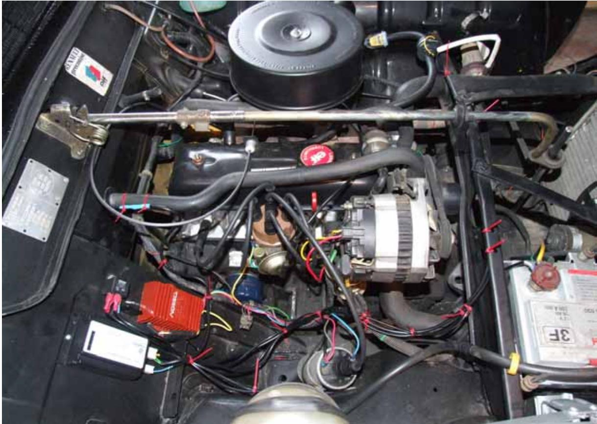
Das Kabel welches zum Regelventil führt wird in dem Schaltgestängeträger verlegt.
