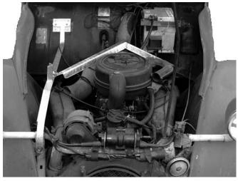
Votre support de roue de secours sous capot moteur est en Inox. Il n'est pas nécessaire de le peindre ou de lui donner de traitement anticorrosion. Le montage se fait tel que les concessionnaires le faisait à l'époque.
