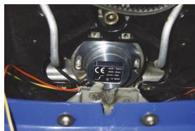
Passez les fils à travers le boîtier du ventilateur vers la bobine d'allumage! Fixez bien les fils de sorte qu'ils ne puissent pas être en contact avec le ventilateur plus tard (comme les fils d'origine du condensateur). Le système a un fil rouge, un noir et un jaune. Retirez le fils moins de la bobine. Ce fil était relié au condensateur et n'est pas nécessaire de le garder. Sertissez les connecteurs au bout des fils de l'allumeur.
