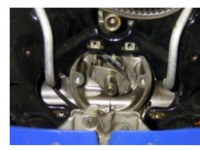
Dahinter ist nun endlich die Verteilerbox. Ziehen Sie bitte **das Kabel am Kondensator ab**, der unten angebracht ist. Das Kabel vom Kondensator zur Zündspule wird nicht mehr benötigt und kann **stillgelegt** werden.
