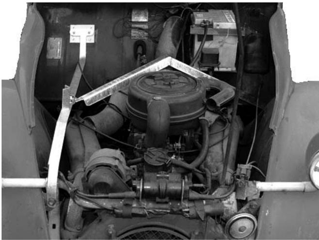
Votre support de roue de secours sous capot moteur est en Inox. Il n'est pas nécessaire de le peindre ou de lui donner de traitement anticorrosion. Le montage se fait tel que les concessionnaires le faisait à l'époque.
