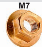
M7, Kupfermutter für Auspuffanlagen! Verkupfert! An Auspuffanlage und Auspuffkrümmer sollte man immer Kupfermutter verwenden, da sie nicht anrosten können bzw. sich durch die Hitze festbrennen können.
