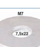
M7, Unterlegscheibe groß, 7,5x22mm, 2mm dick! (Karoseriescheibe)
