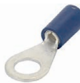
Ringzunge blau, 6mm Anschraubzunge. Blau = Kabelquerschnitt: 2,3 bis 5,0mm.
