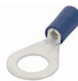
Ringzunge blau, 8mm Anschraubzunge. Blau = Kabelquerschnitt: 2,3 bis 5,0mm.
