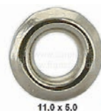
oeillet pour vis de 4mm, rondelle décorative pour tableau de bord, garniture intérieur, sellerie. Diamètre ext. 11mm, hauteur 2,4mm, pour toutes anciennes Citroën 2CV, DS, HY ou Peugeot et Renault, fabrication nickelée avec un rebord ver l'intérieur pour une très grande résistance.
