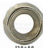
oeillet pour vis de 5mm, rondelle décorative pour tableau de bord, garniture intérieur, sellerie. Diamètre ext. 13mm, hauteur 3,0mm, pour toutes anciennes Citroën 2CV, DS, HY ou Peugeot et Renault, fabrication nickelée avec un rebord ver l'intérieur pour une très grande résistance.
