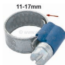
collier de serrage pour durite 11-17mm. Collier rétro avec les bords remontés pour éviter de blesser le caoutchouc. Petite vis de serrage 7mm. Largeur : 9mm. Protection meilleure que les colliers modernes et style rétro bien en accord avec les véhicules de collection anciens.
