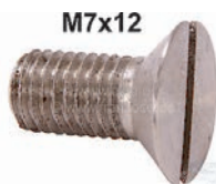
M7x12 vis à tête fraisée M7x12, vis Inox à tête polie d'un très bel aspect! diam. de la tête env. 12mm, pour gâches de serrure de Traction Citroën par ex.
