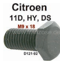
vis de volant moteur, Traction 11D, HY et DS jusque 06.62, dimensions: M9x18, n° d'origine D121-92
