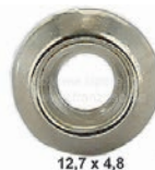
oeillet pour vis de 4mm, rondelle décorative pour tableau de bord, garniture intérieur, sellerie. Diamètre ext. 12,7mm, hauteur 2,5mm, pour toutes anciennes Citroën 2CV, DS, HY ou Peugeot et Renault, fabrication nickelée avec un rebord ver l'intérieur pour une très grande résistance.
