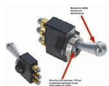
commutateur inverseur à bascule, levier en métal poli, interrupteur à 3 positions, 3 raccords électriques, 5 ampères max. diamètre perçage: 12,5mm. Cet interrupteur vous permet de commander deux fonctions distinctes, ou une seule si vous ne branchez que 2 fils.
